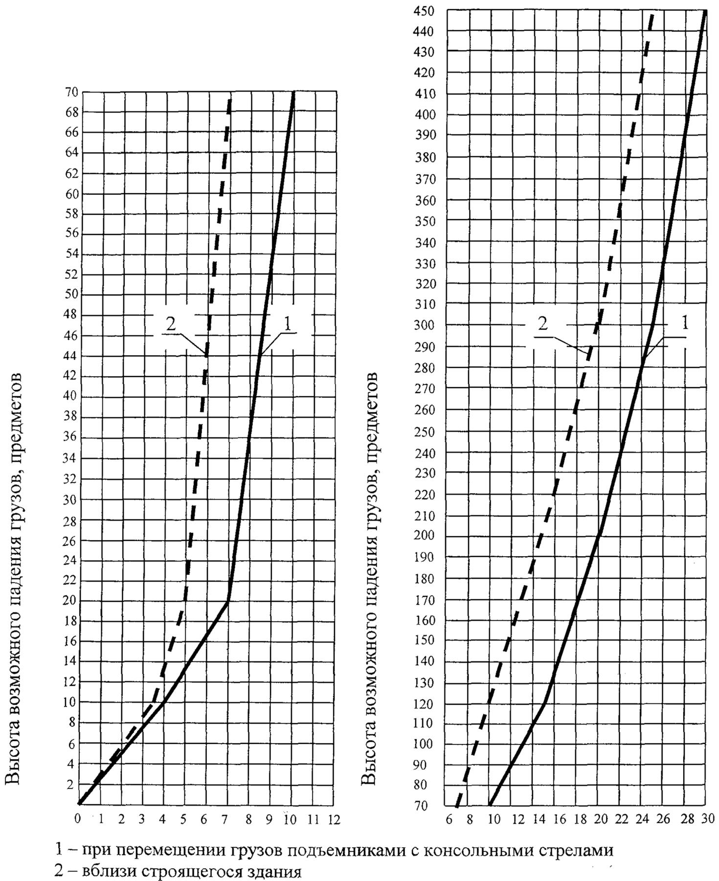
**Рисунок 5 – График определения минимального расстояния отлета груза при его падении**
