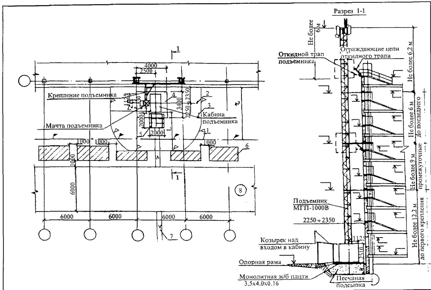
**Рисунок 1 – Установка грузопассажирского подъемника МГП-1000В**
