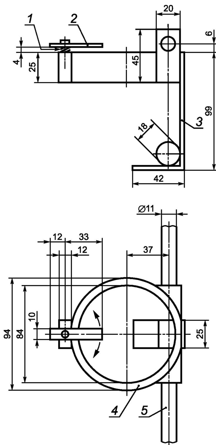
1 — спиральная пружина; 2 — фиксирующий зажим (2-мм сталь); 3 — поддержка тигля (2-мм сталь); 4 — кольцо; 5 — вал
