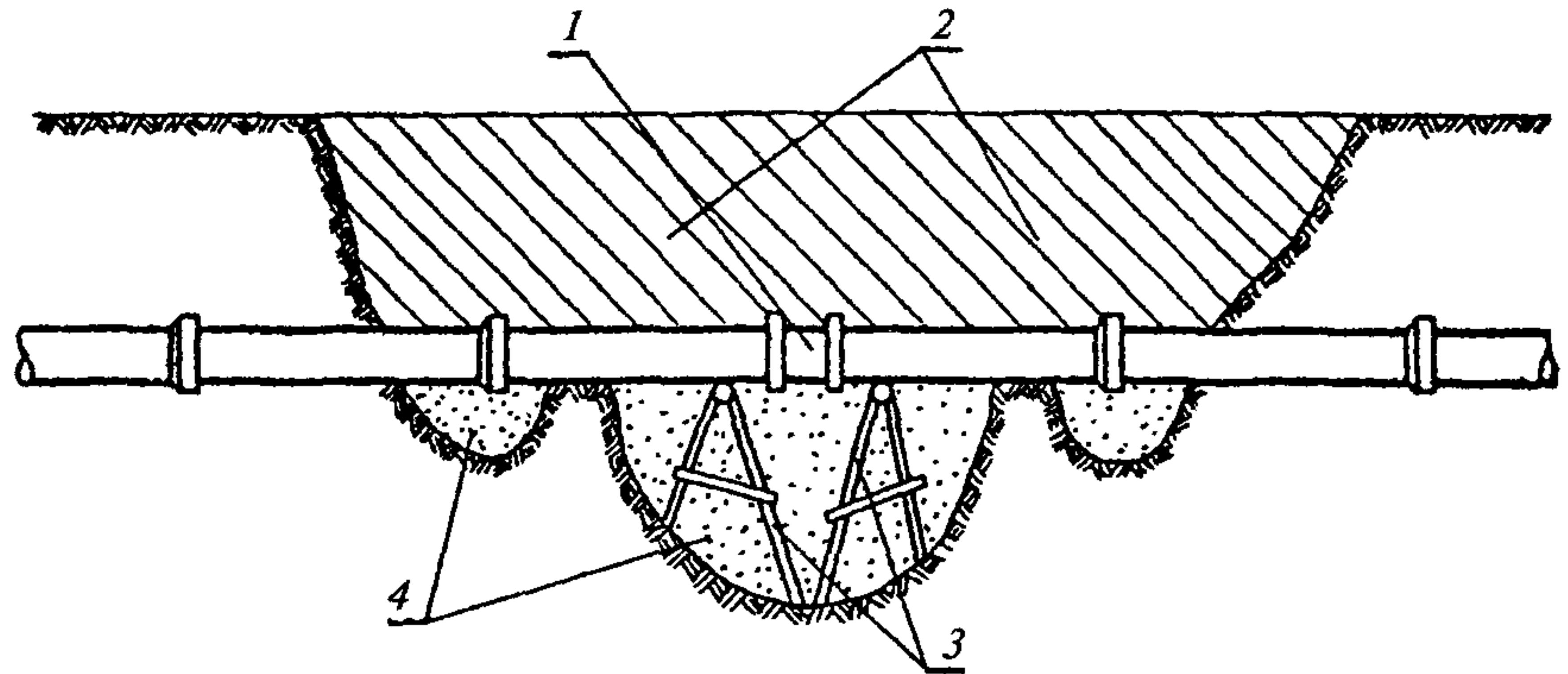
Рис. 7. Схема замены поврежденных труб с помощью ремонтной муфты
