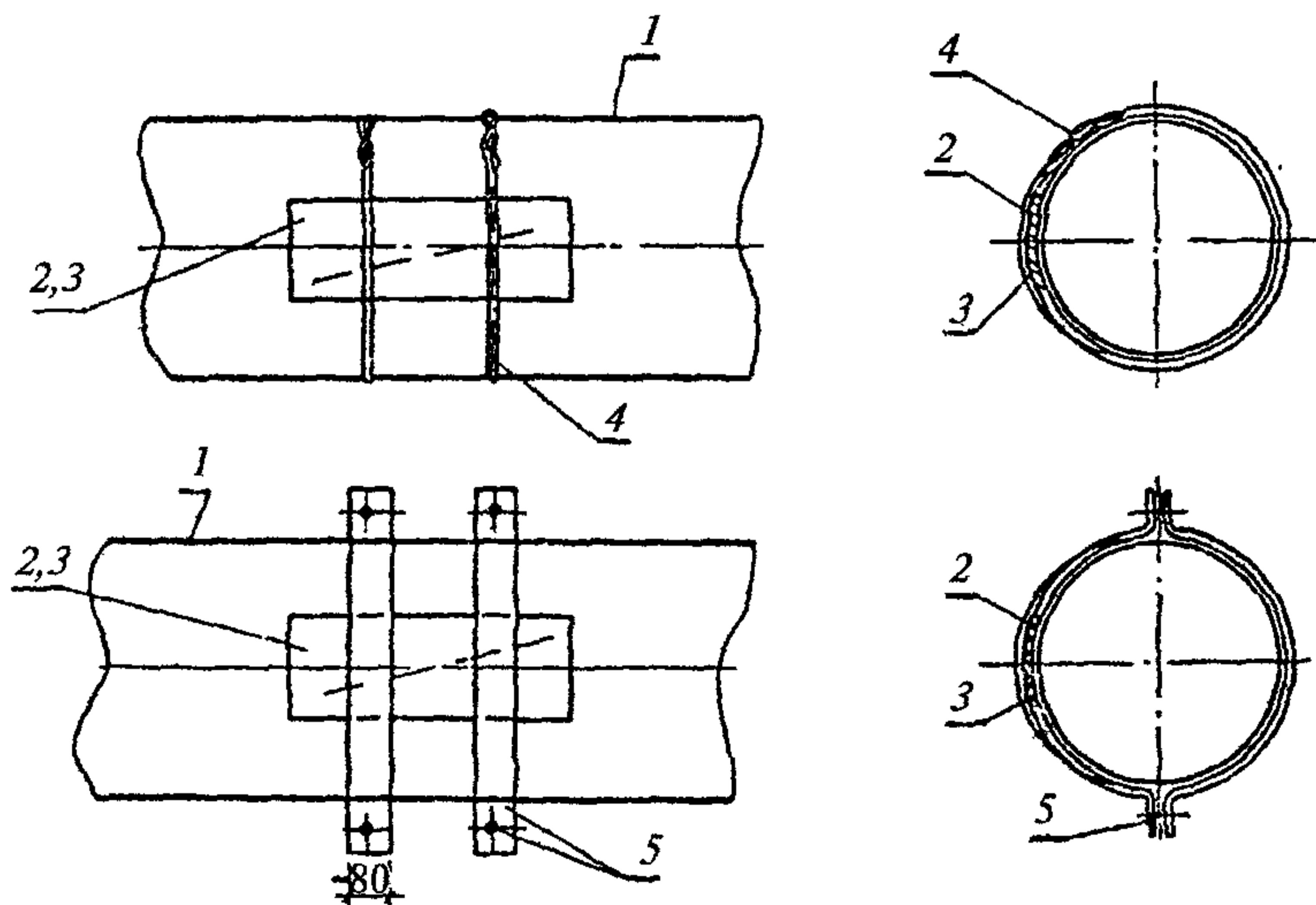
Рис. 4. Схема заделки продольных трещин на чугунных и стальных трубопроводах
