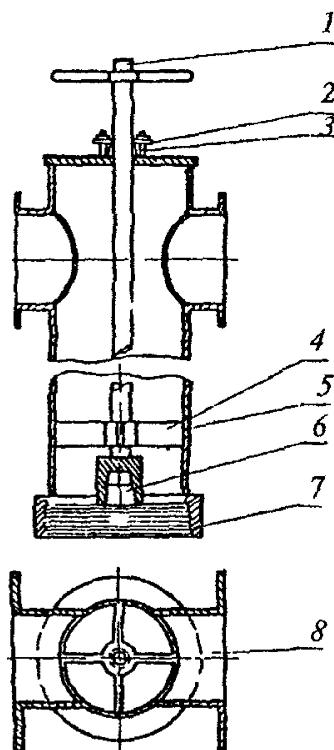
Рис. 3. Специальный упрощенный стендер
