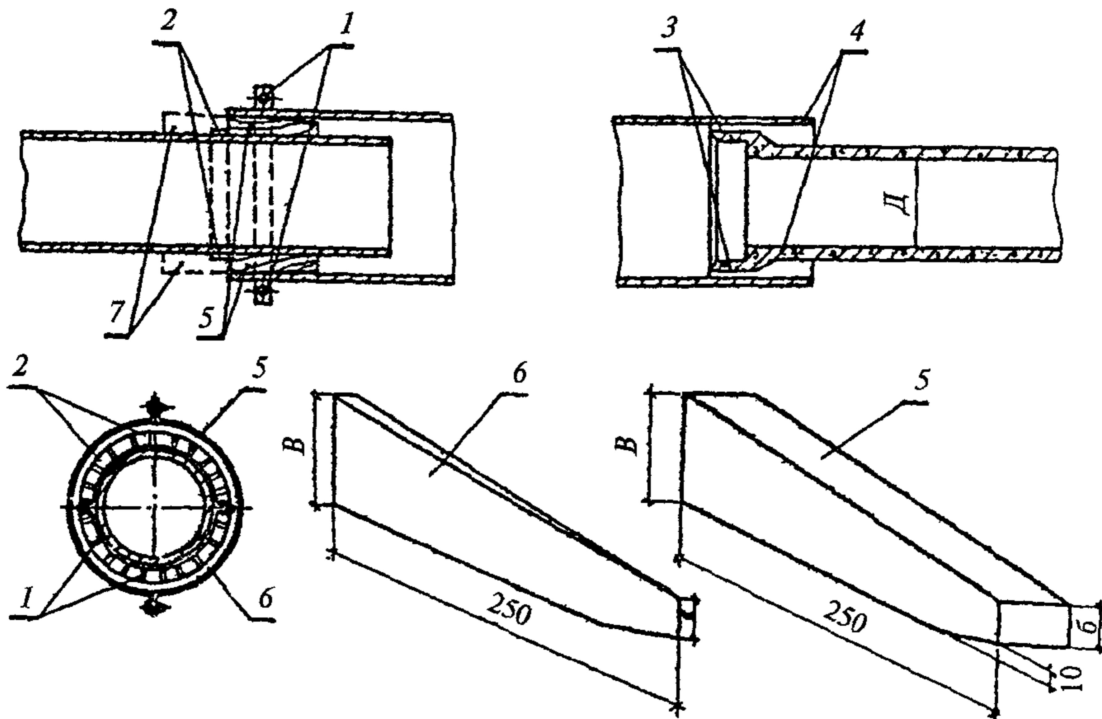
Рис. 10. Схема соединения труб разных диаметров с помощью деревянных клиньев и заделка труб серопесчанным сплавом
