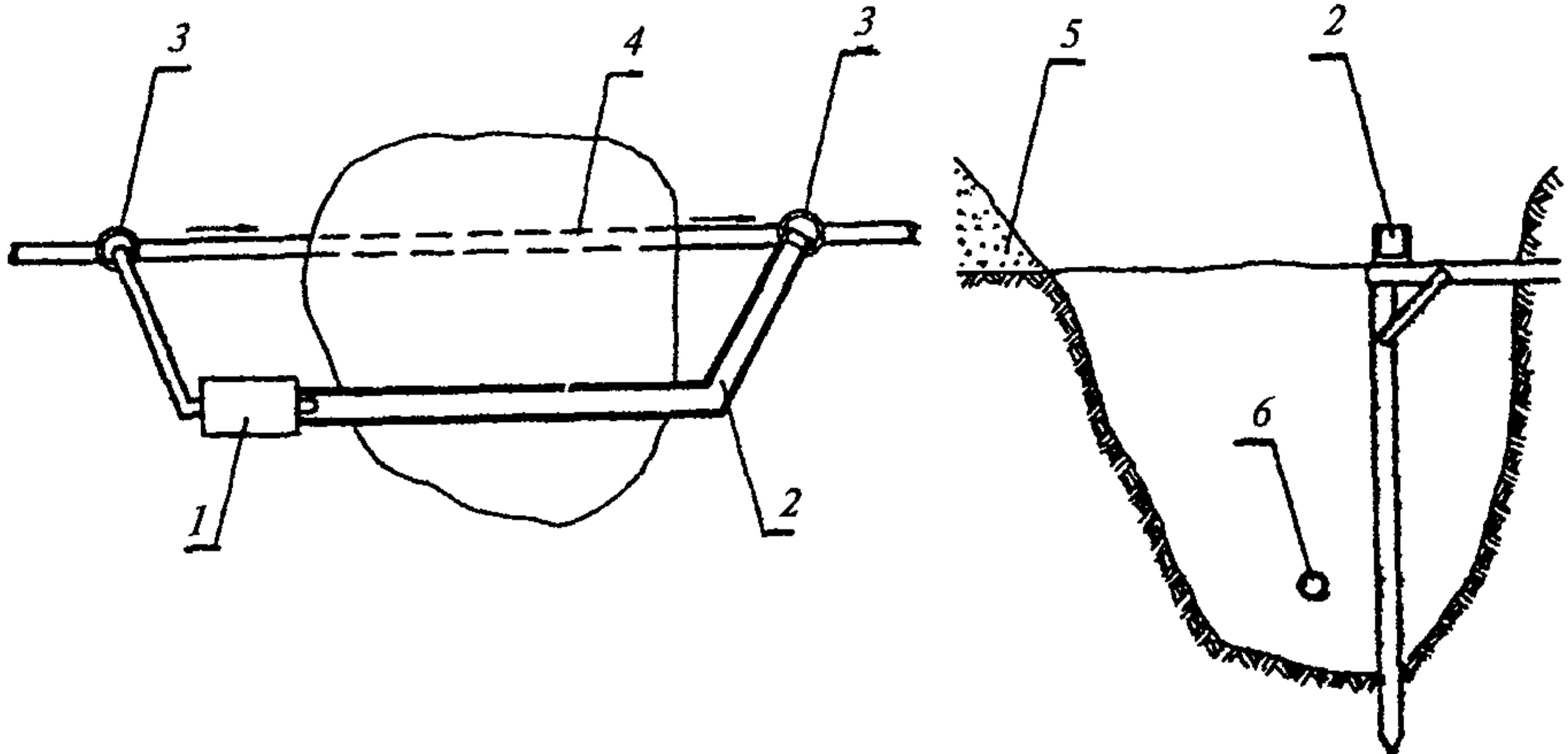
Рис. 15. Схема откачки сточных вод в обводной желоб
