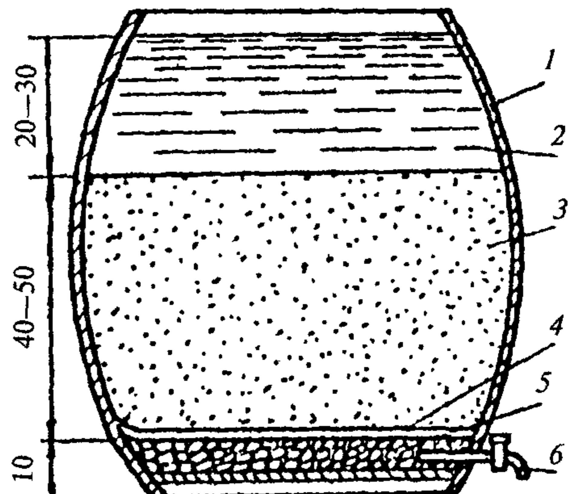
Рис. 19. Схема устройства простейшего фильтра
