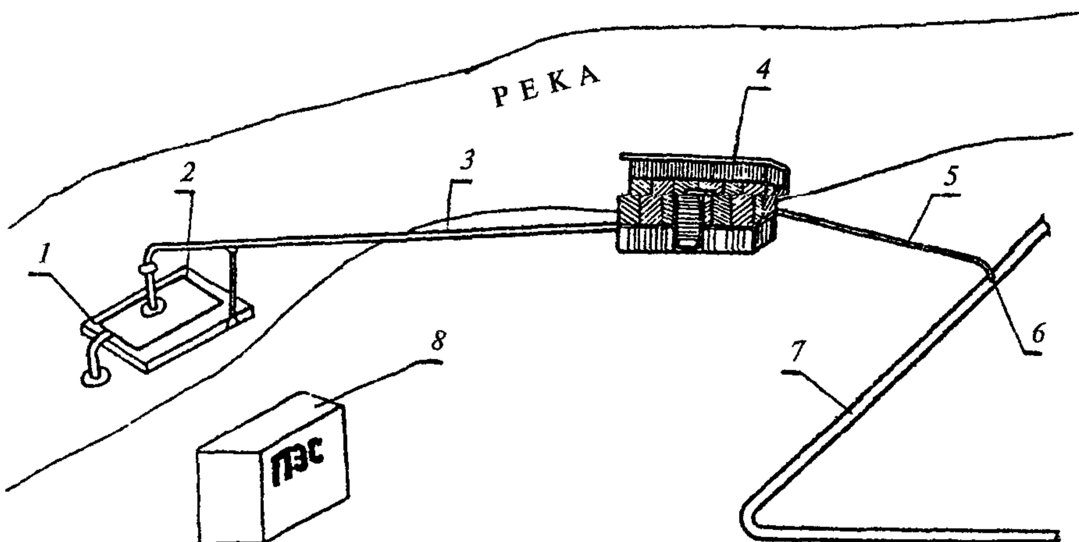
Рис. 16. Схема простейшего водозабора
