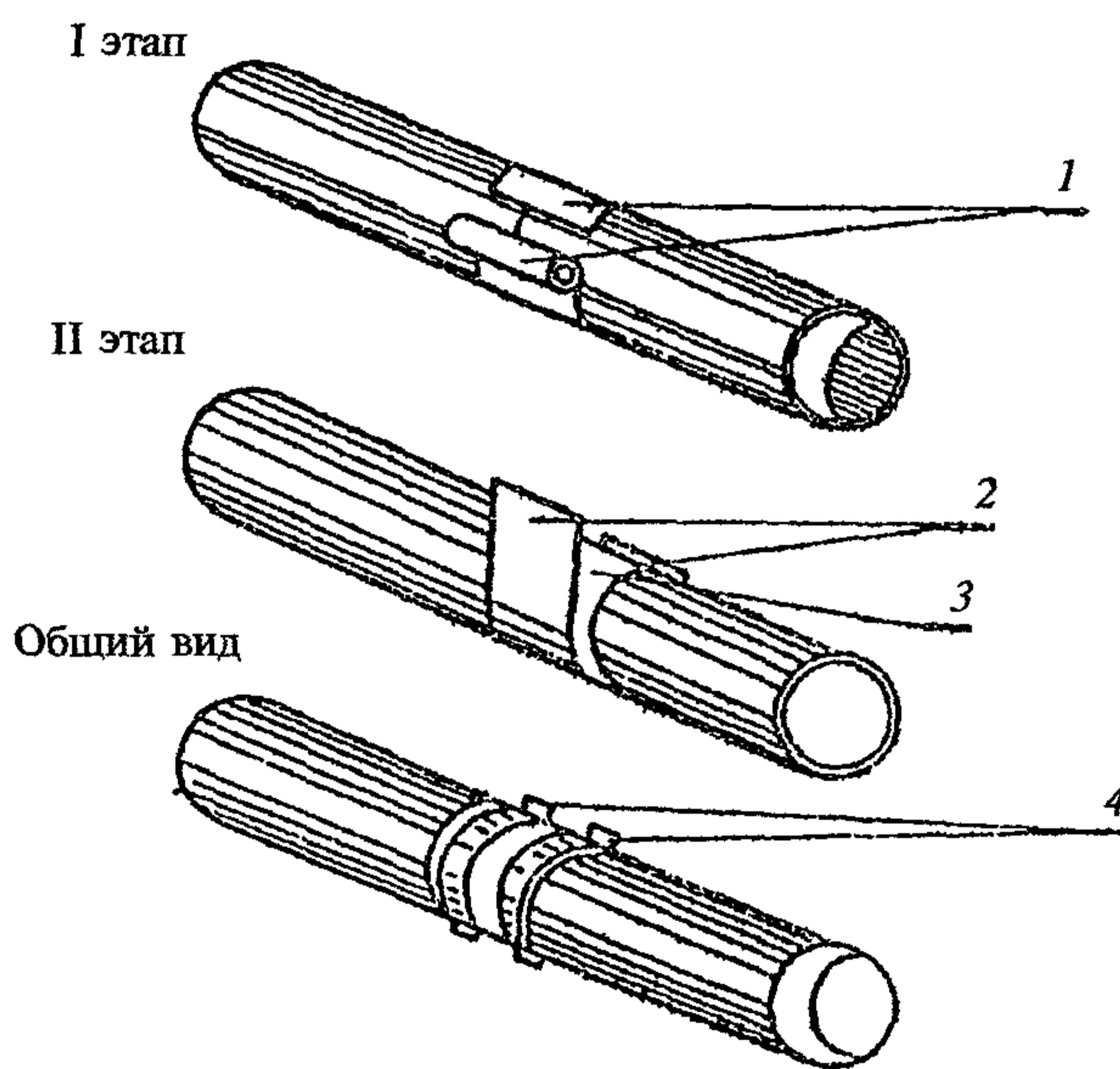
Рис. 6. Схема заделки поперечных трещин брезентом или только в 6—8 слоев с покрытием поверху кровельным железом с постановкой хомутов
