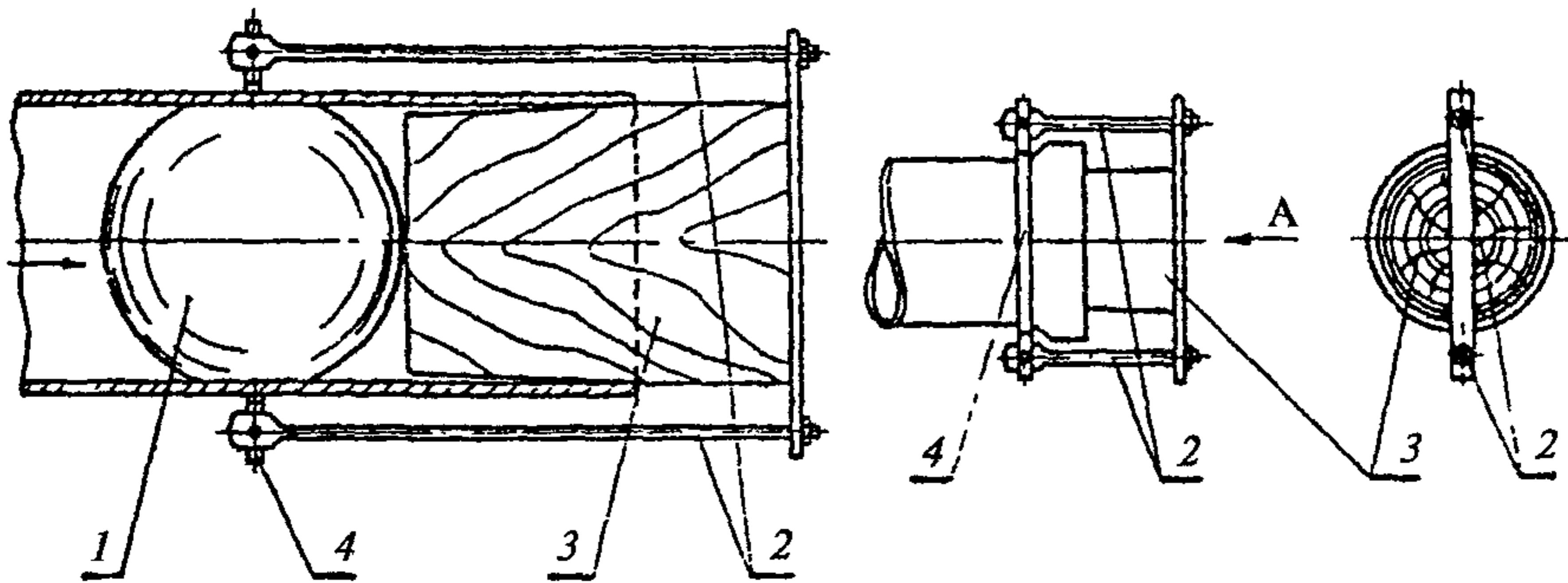
Рис. 9. Схема заглушки концов труб диаметром до 600 мм
