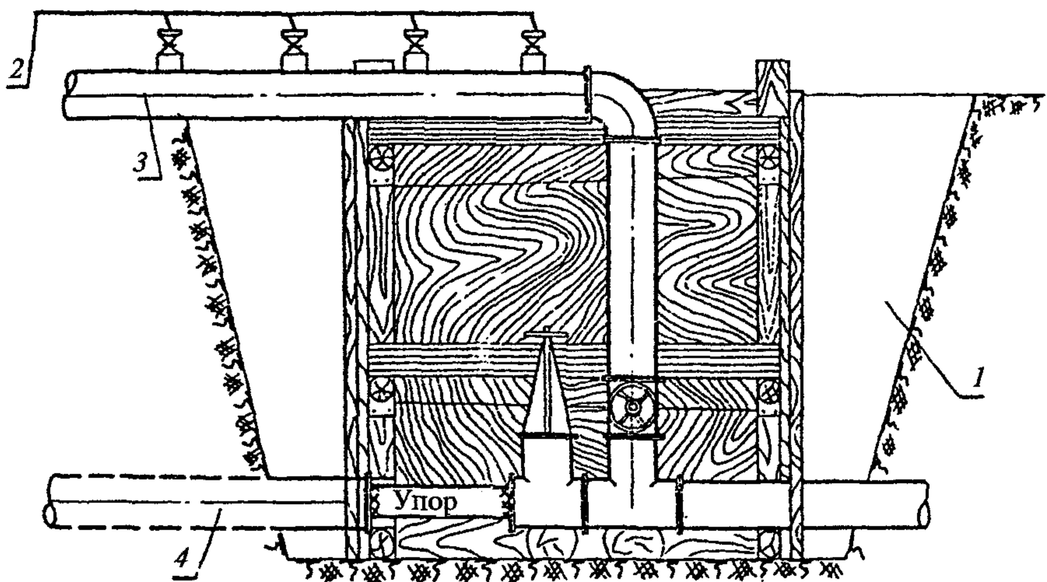
Рис. 1. Устройство присоединения временного обводного трубопровода через тройник на сохранившемся участке сети
