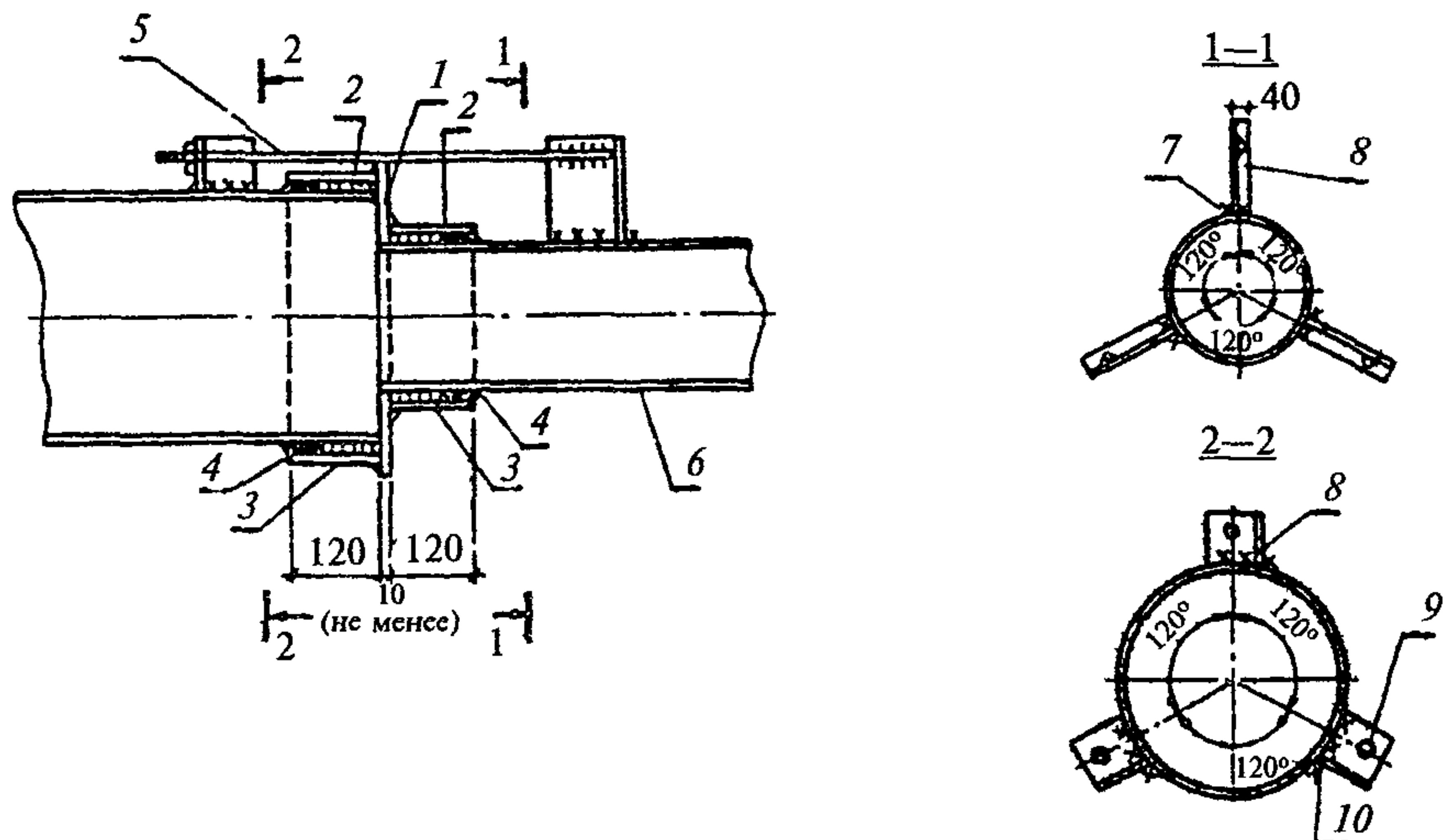
Рис. 8. Схема соединения труб разных диаметров при помощи сварного перехода
