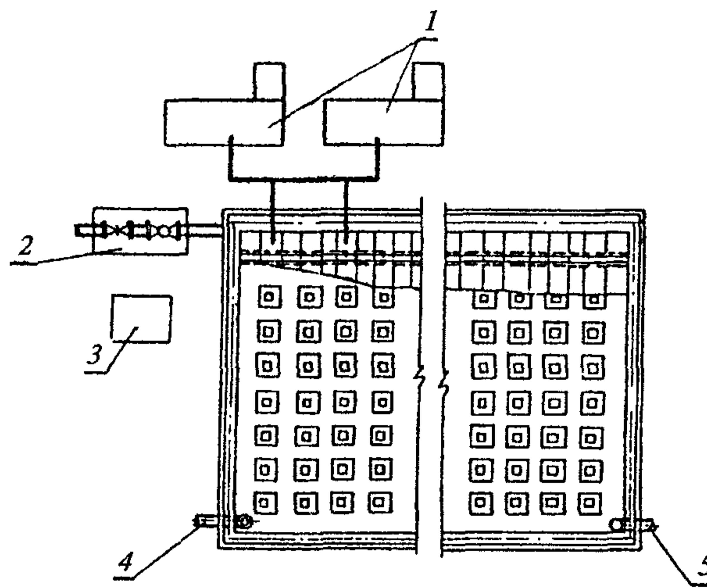
Рис. 11. Схема забора воды мотопомпами из резервуаров, оборудованных фильтрами-поглотителями
