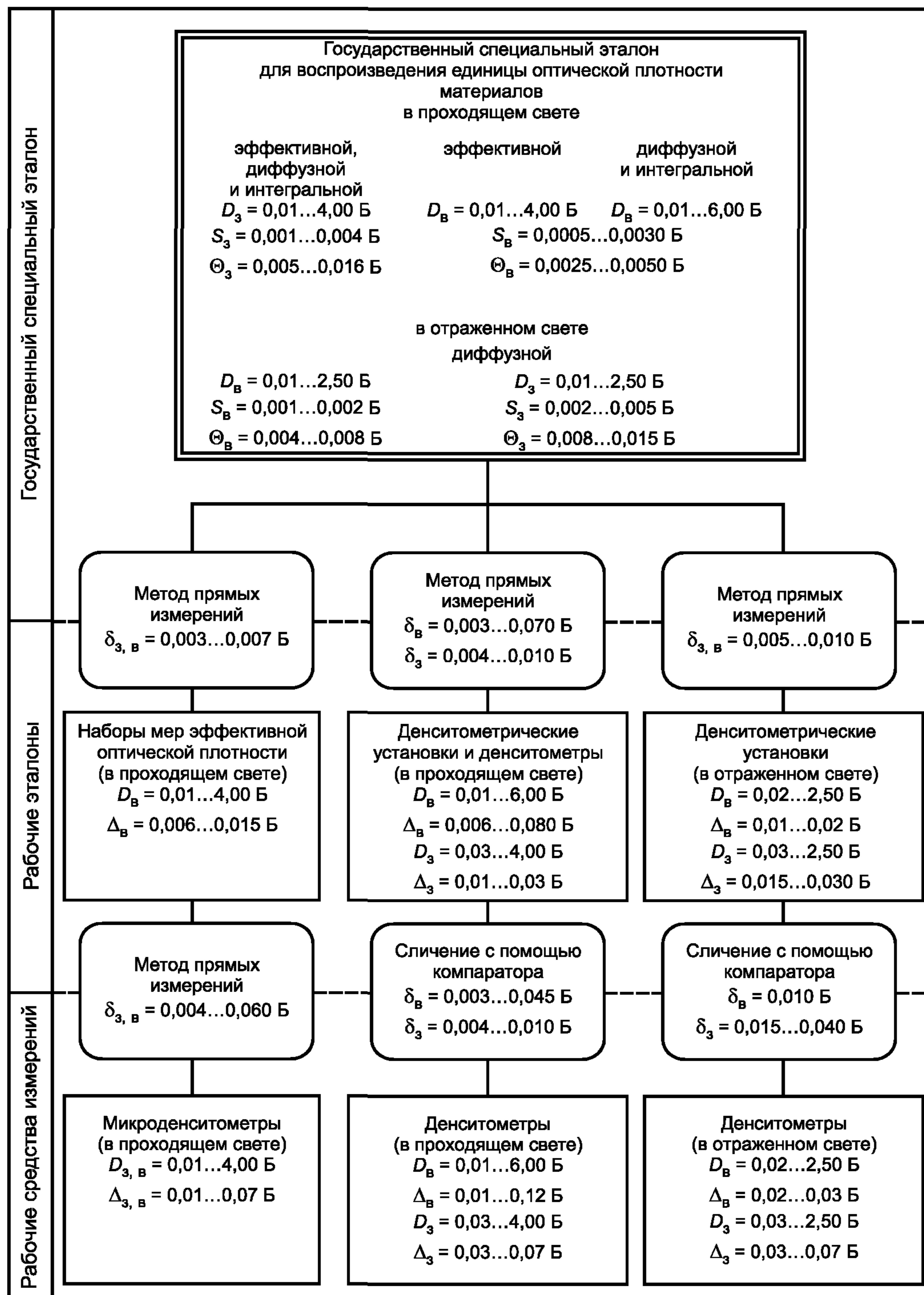
$\Delta_{3, B}$  – пределы основных допускаемых абсолютных погрешностей значений зональной и визуальной оптических плотностей;
