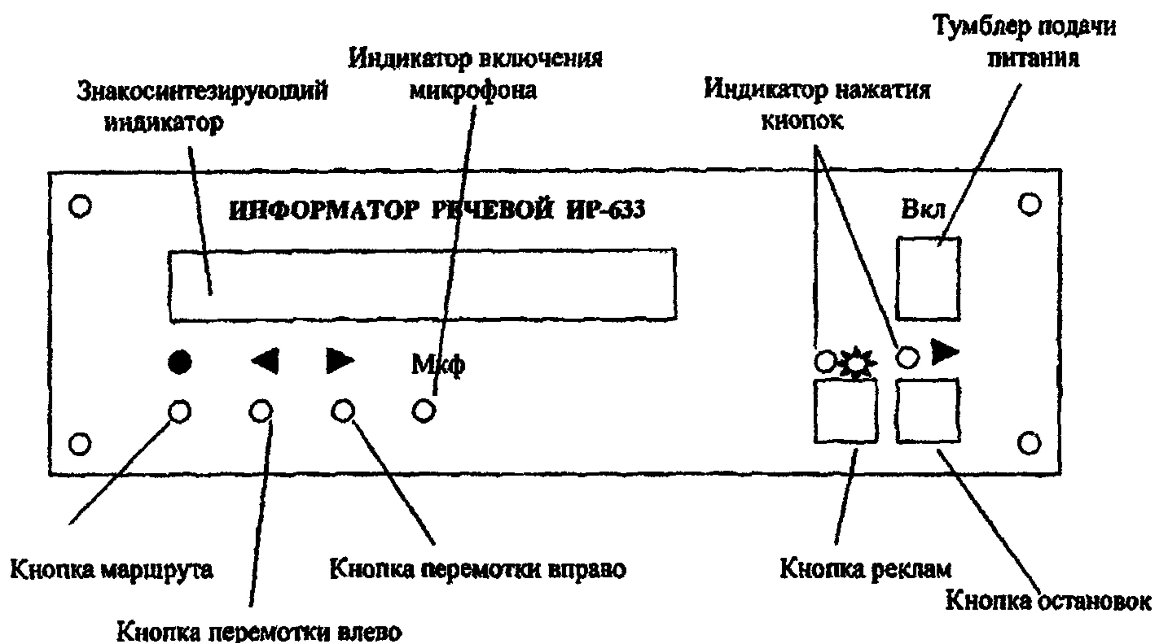
Рис. Передняя панель и органы управления информатором
