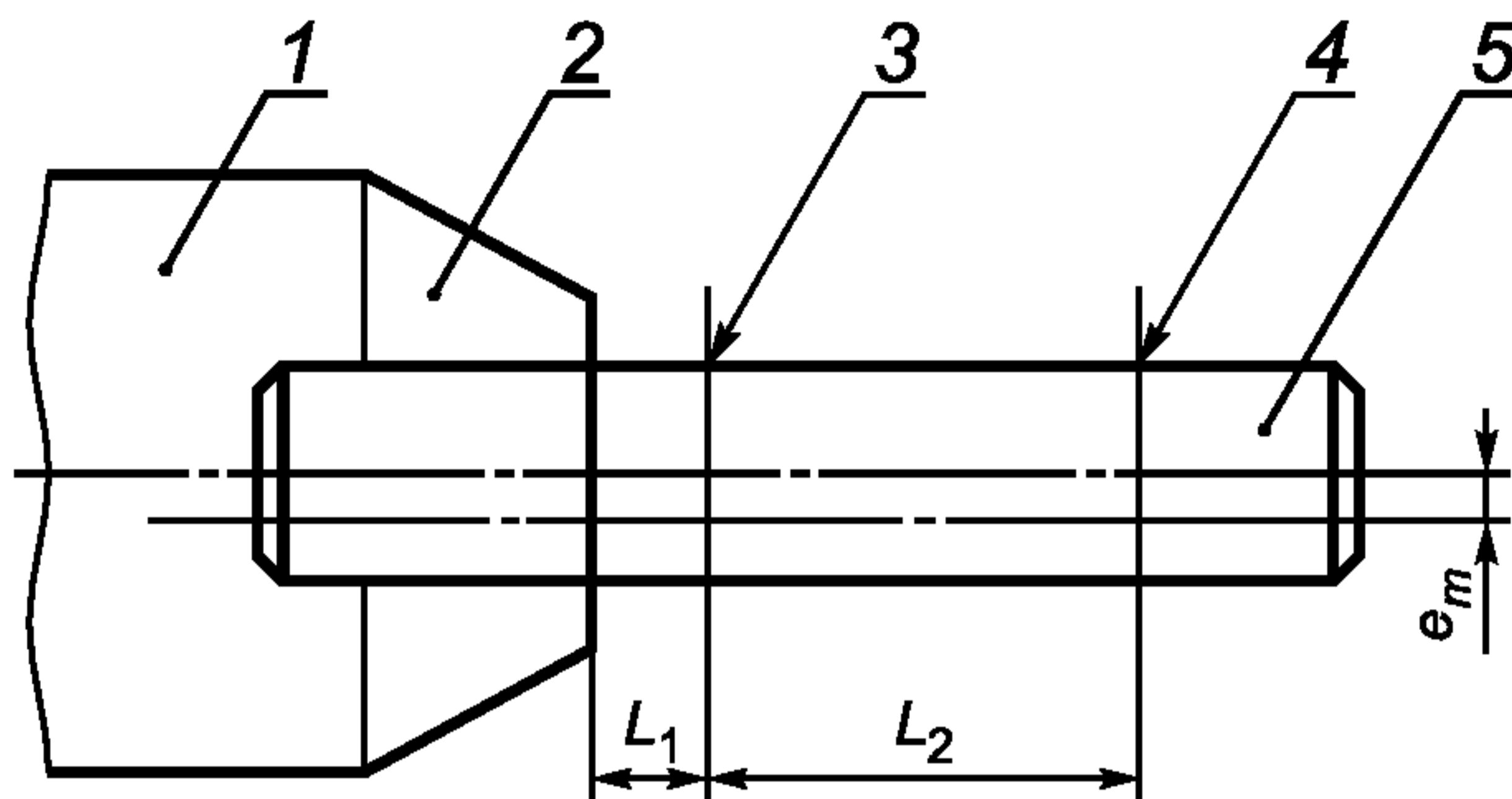
1 — приводной шпиндель (хвостовик зажимного устройства); 2 — зажимное устройство; 3, 4 — точки измерения биения;
