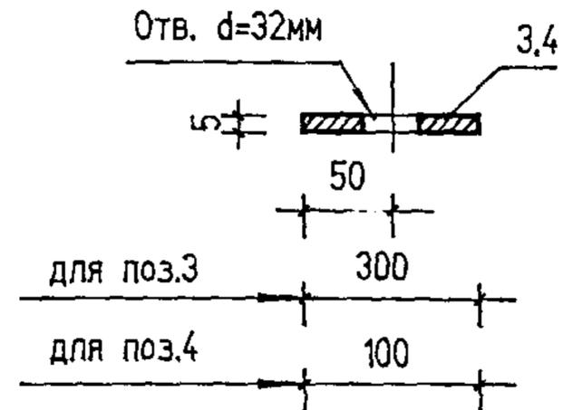
1. Сварку выполнить электродом Э-42, высоту шва принять по наименьшей толщине свариваемых элементов.
