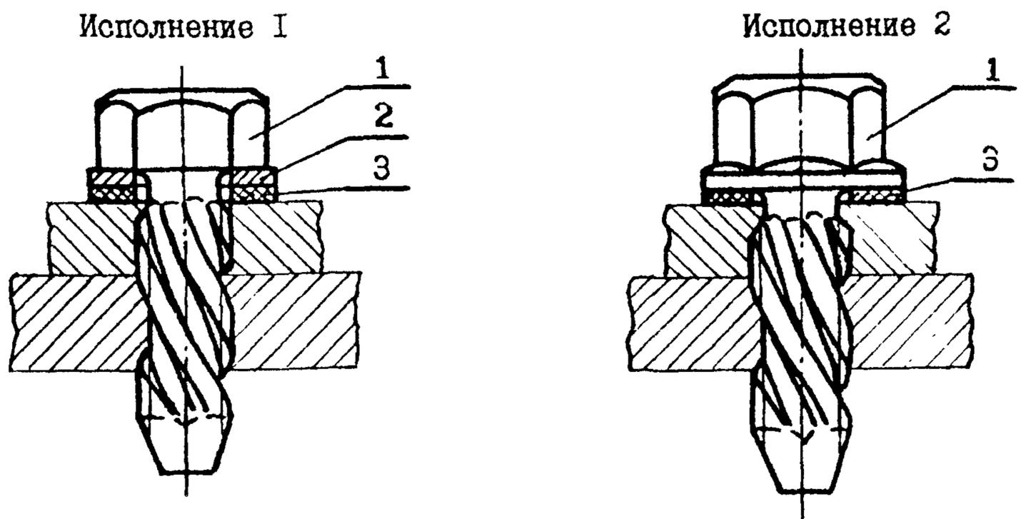
I - болт; 2 - шайба металлическая; 3 - шайба неметаллическая
