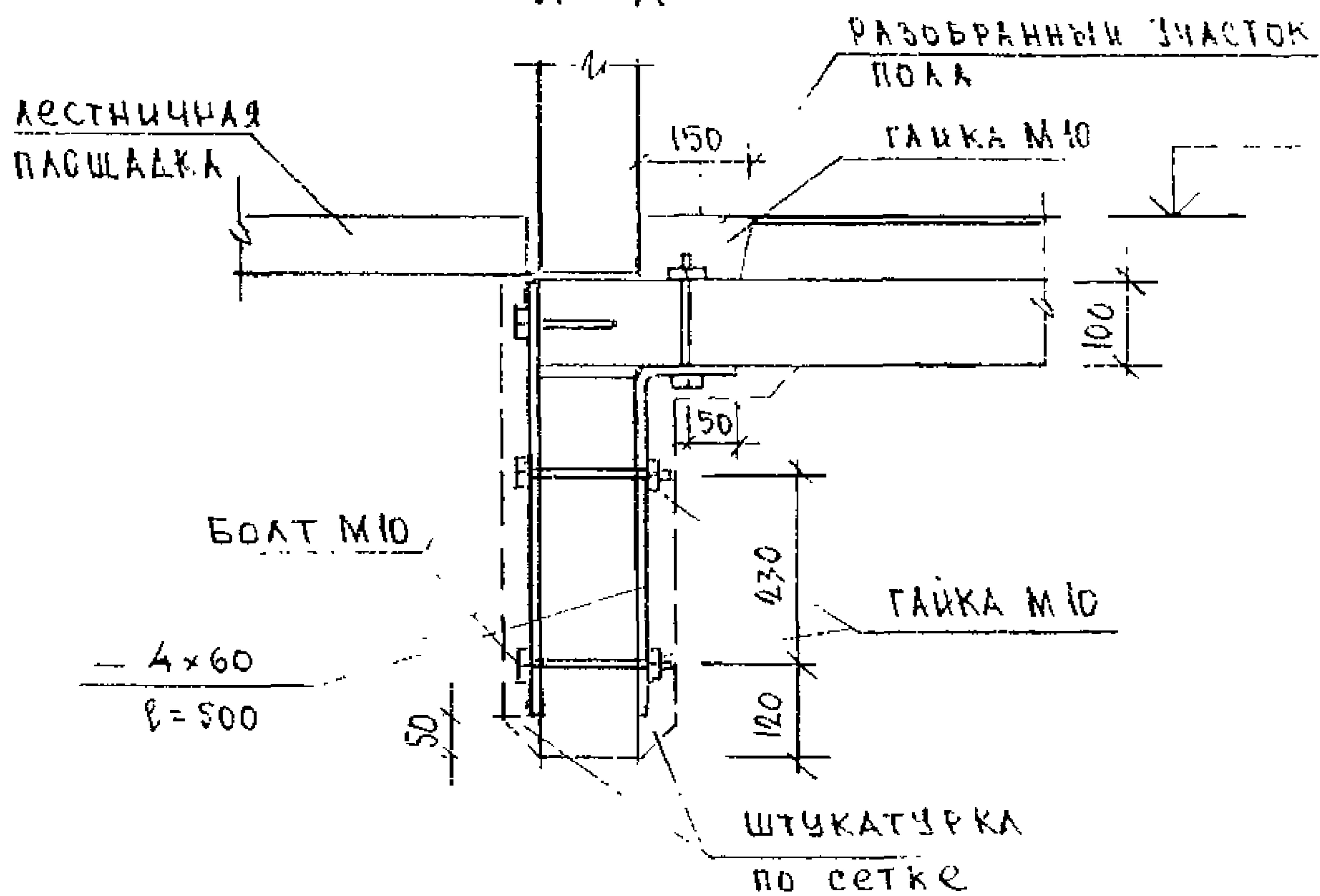
УСИЛЕНИЕ УГЛОВ НАРУЖНЫХ СТЕН
