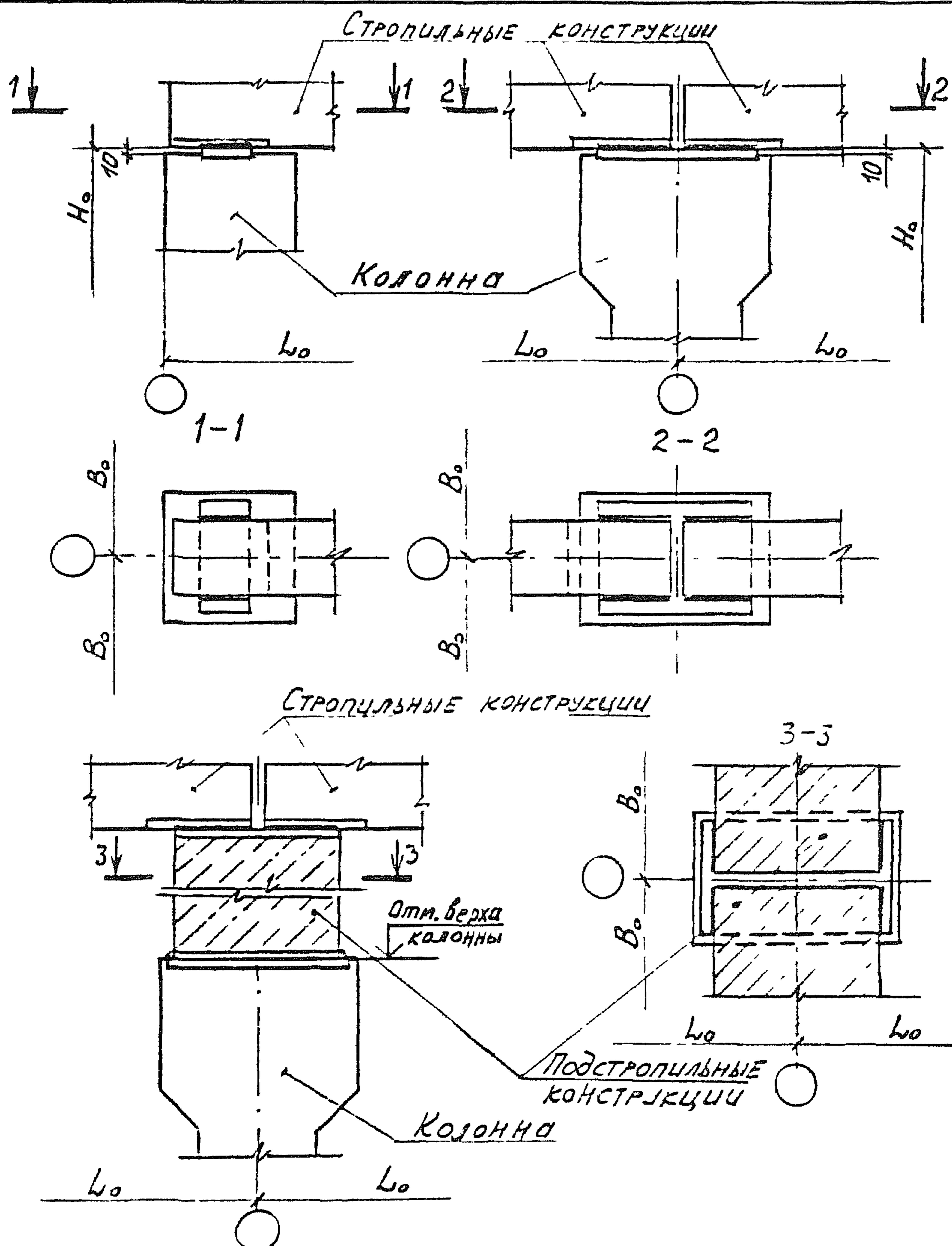
ОПИРАНИЕ СТРОПИЛЬНЫХ КОНСТРУКЦИЙ НА КРАЙНЮЮ КОЛОННУ УСЛОВНО
