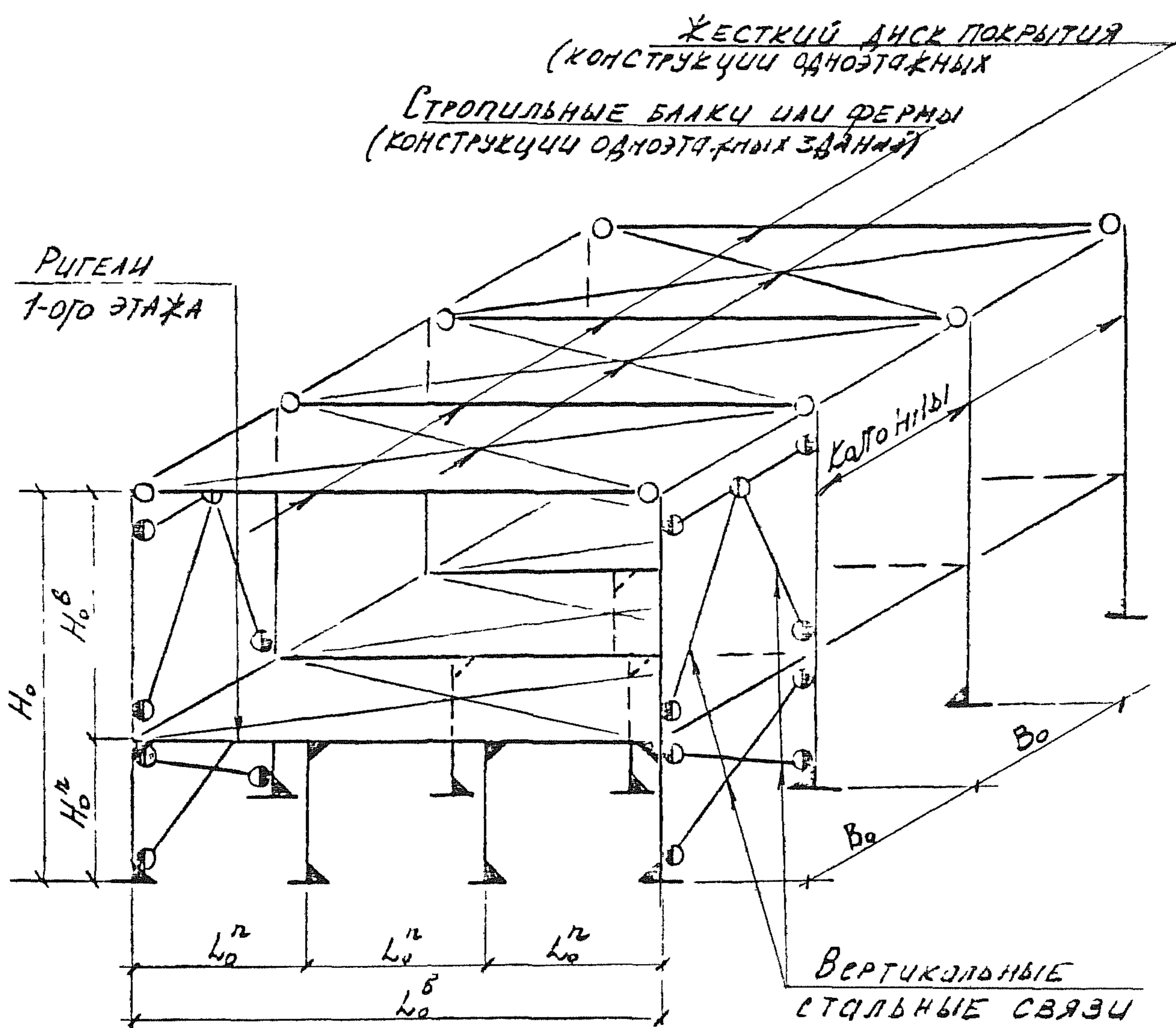
НЕИЗМЕНЯЕМОСТЬ КАРКАСА СЕКЦИИ ОБЕСПЕЧИВАЕТСЯ ПО ПОПЕРЕЧНОМУ НАПРАВЛЕНИЮ КООРДИНАЦИОННЫХ ОСЕЙ ЖЕСТКИМИ УЗЛАМИ ПЕРВОГО ЯРУСА (РАМНАЯ СХЕМА) И ЖЕСТКОСТОЮ КОЛОНН, ПО ПРОДОЛНОМУ — ВЕРТИКАЛЬНЫМИ СТАЛЬНЫМИ СВЯЗЯМИ (СВЯЗЕВАЯ СХЕМА)
