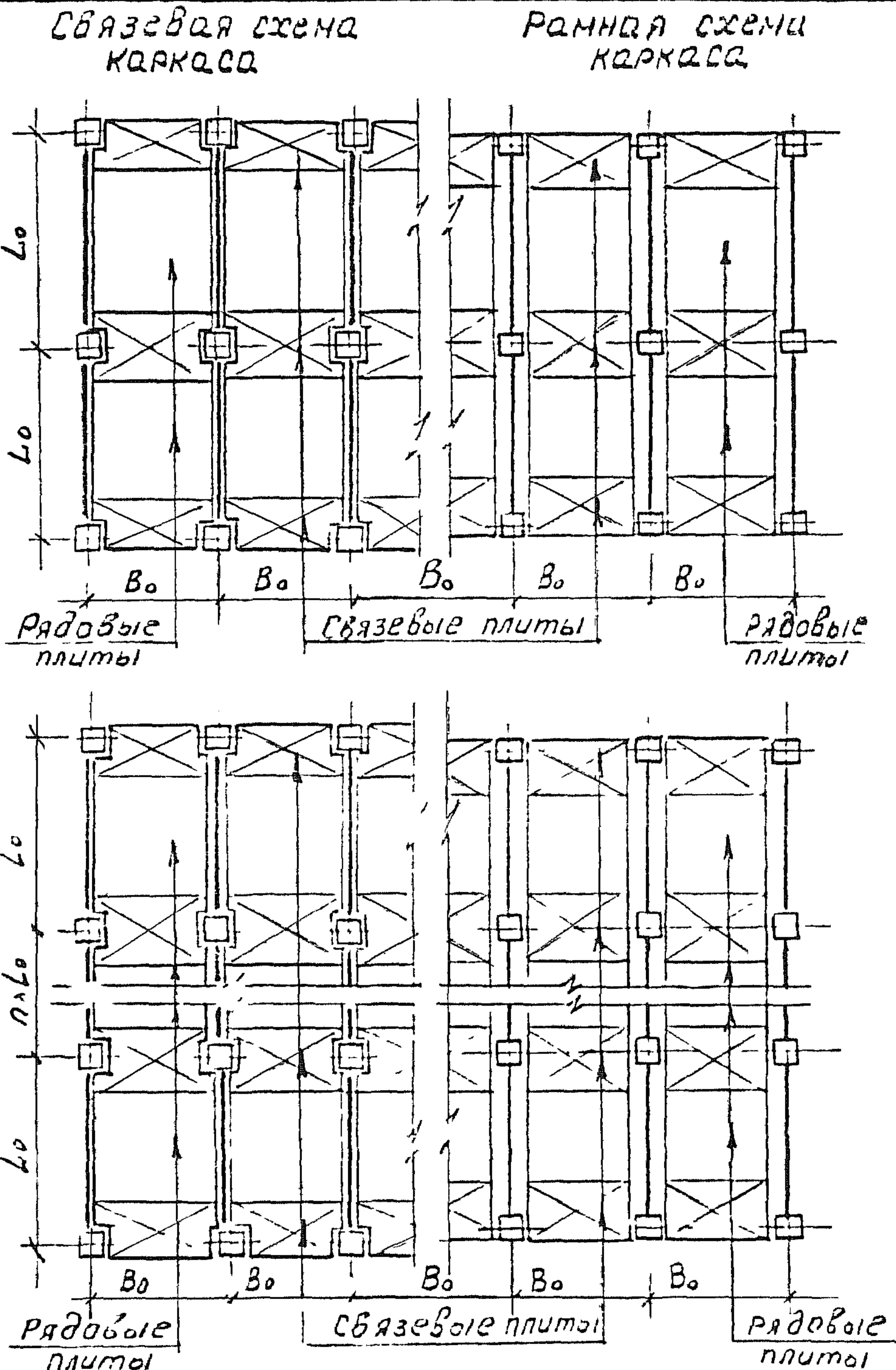
Жесткость диска перекрытия обеспечивается присоединкой связевых плит к ригелям и колоннам. Структура покрытия верхних этажей увеличены по отношению к первому этажу размерами модульной сетки принимается аналогично решениям одноэтажных зданий.
