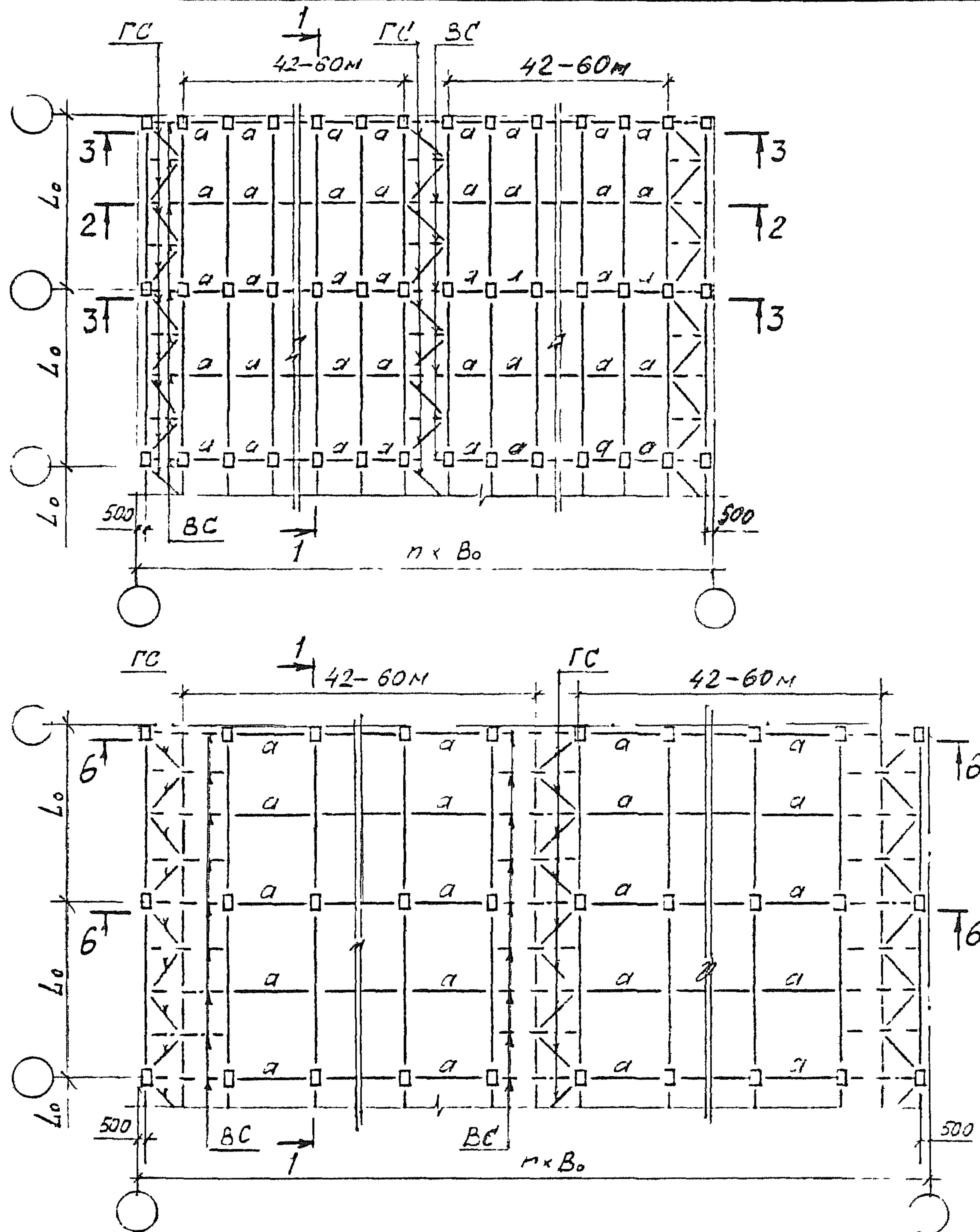
СХЕМЫ СЕКЦИЙ ПРЧВЕДЕНЫ ДЛЯ  $L_0 = 24\text{м}$  И  $B_0 = 6$  И  $12\text{м}$ .
