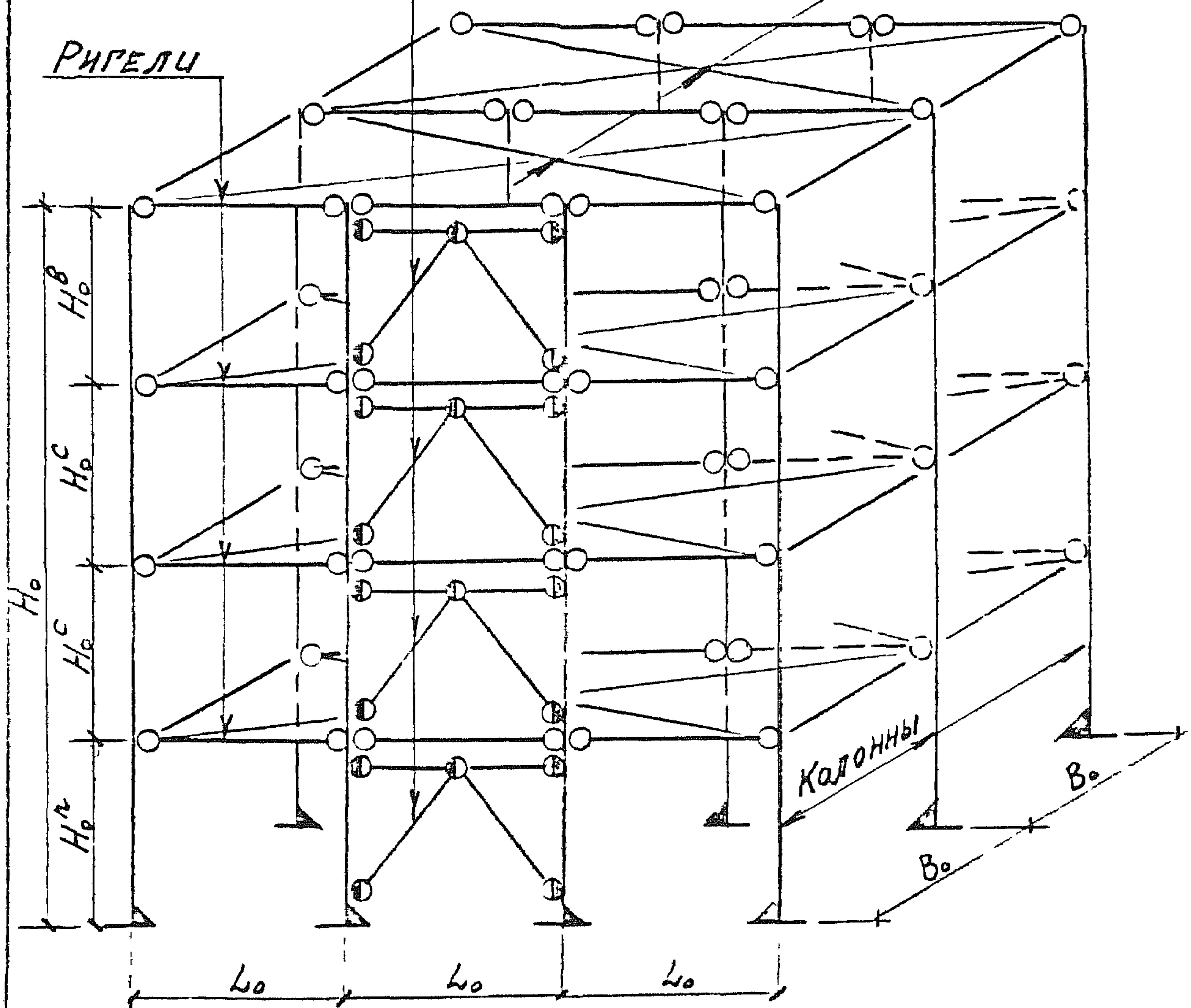
НЕИЗМЕНЯЕМОСТЬ КАРКАСОВ ПО ПОПЕРЕЧНОМУ И ПРОГЛОБ-
