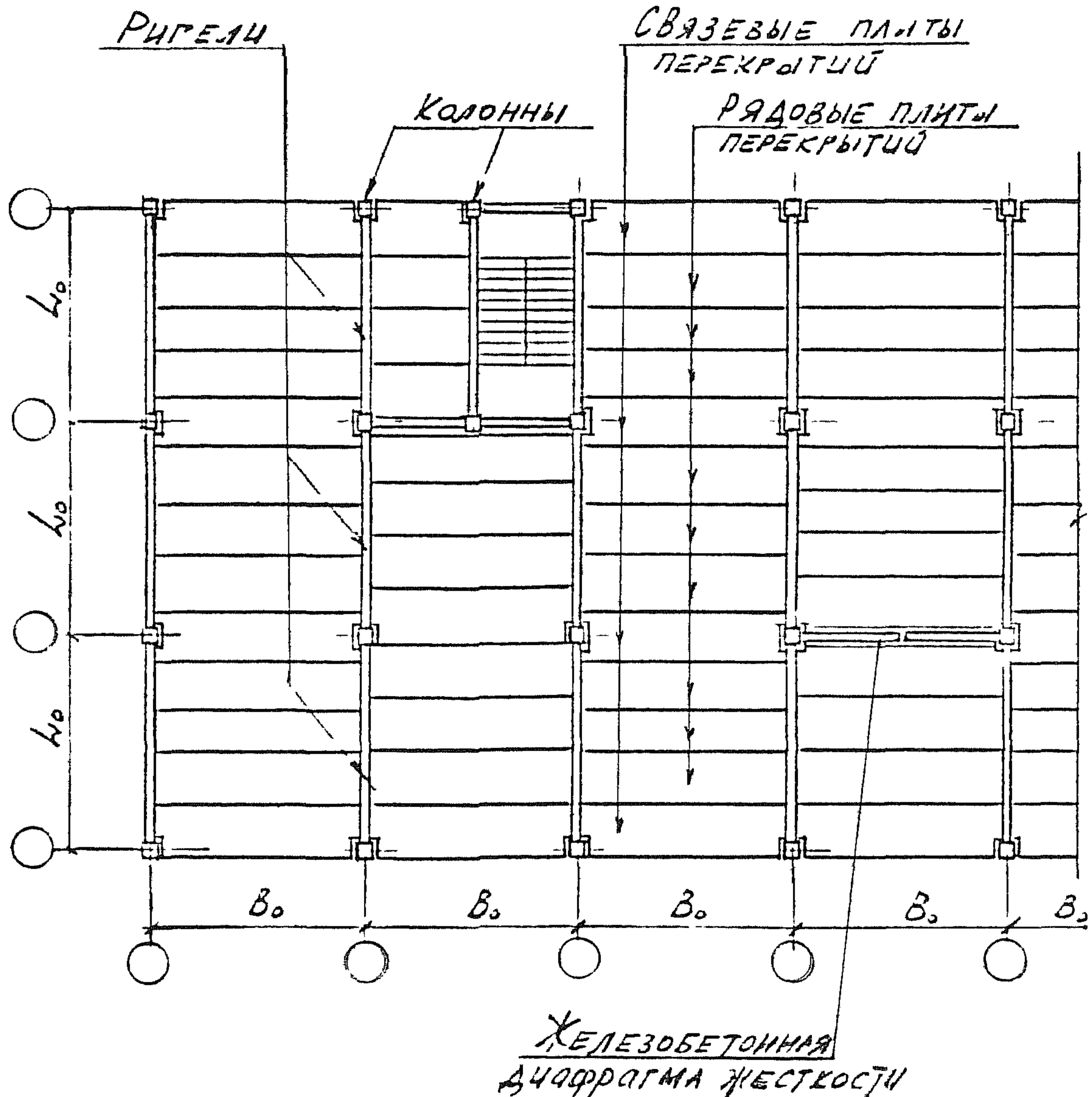
На схеме показан вариант с многопустотными панелями
