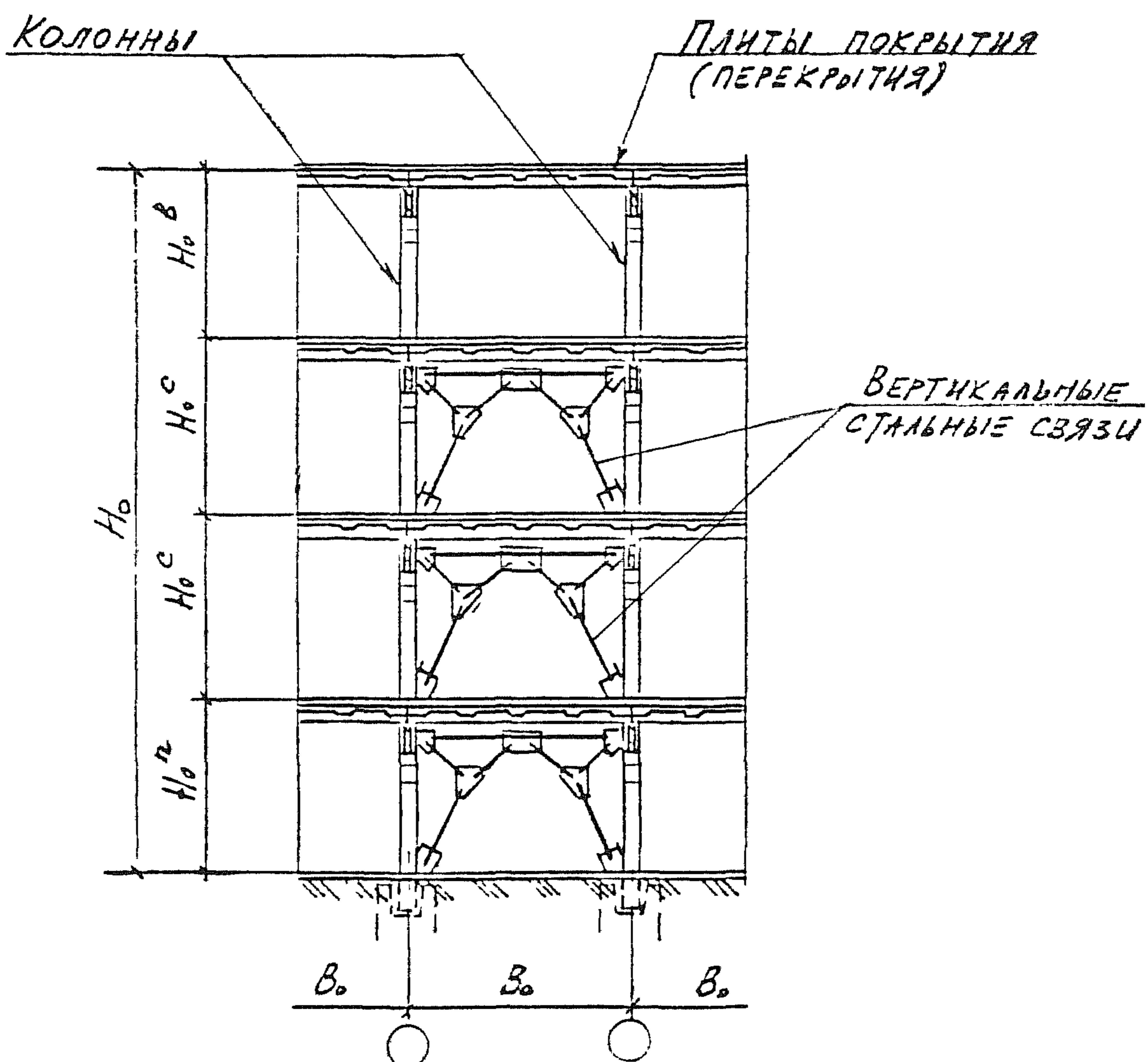
НА СХЕМЕ ПОКАЗАН ОСНОВНОЙ ВАРИАНТ ОБЕСПЕЧЕНИЯ НЕИЗМЕНЯЕМОСТИ РАМНЫХ КАРКАСОВ ПО ПРОДОЛЬНОМУ НАПРАВЛЕНИЮ КООРДИНАЦИОННЫХ ОСЕЙ.
