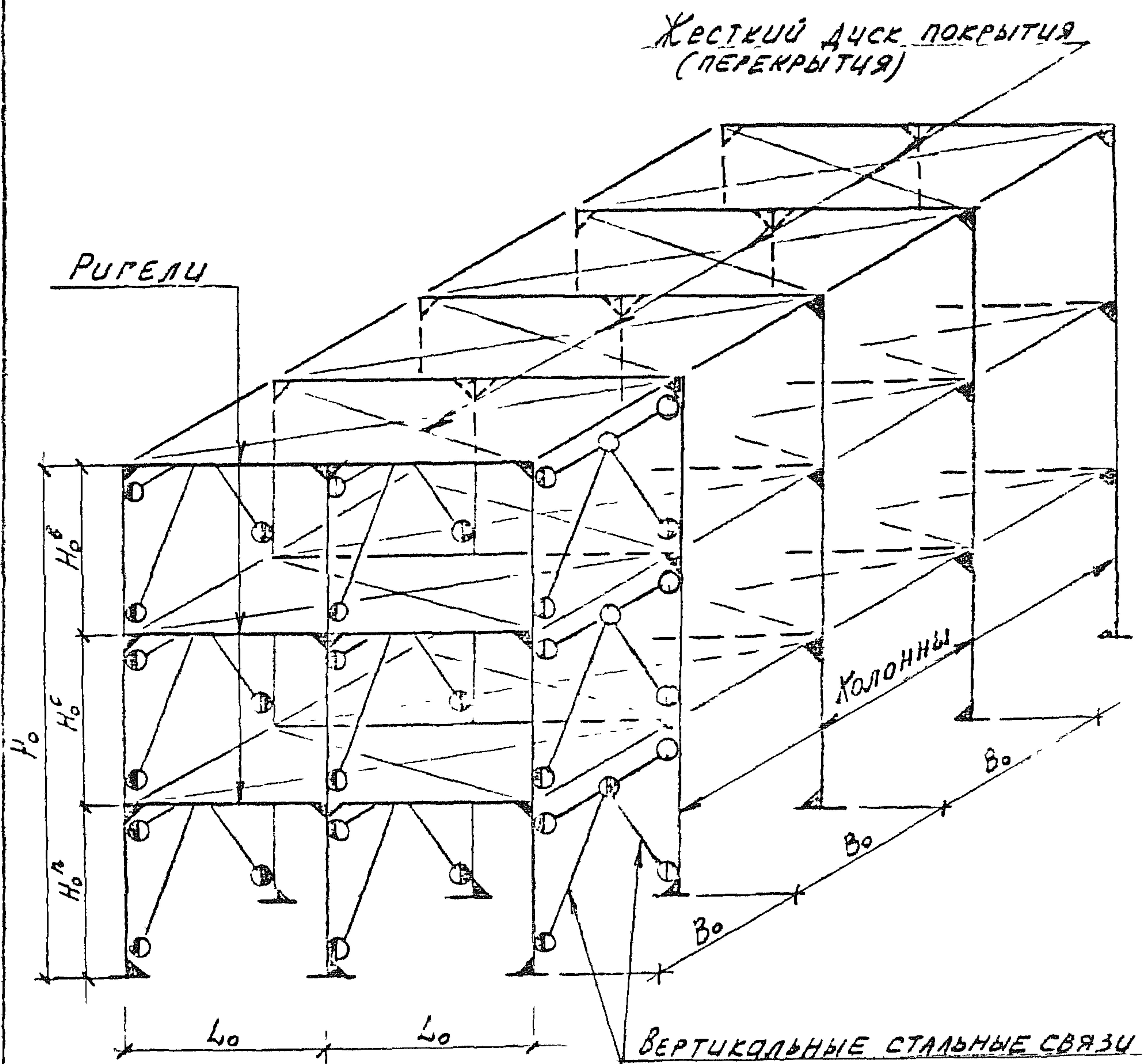
Незменяемость каркаса секции обеспечивается по поперечному направлению координационных осей жесткими узлами сопряжения ригелей с колоннами (рамная схема), по продольному - вертикальными стальными связями (связевая схема).
