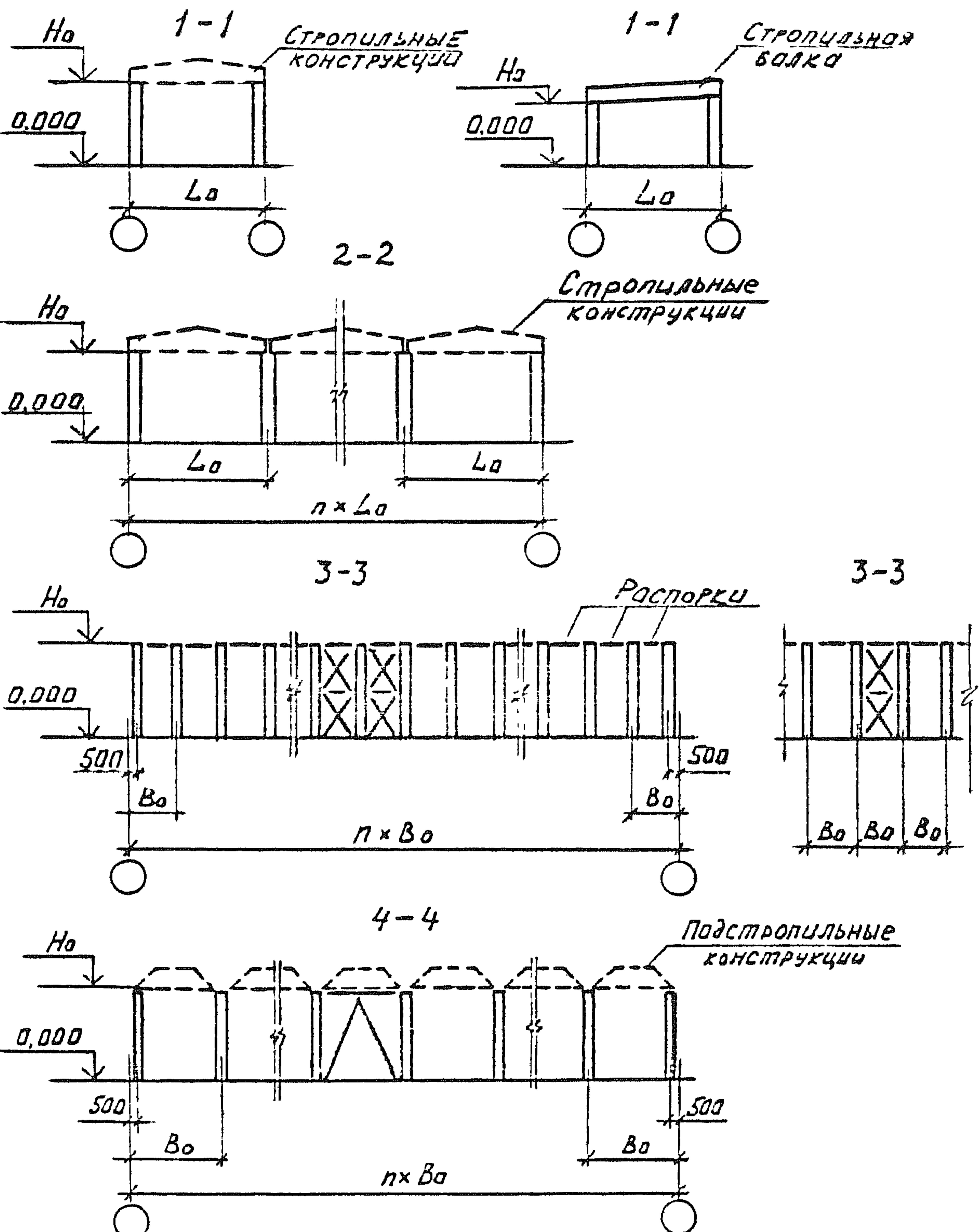
Разрез 1-1 приведён для двухскатного и односкатного покрытия; разрез 3-3 — для связей в одном и двух шагах колонн
