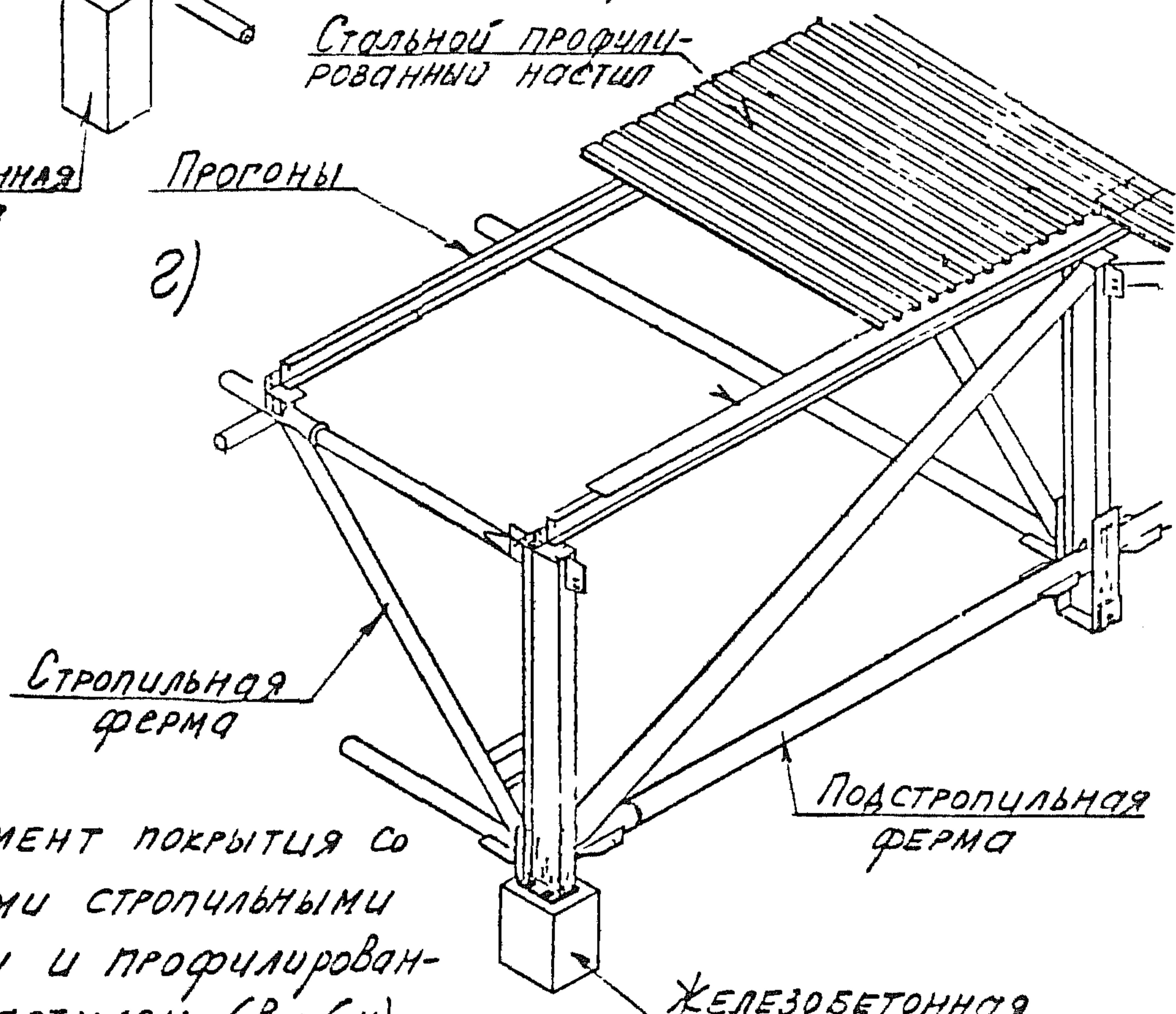
8) Фрагмент покрытия со стальными стропильными фермами и профилированным настилом ( $B_0=6\text{м}$ )
