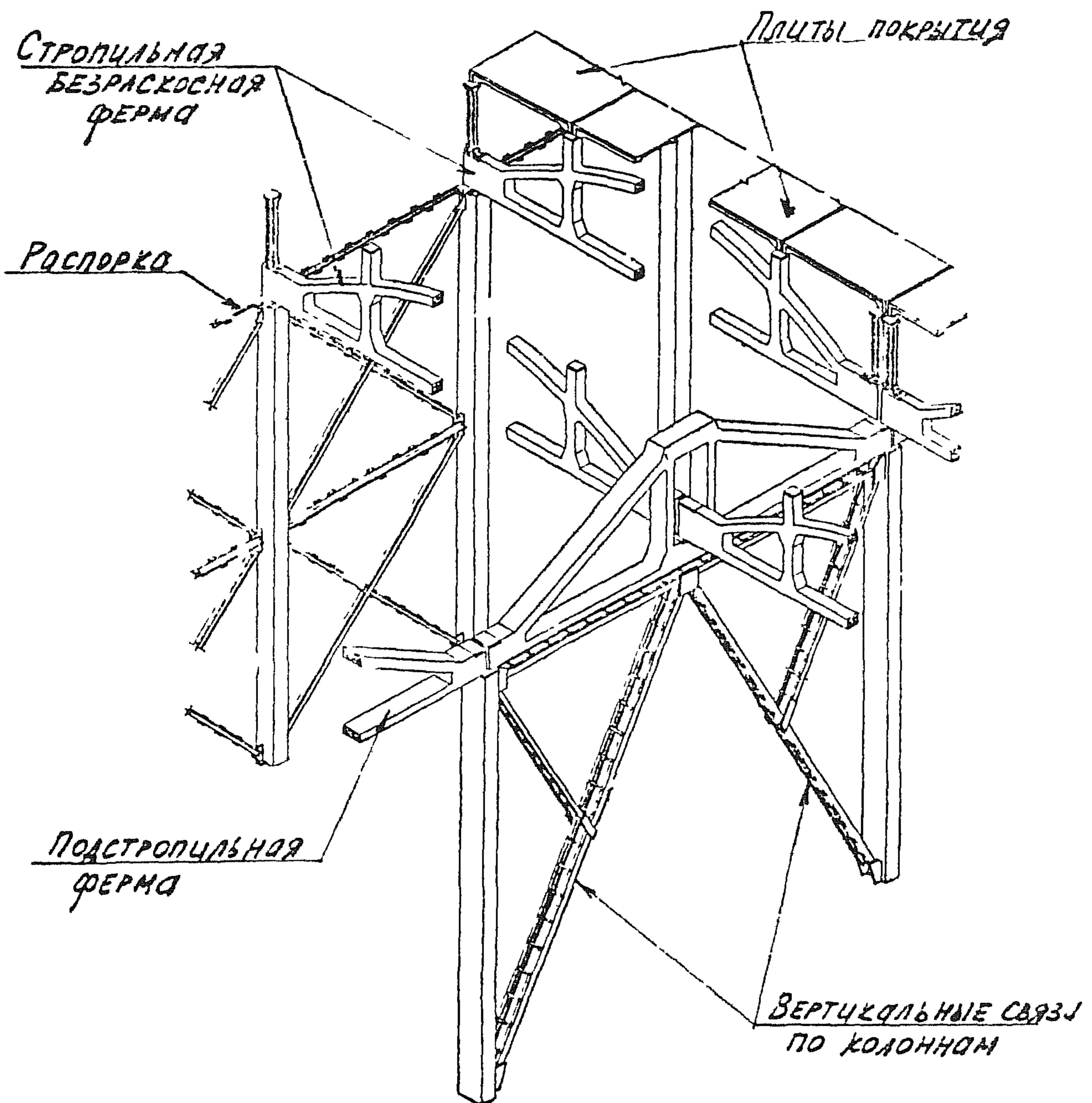
Показано одноэтажное производственное здание с подстропильными фермами и  $B_0=6\text{m}$  по краинему и  $B_0=12\text{m}$  среднему рядам колонн
