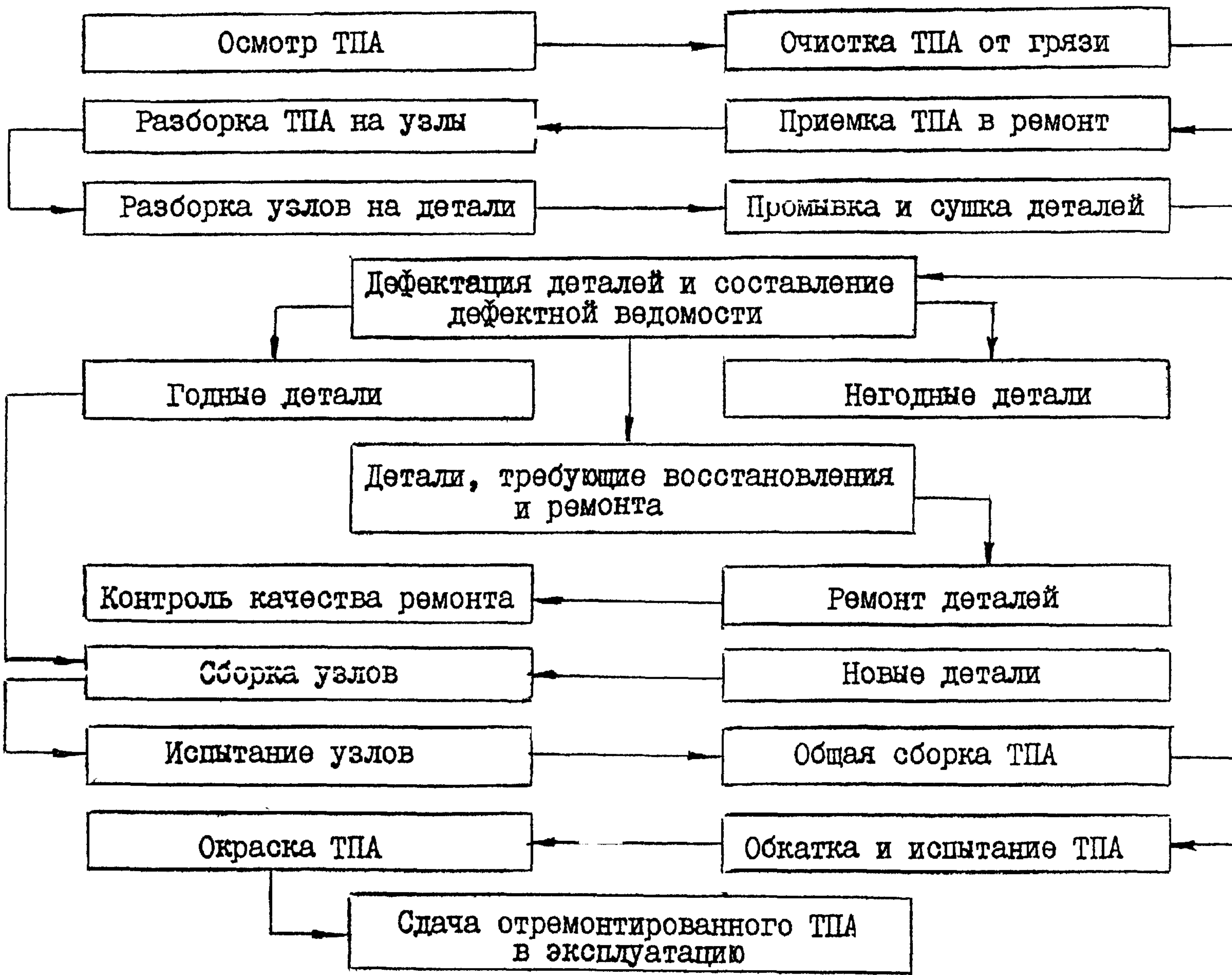
Рис. I Общая схема технологического процесса ремонта тэрмопластавтомата
