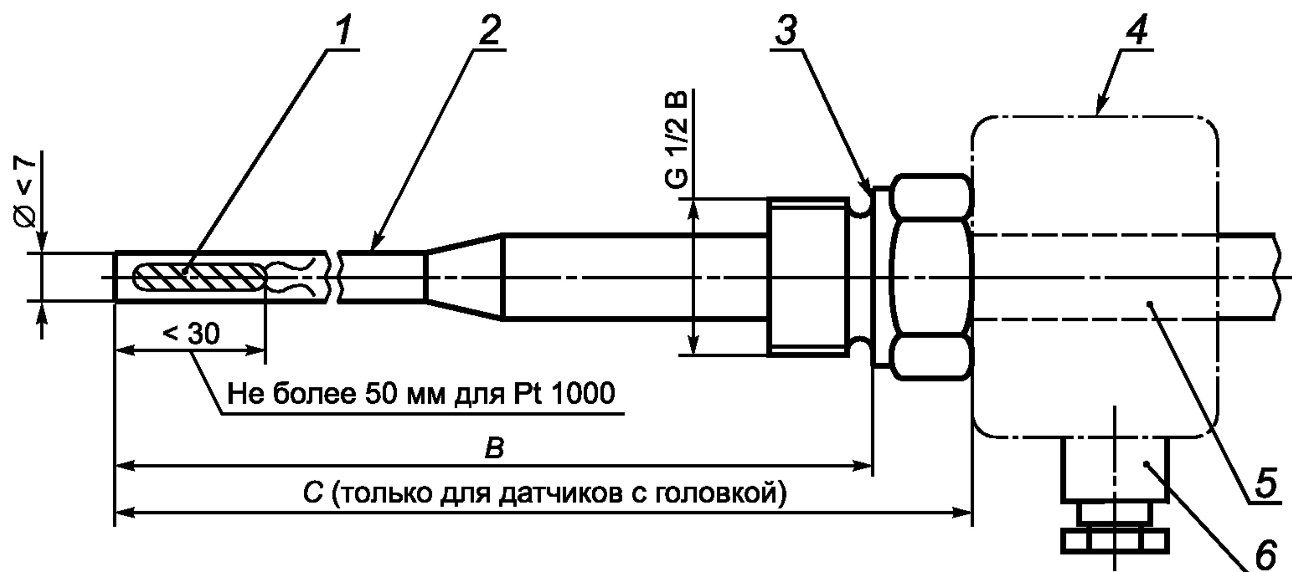
1 — термочувствительный элемент; 2 — защитный корпус; 3 — поверхность уплотнителя; 4 — контур головки датчика; 5 — контур постоянно присоединенного кабеля сигнала; 6 — вход для кабеля сигнала (диаметр: не более 9 мм)
