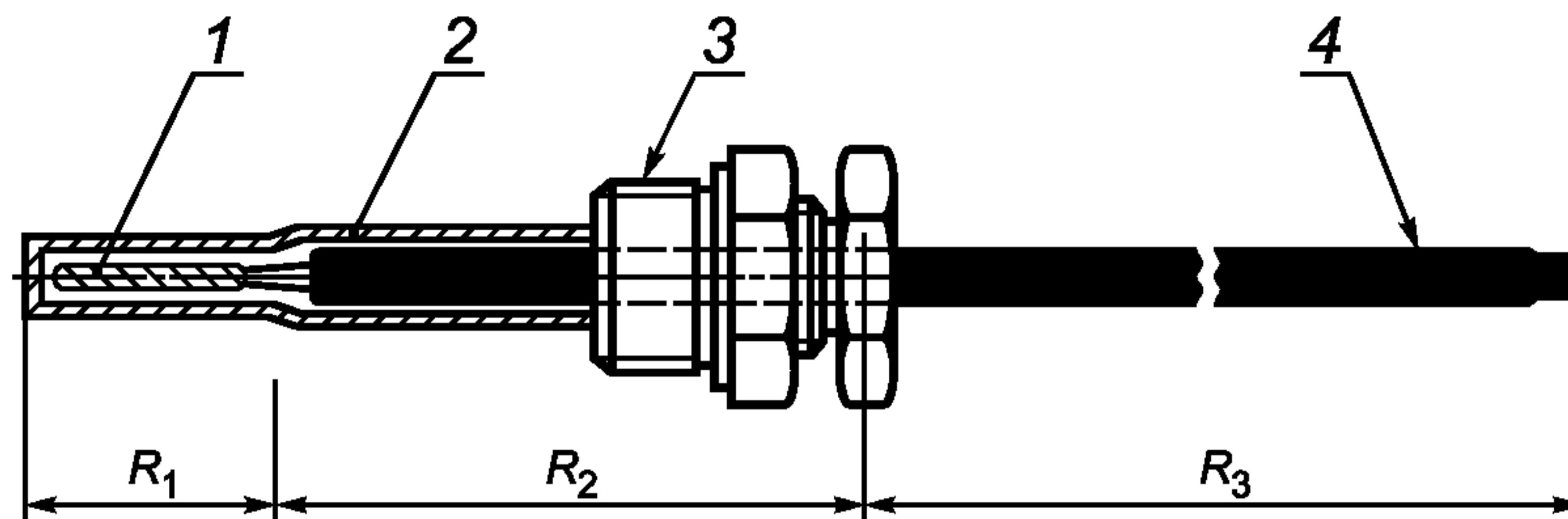
1 — термочувствительный элемент; 2 — защитный корпус; 3 — резьба для монтажа; 4 — кабель сигнала;  $R_1$  — сопротивление термочувствительного элемента;  $R_2$  — сопротивление внутреннего провода и разъемов;  $R_3$  — сопротивление кабеля сигнала
