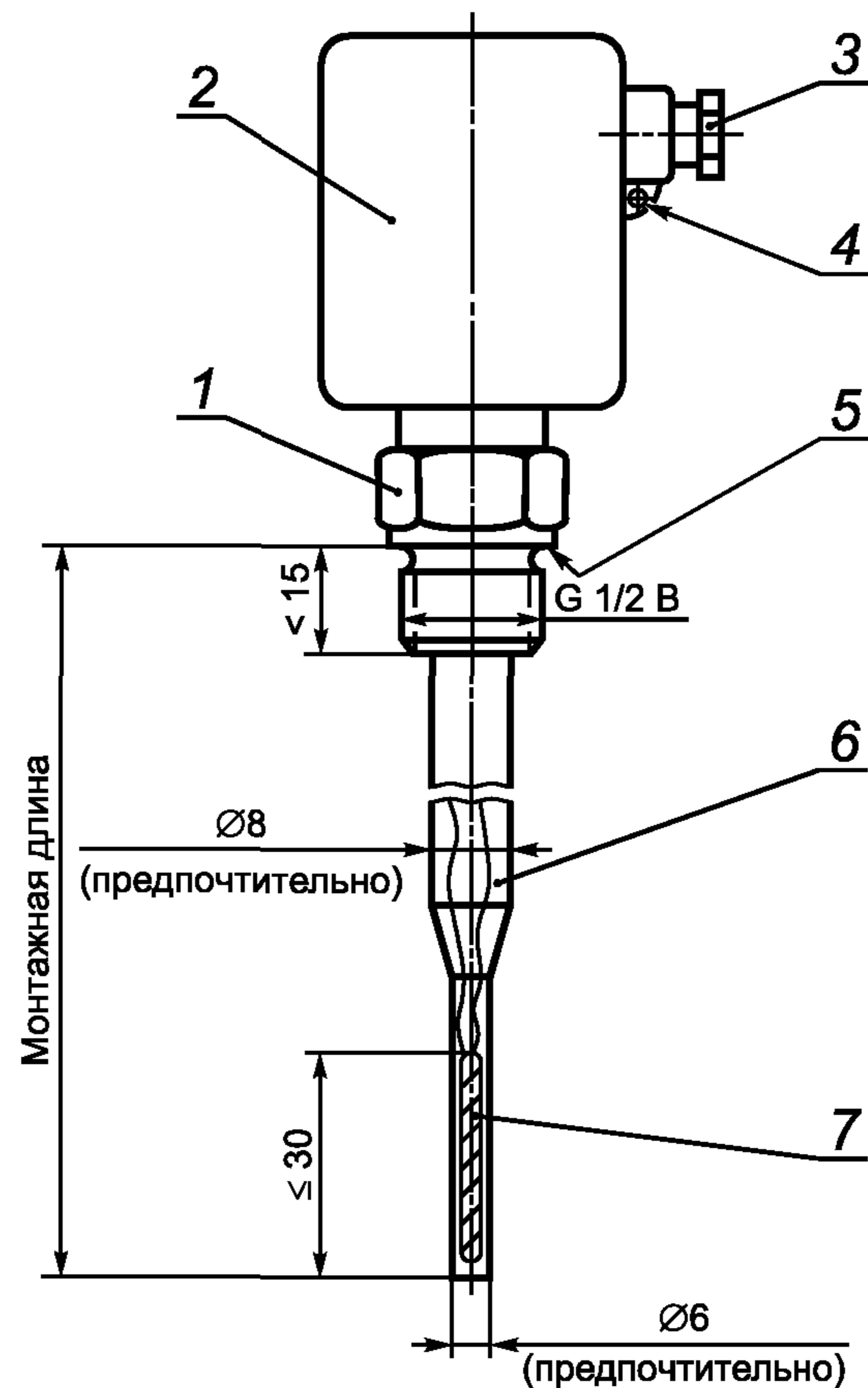
1 — зажимная гайка; 2 — головка (типичная); 3 — вход для кабеля сигнала; 4 — место для опломбирования; 5 — поверхность уплотнения; 6 — защитный корпус датчика температуры; 7 — термо чувствительный элемент
