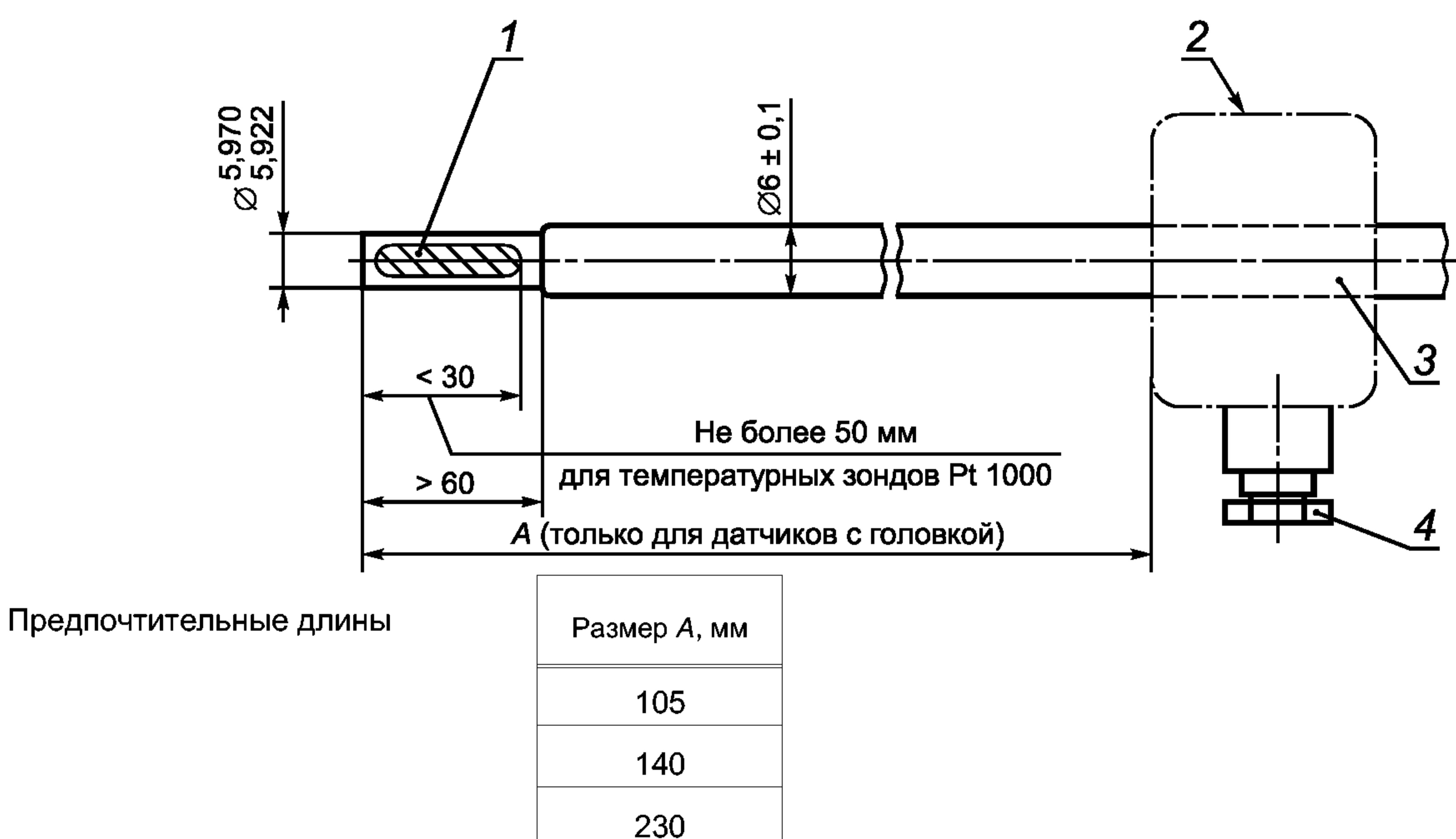
1 — термочувствительный элемент; 2 — контур головки датчика; 3 — контур постоянно присоединенного кабеля сигнала;
