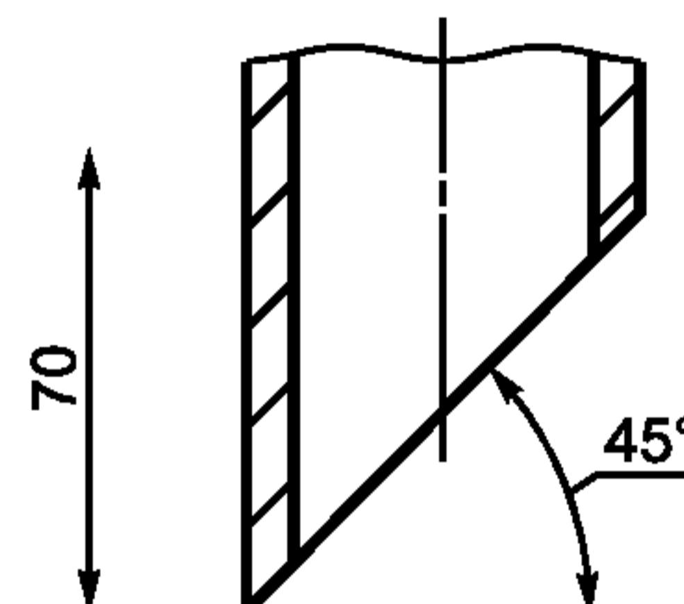
б) Установочный штуцер для использования с датчиком, установленным в колено трубы, или с датчиком, установленным под углом (см. рисунки А.8 В и А.8 С)
