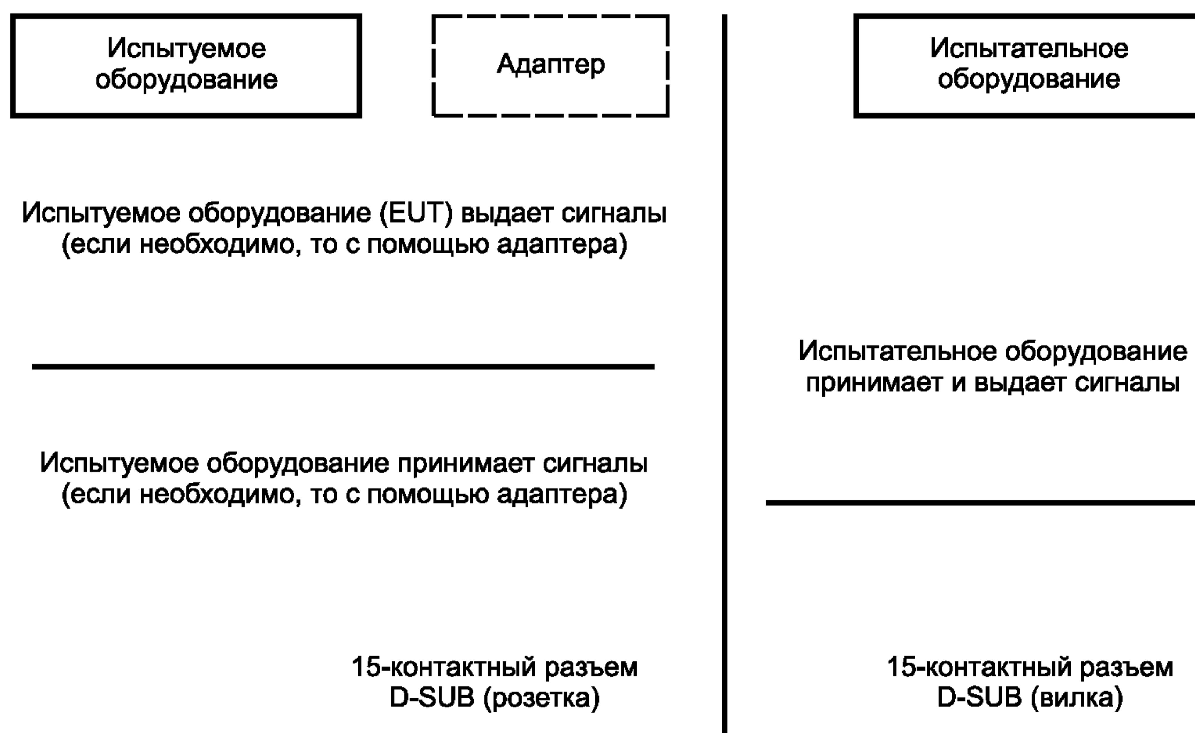
Рисунок В.1 — Схема обмена сигналами
