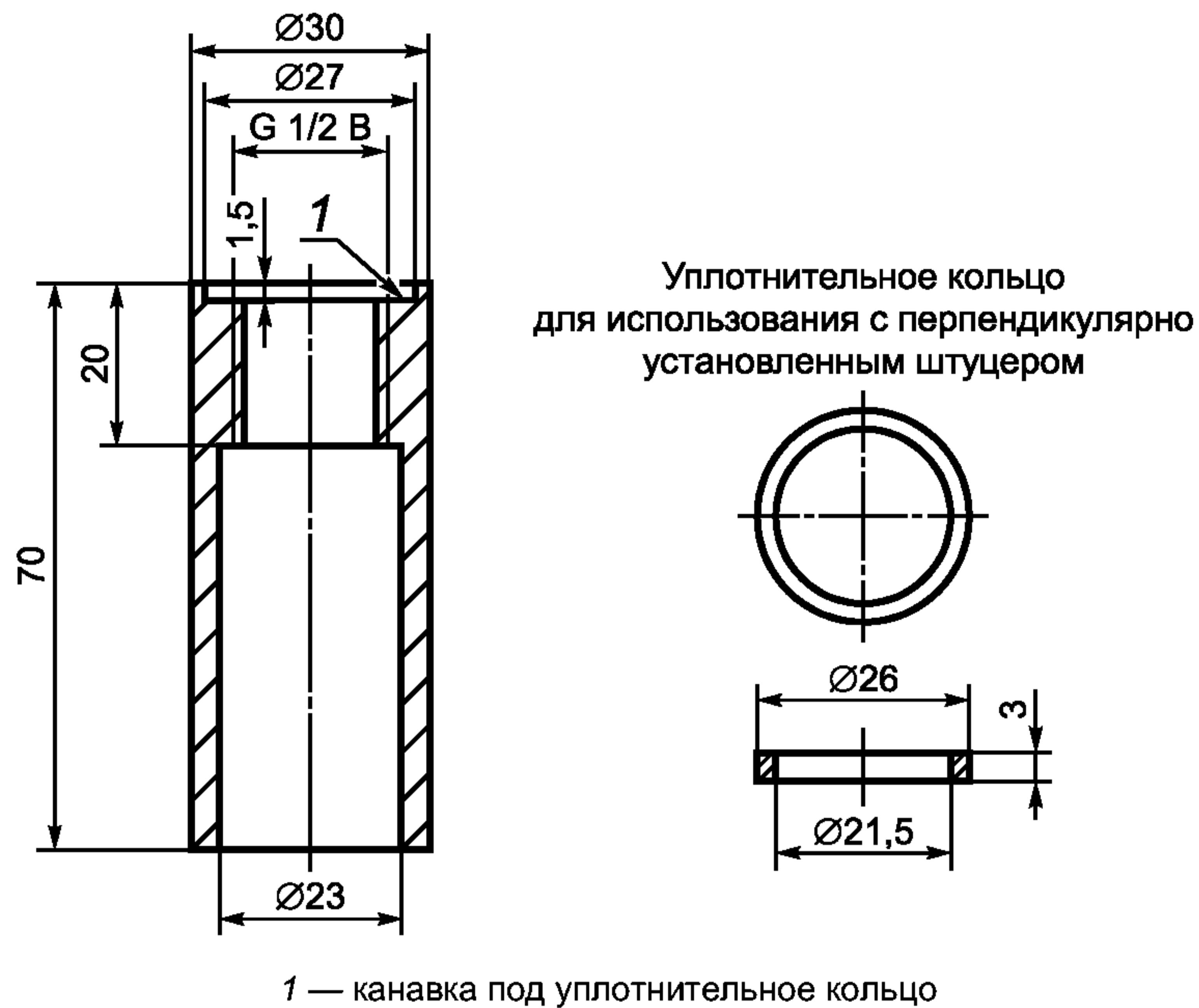
а) Установочный штуцер для использования с перпендикулярно установленным датчиком (см. рисунок А.8 D)
