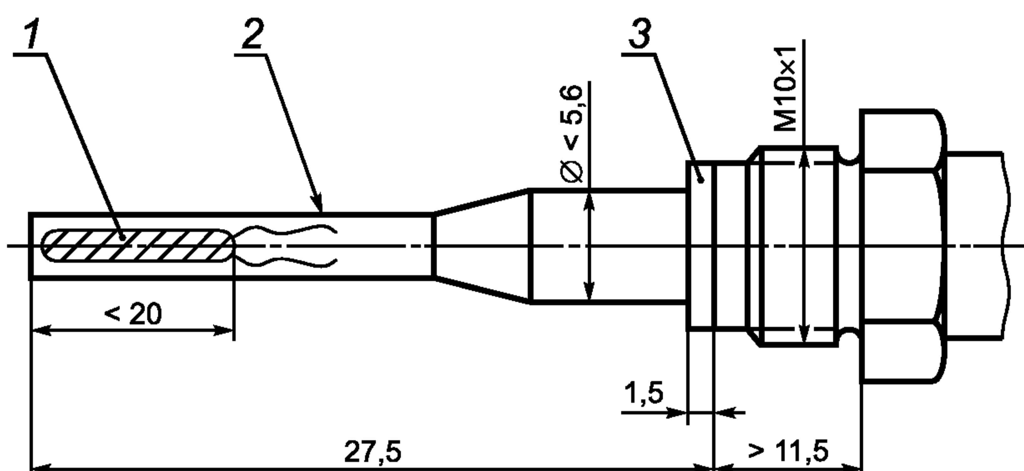
1 — термо чувствительный элемент; 2 — защитный корпус; 3 — уплотнительное кольцо
