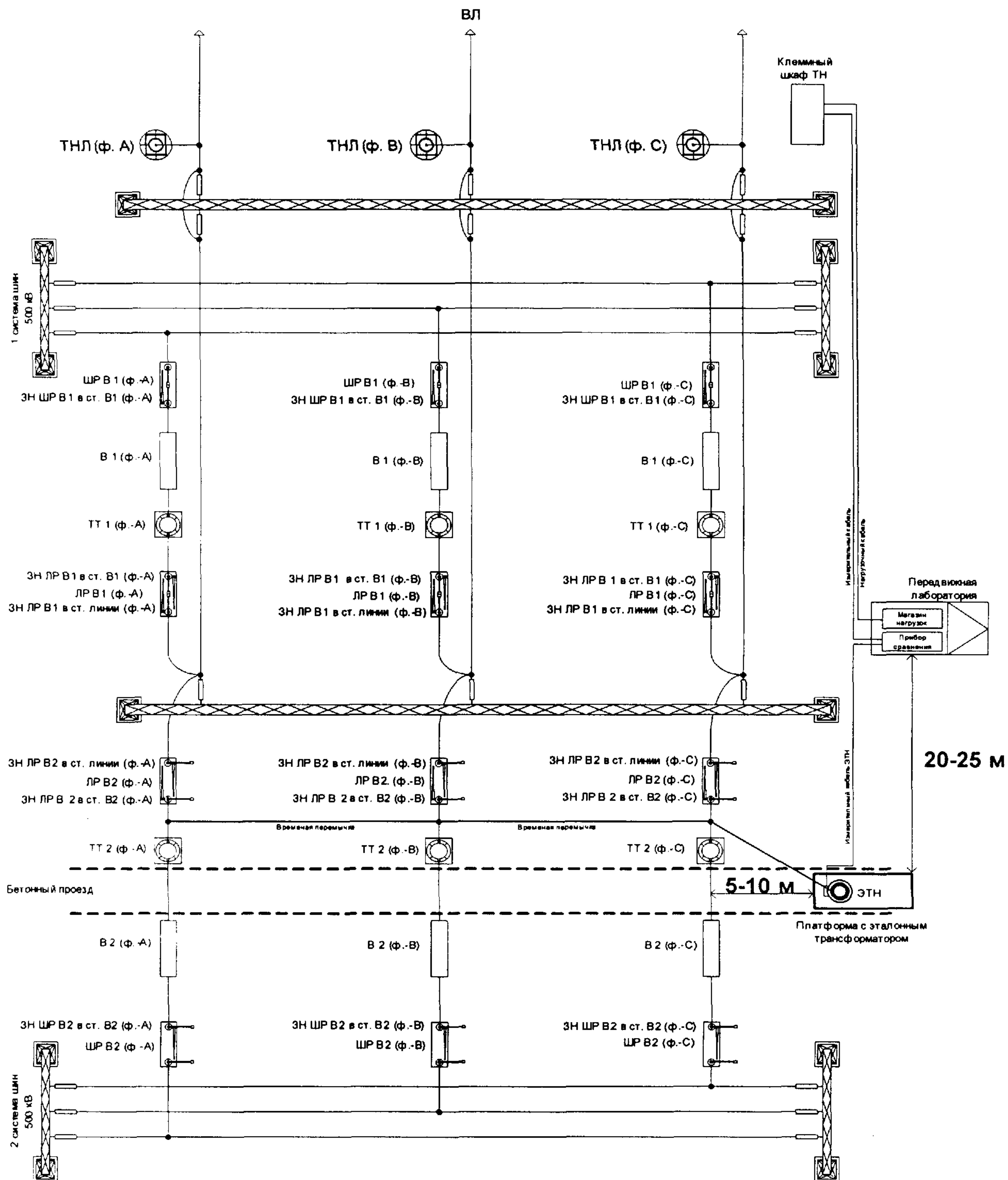
ТНЛ (ф. А, В, С) - трансформатор напряжения линии (фазы А, В, С);
