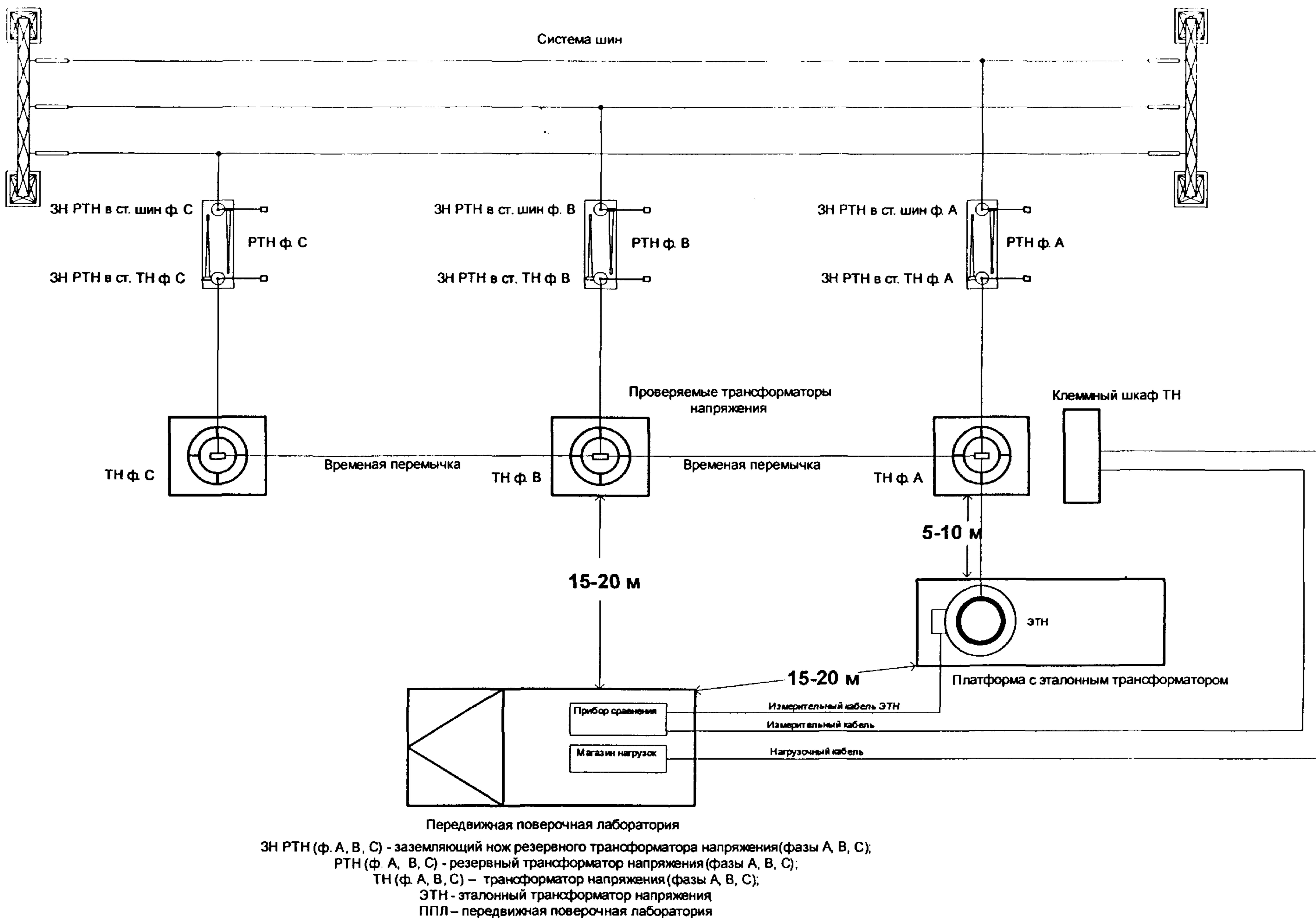
Рис. 2 – Схема расположения оборудования при поверке шинных трансформаторов напряжения
