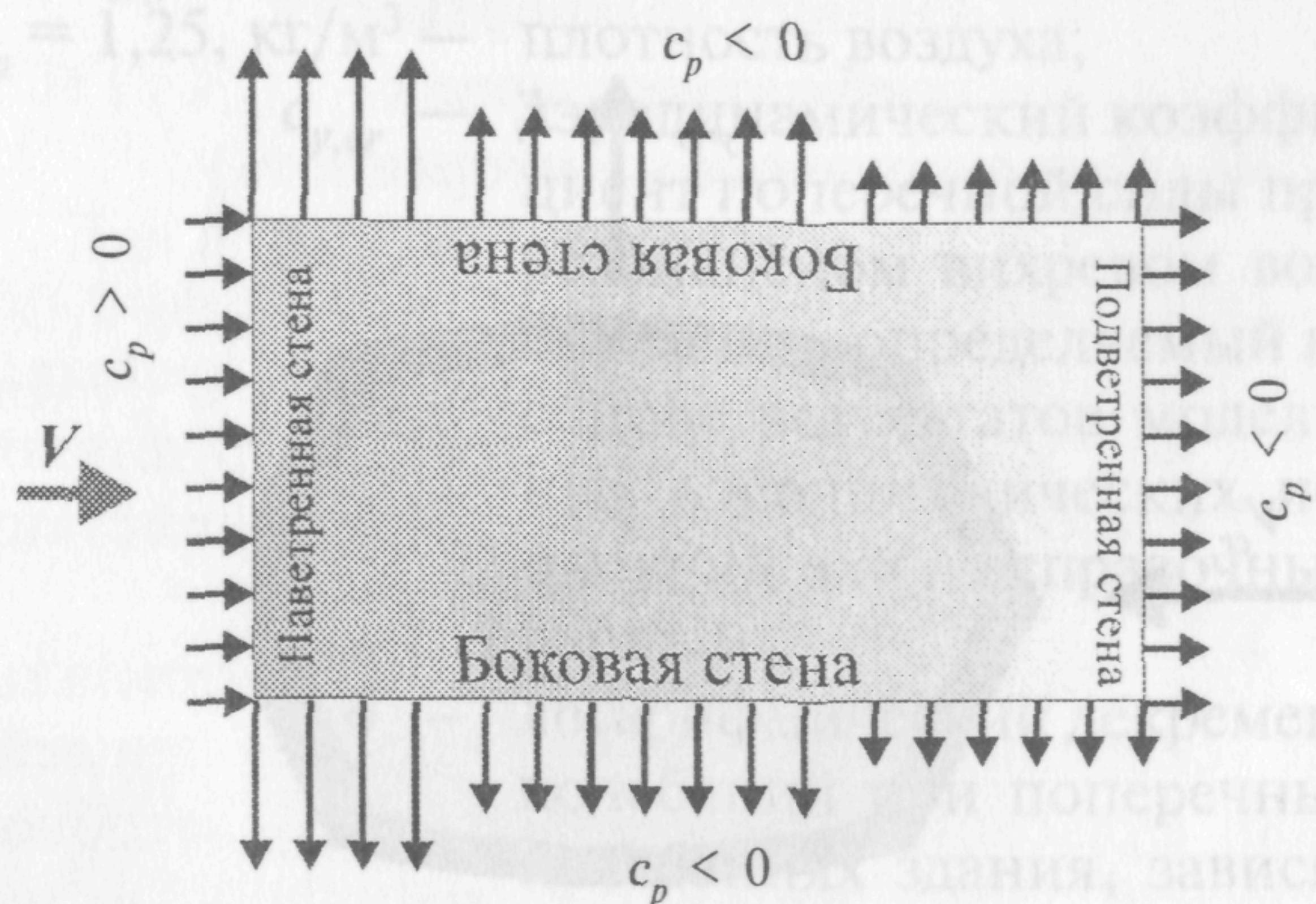
**Рисунок 4.3.** Общая схема распределения ветровой нагрузки по ограждающим поверхностям (стенам) здания
