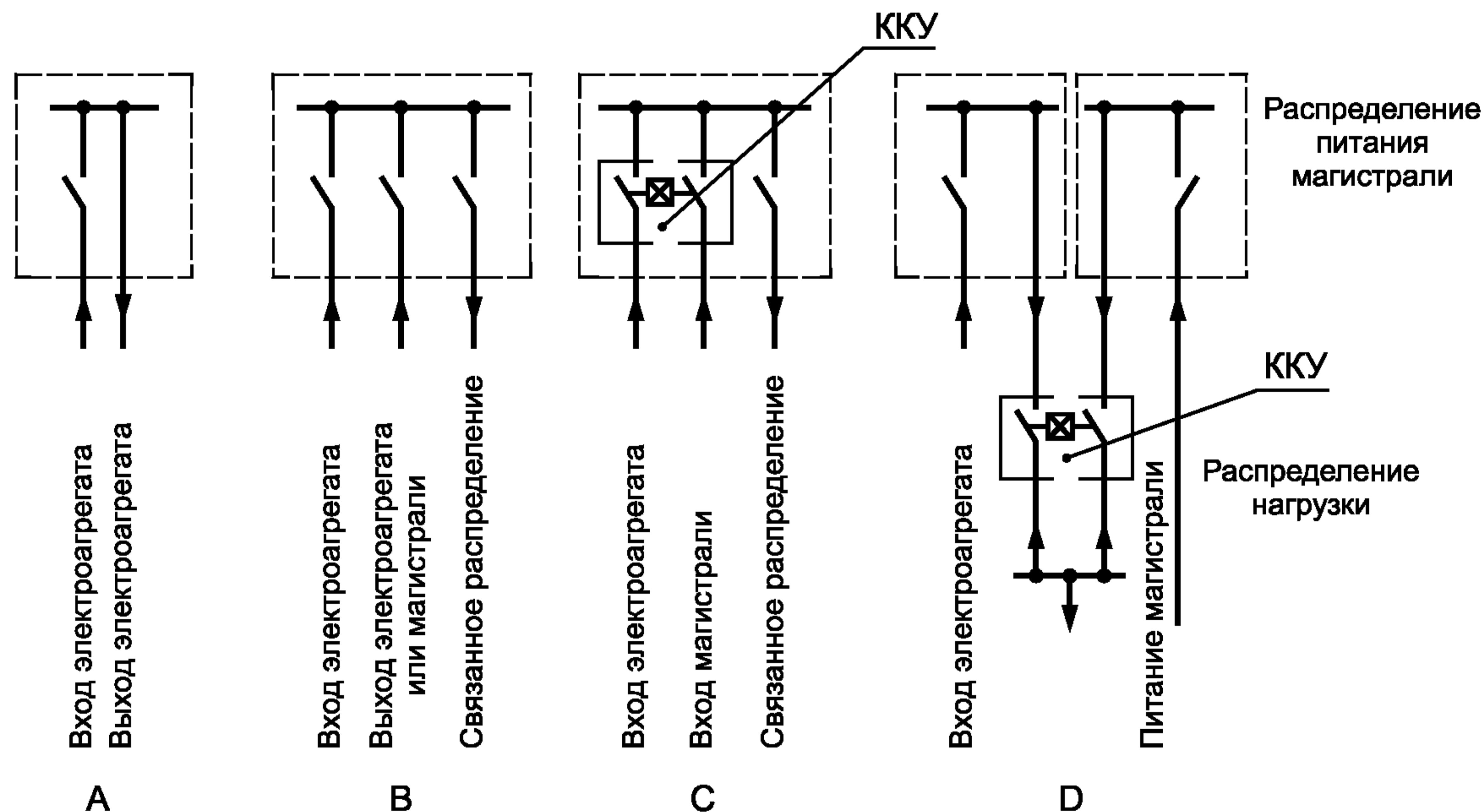
А — коммутационное устройство одночного электроагрегата;
