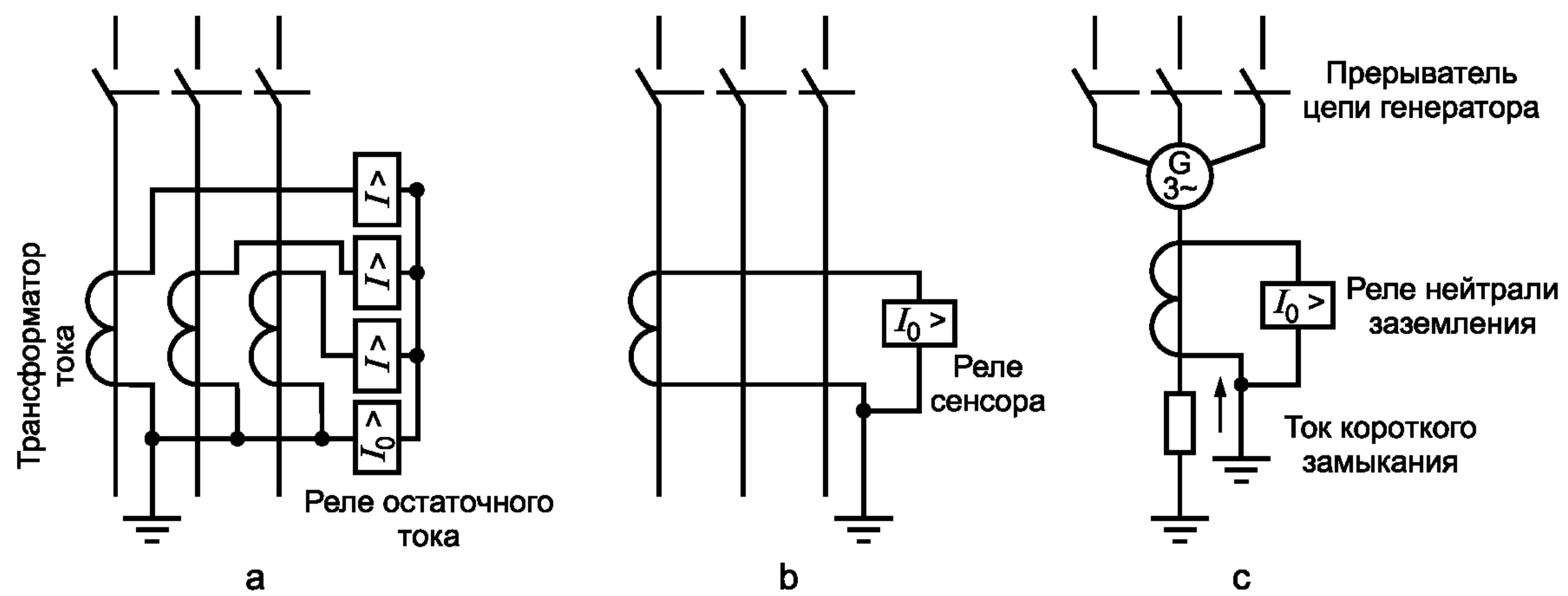
а — остаточная схема релейной защиты (не применяется для низковольтных четырехпроводных систем);
