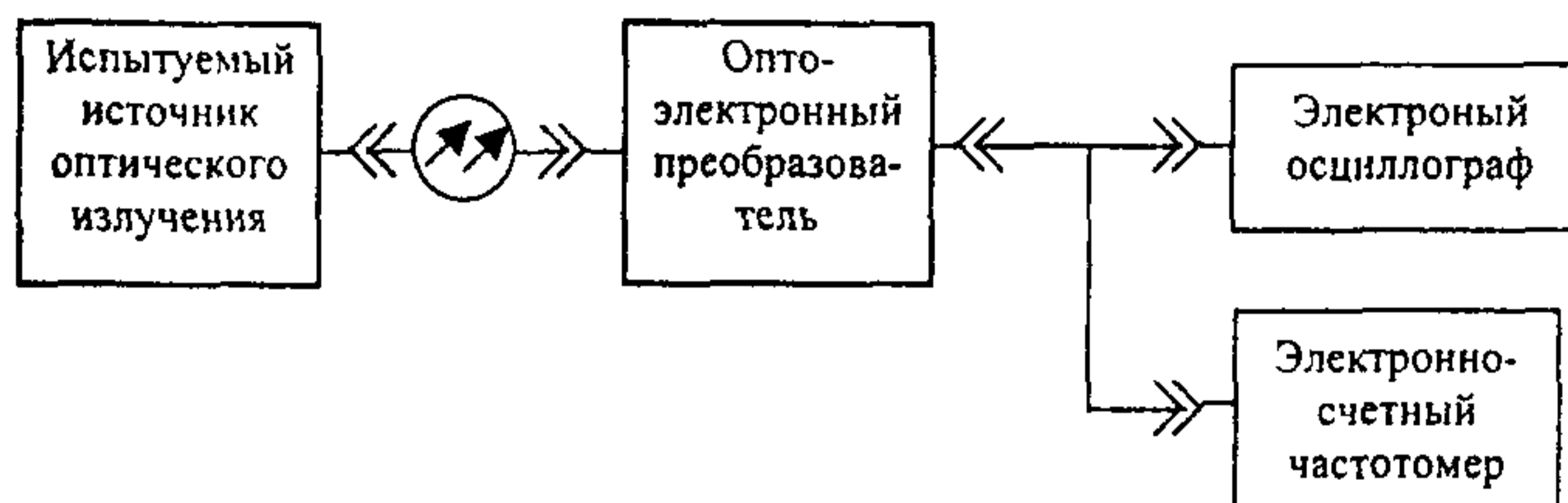
Рисунок 4 - Схема измерения амплитудно-временных параметров импульсно-модулированного сигнала
