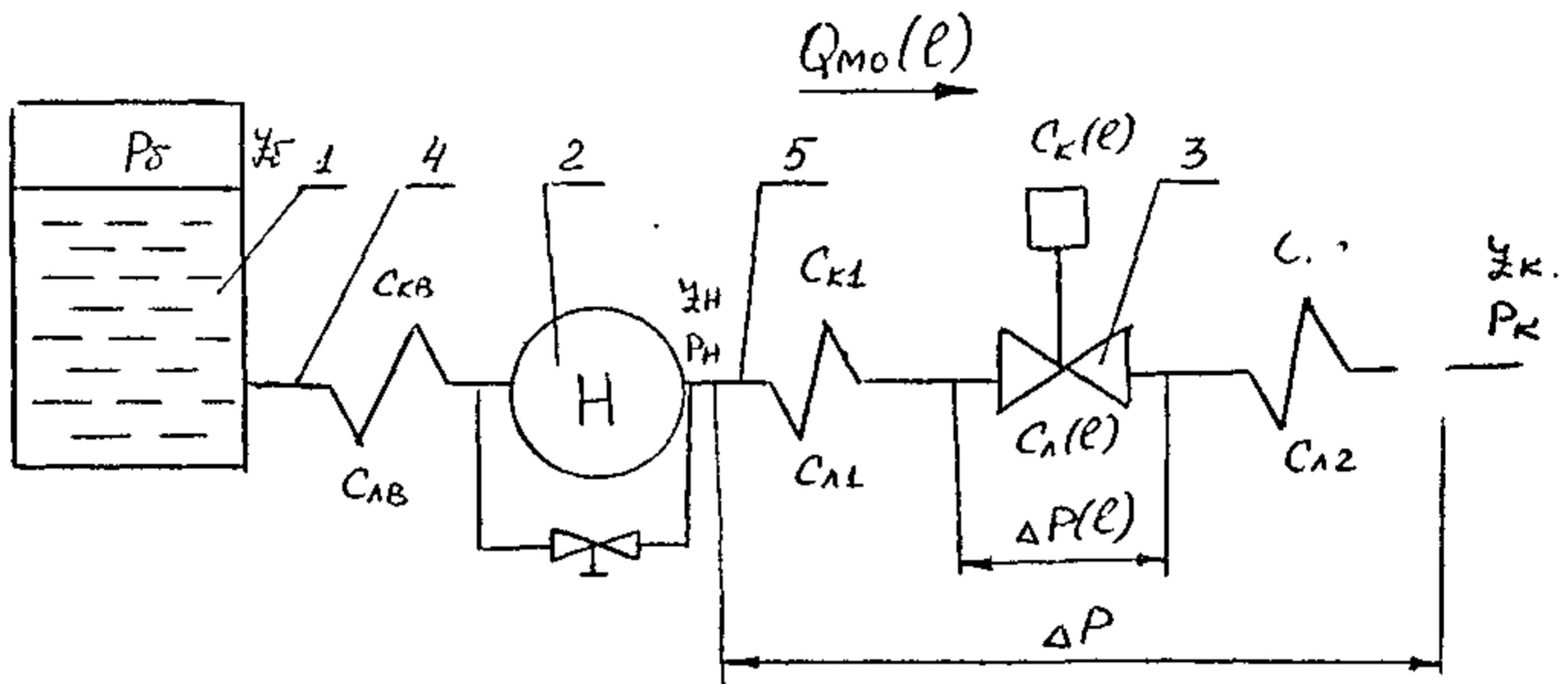
1 - бак; 2 - источник напора; 3 - РА; 4 - всасывающая линия ГС;
