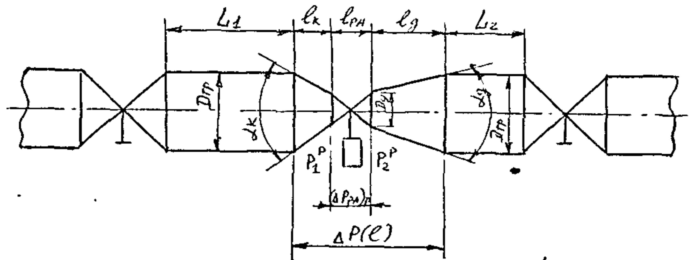
III вариант (Схема защиты РА от кавитации с помощью диафрагмы)
