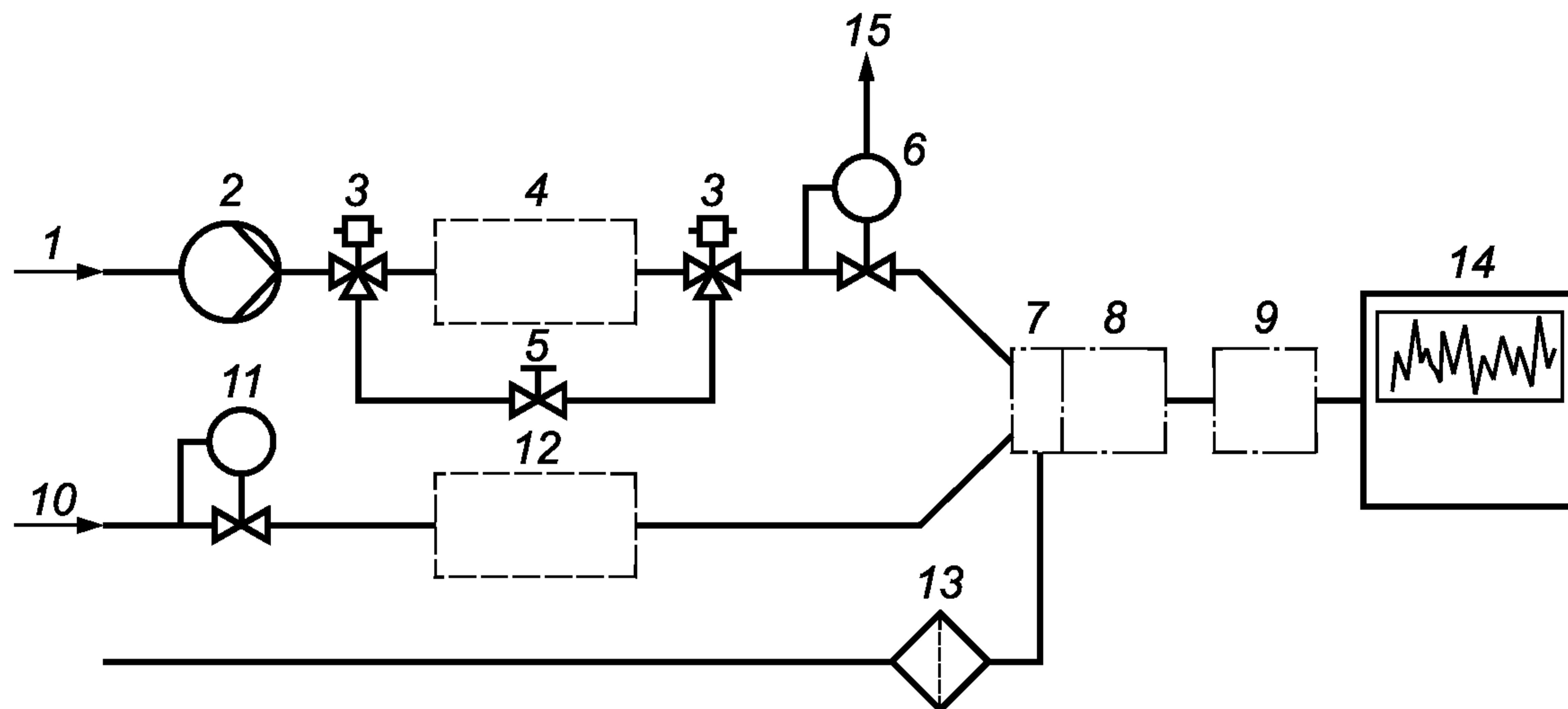
1 — ввод пробы; 2 — насос для прокачивания пробы; 3 — электромагнитный клапан; 4 — конвертер  $\text{NO}_2/\text{NO}$ ; 5 — регулятор потока; 6 — регулятор давления; 7 — реакционная камера; 8 — фотоумножитель; 9 — блок электронной обработки данных; 10 — ввод кислорода; 11 — регулятор давления; 12 — регулятор озона; 13 — фильтр для озона; 14 — блок регистрации данных; 15 — сброс газа
