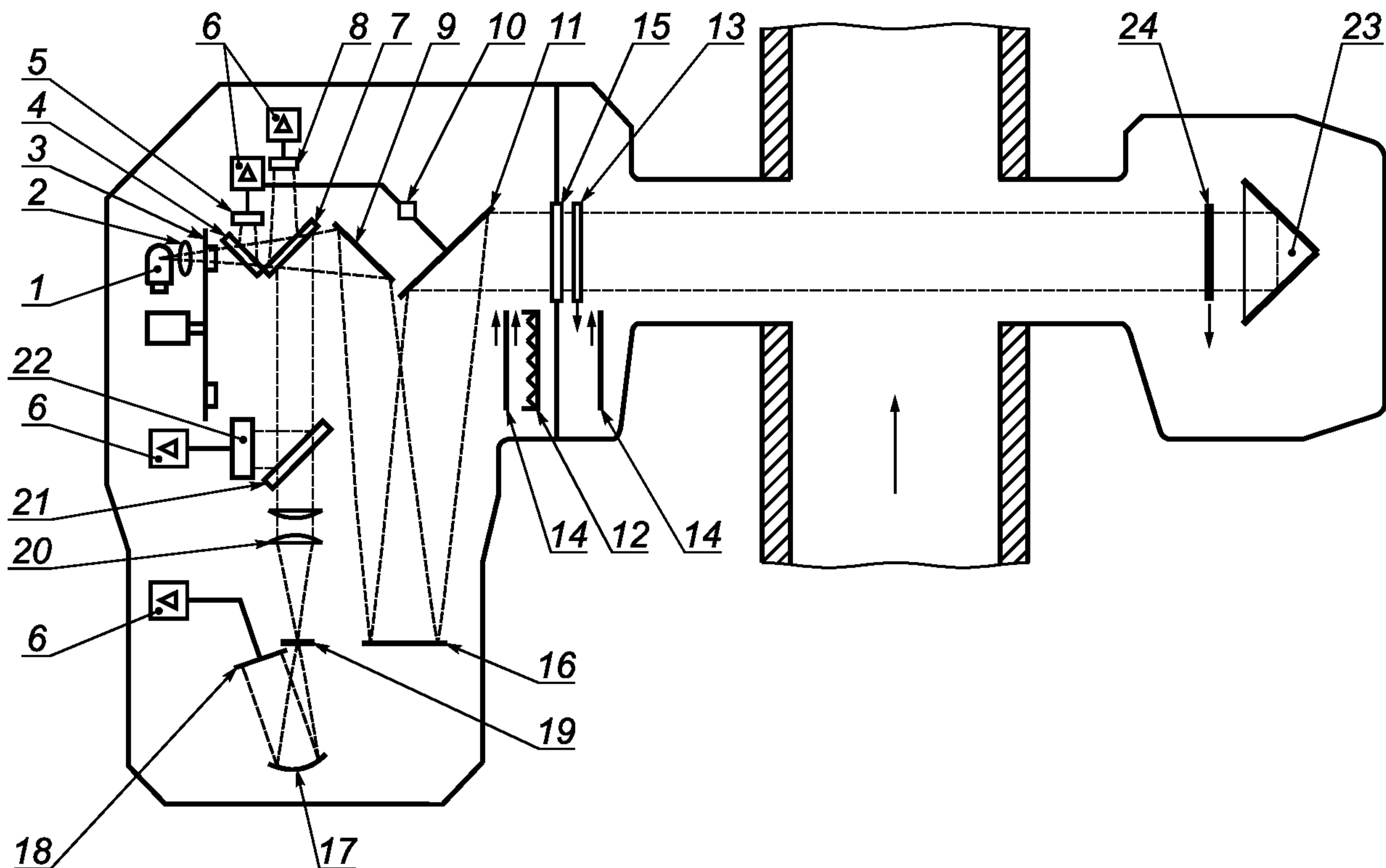
1 — дейтериевая лампа; 2 — конденсор; 3 — сменные и контрольные светофильтры; 4 — светоделительная пластина;
