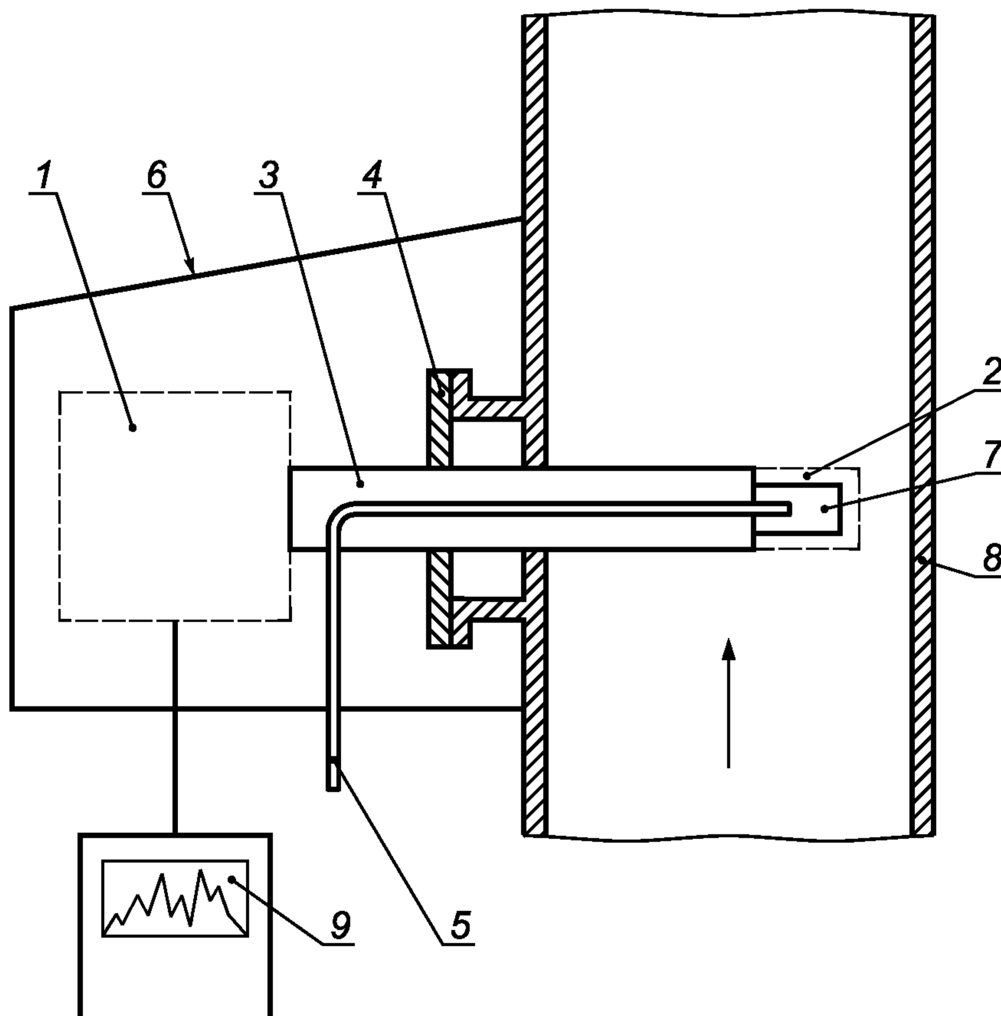
1 — приемопередающий блок; 2 — фильтр; 3 — зонд; 4 — крепление зонда; 5 — трубка для ввода калибровочного газа;
