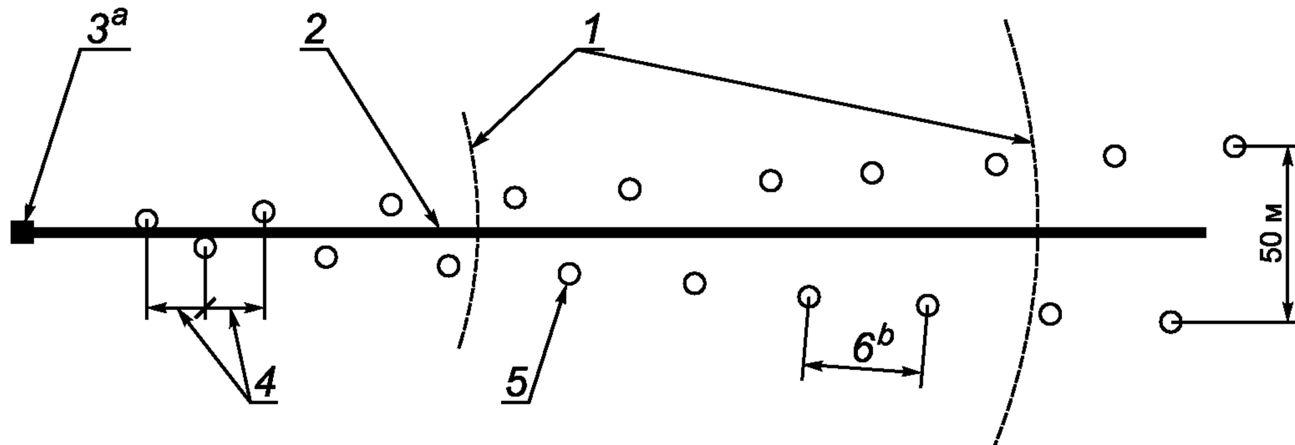
1 — следы колес; 2 — вращающийся трубопровод; 3 — ось вращения; 4 — смещение; 5 —  $i$ -й дождемер  $j$ -й линии (расположенный в шахматном порядке относительно другой линии); 6 — расстояние между дождемерами;
