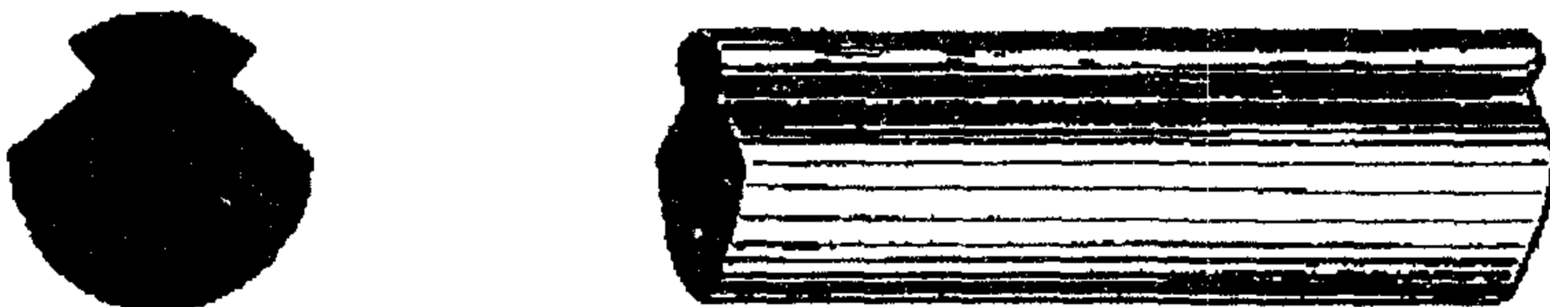
Рис 6 Внешний вид и сечение контактного провода
