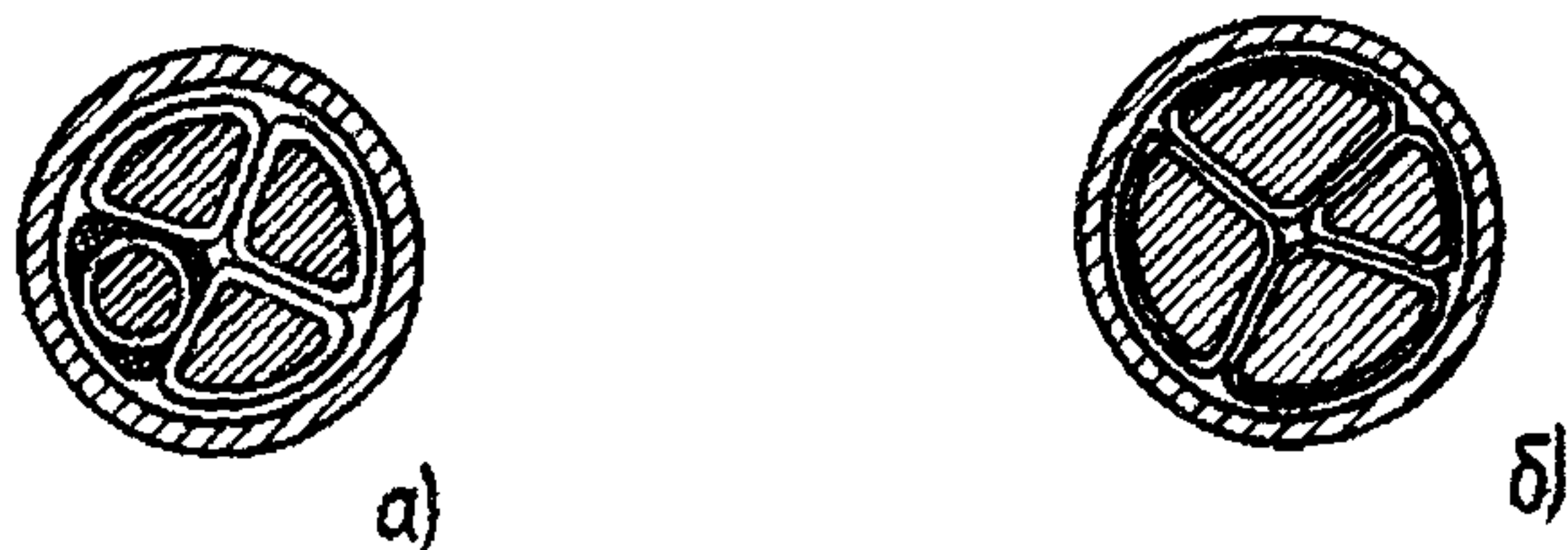
Рис. 1. Схема четырехжильных кабелей а - с секторными рабочими жилами и круглой нулевой жилой; б - с секторными жилами.
