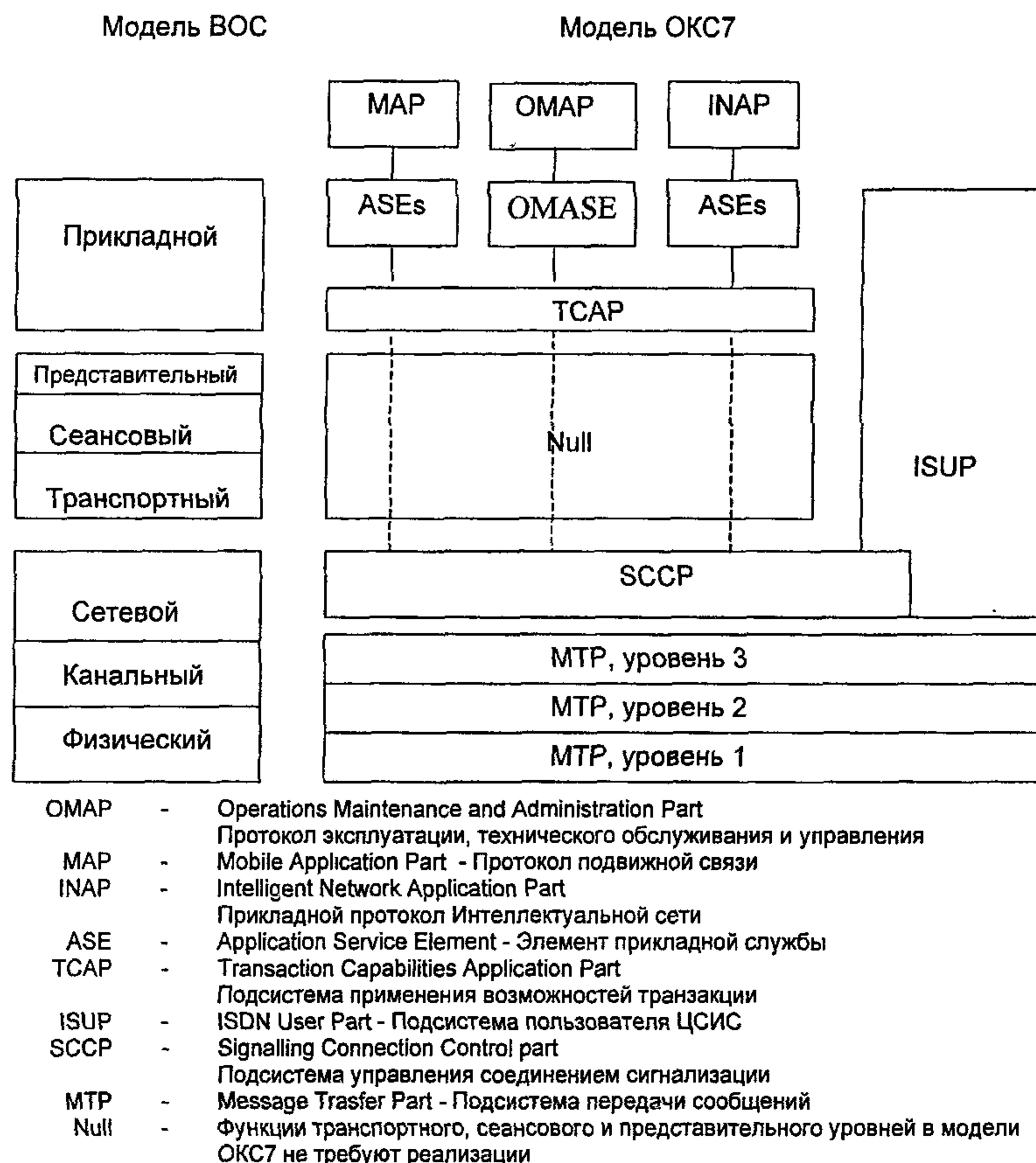
Рисунок 11.1 – Архитектура системы сигнализации ОКС7
