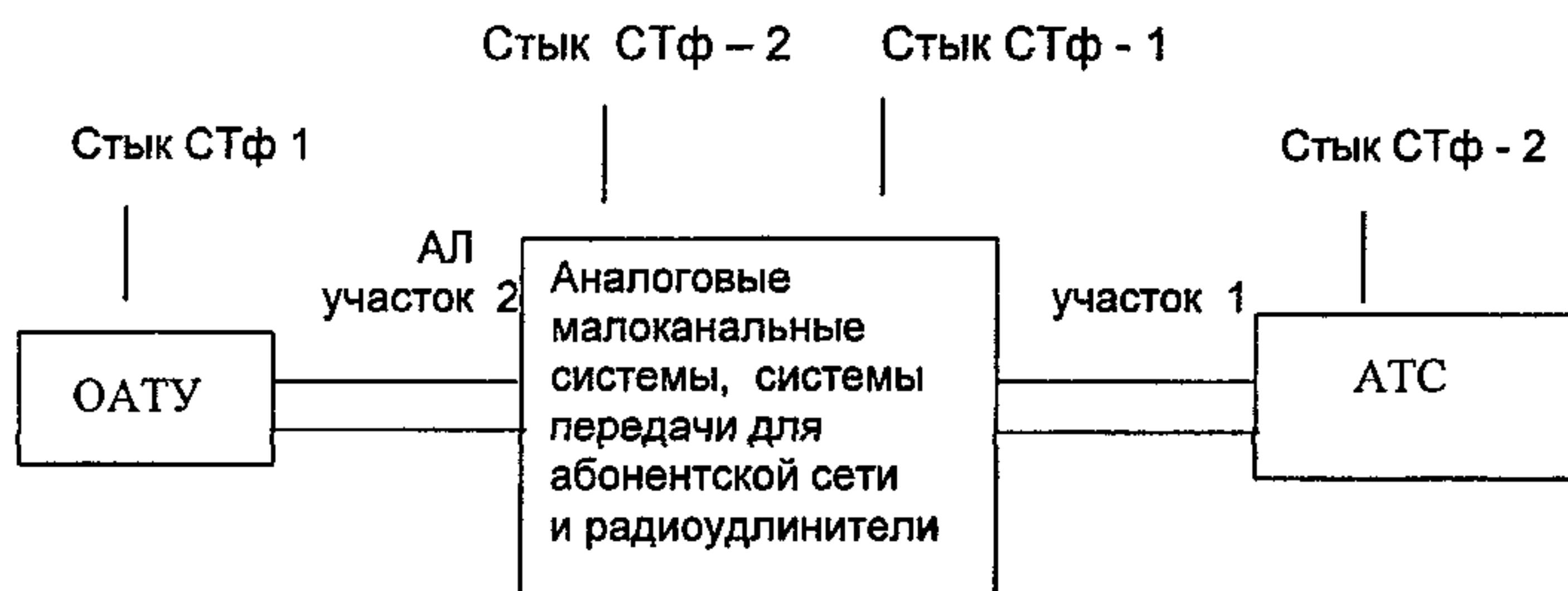
Рисунок 10.3 – Стыки на участке ОАТУ – АТС при использовании малоканальных систем передачи и радиоудлинителей
