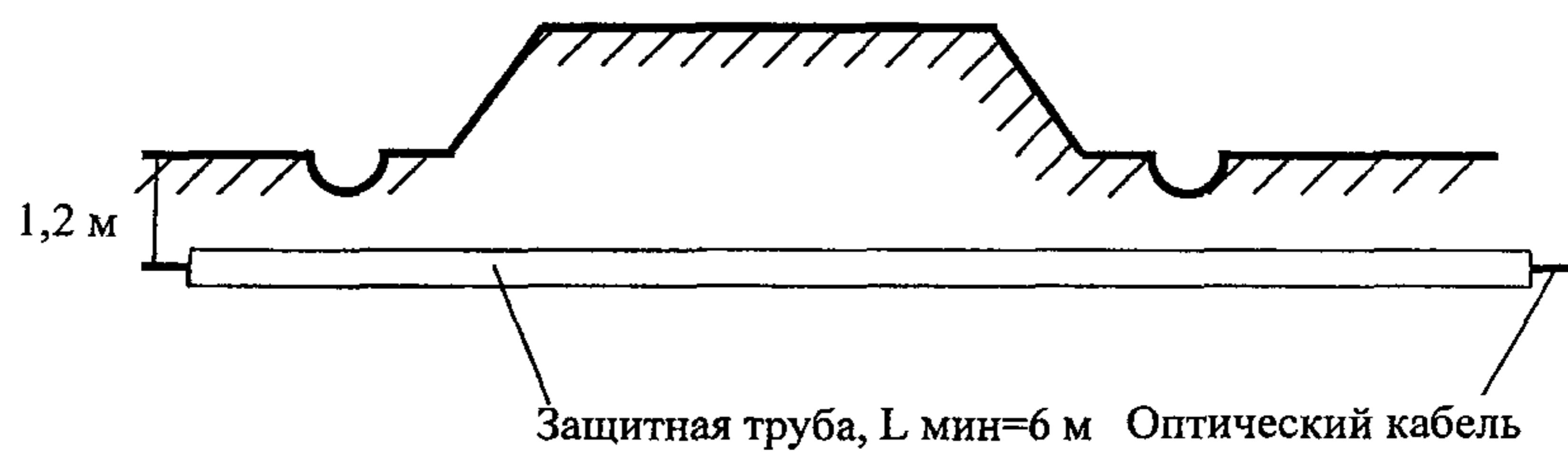
Рисунок В.1 - Прокладка ОК через автомобильную дорогу
