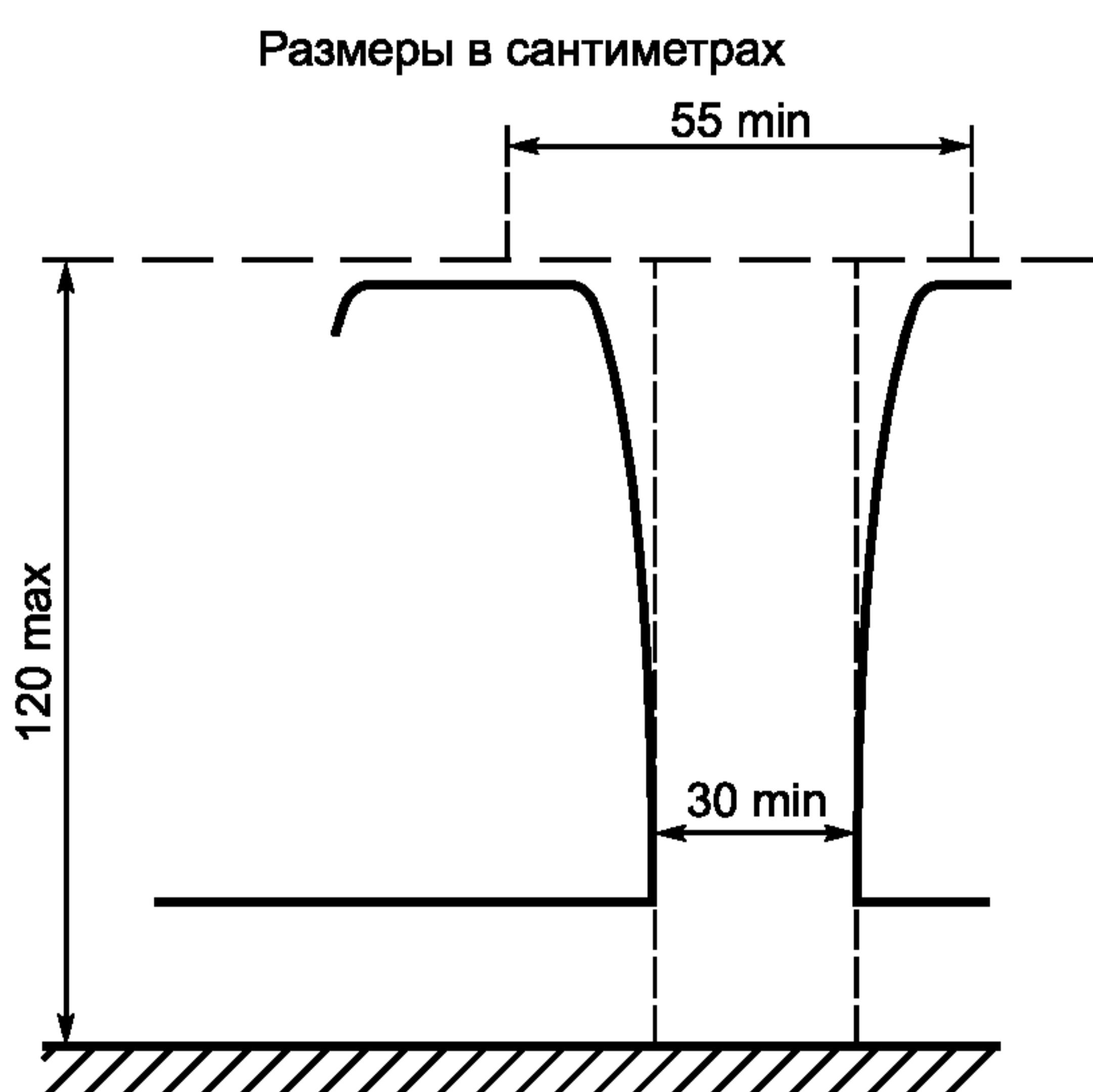
Рисунок 20 — Определение свободного доступа к двери (см. 5.7.1.10.2)
