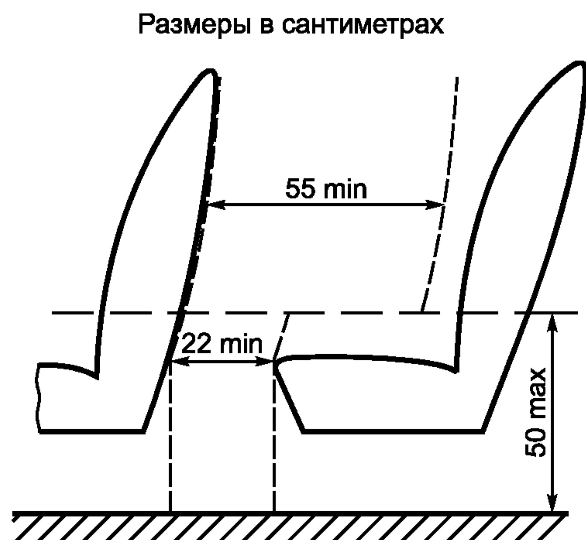
Рисунок 19 — Определение свободного доступа к двери (см. 5.7.1.10.1)
