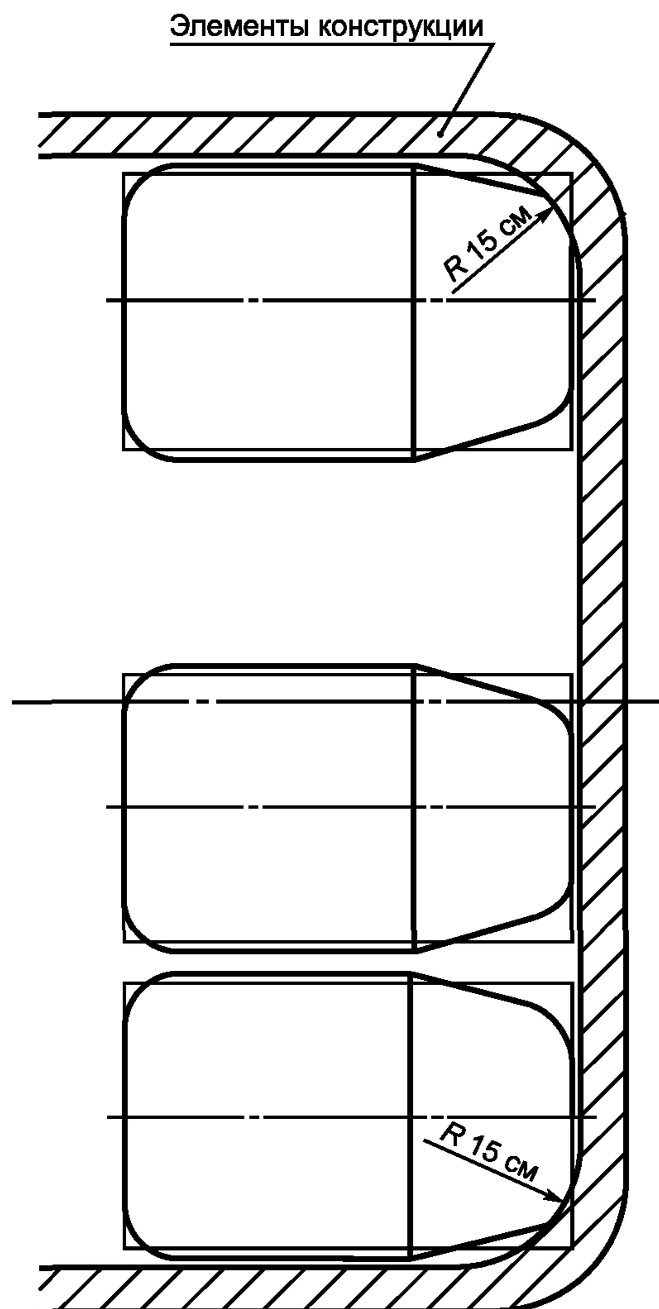
Рисунок 11 — Допустимое выступание конструкции в зону задних боковых сидений.
