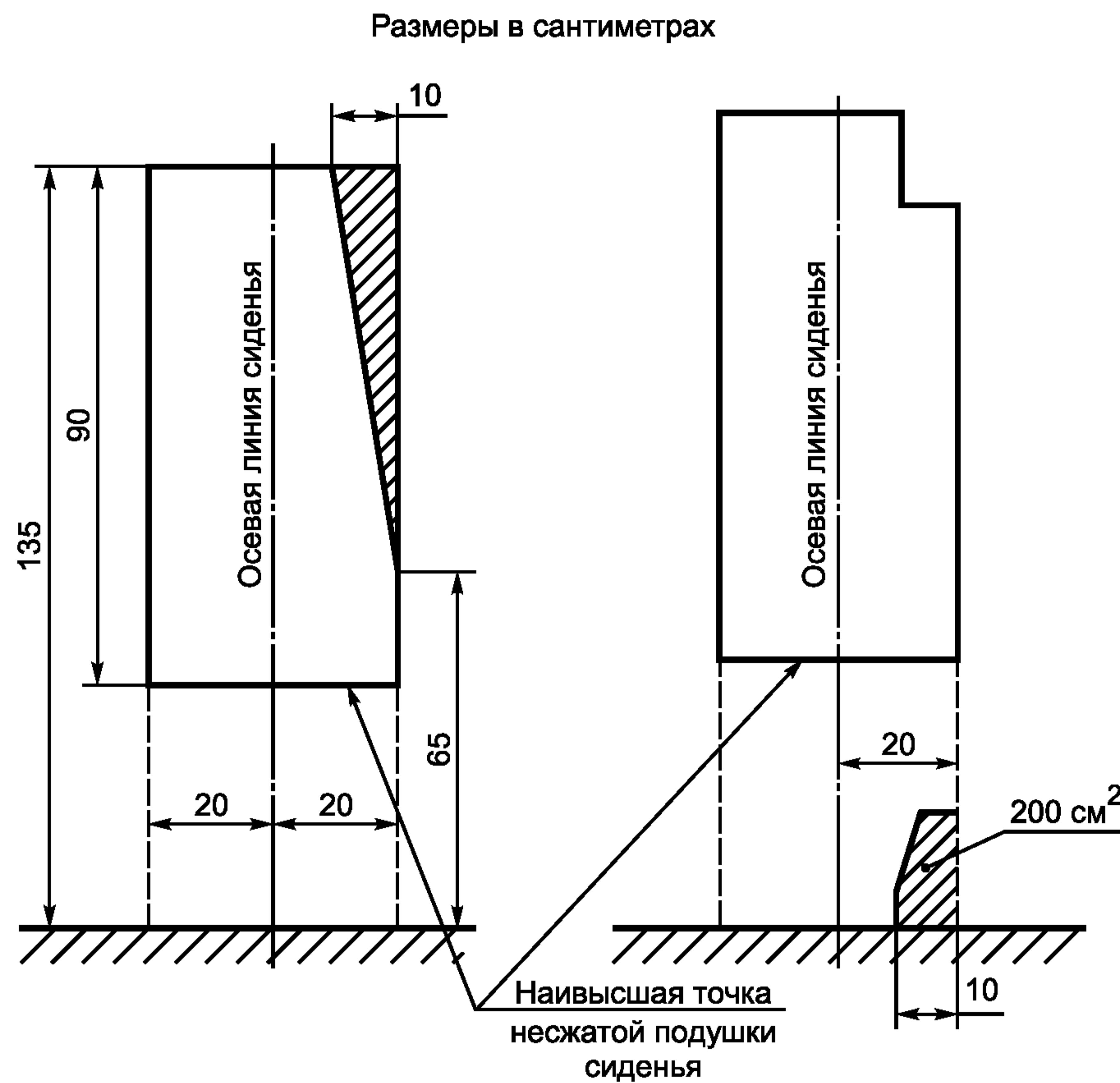
**Рисунок 8 — Допустимый выступ в нижней части пространства, отведенного для пассажиров (см. 5.7.8.1.3.3)**
