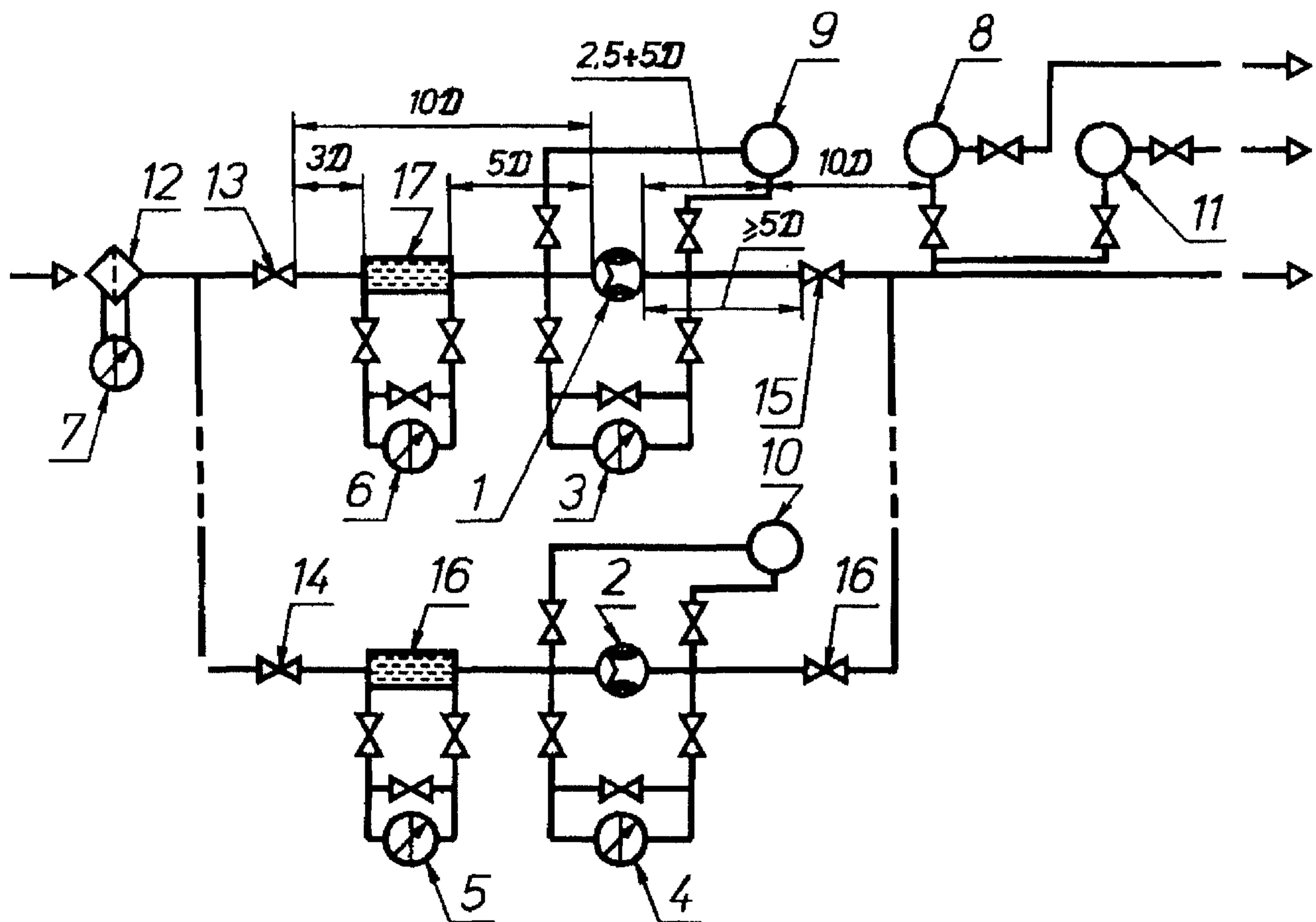
1, 2 — счетчики; 3, 4, 5, 6 — дифманометры; 8 — хроматограф; 9, 10 — плотномеры для рабочих условий; 11 — плотномер для стандартных условий; 12 — фильтр; 13, 14, 15, 16 — гидравлические сопротивления; 17 — струевыпрямитель
