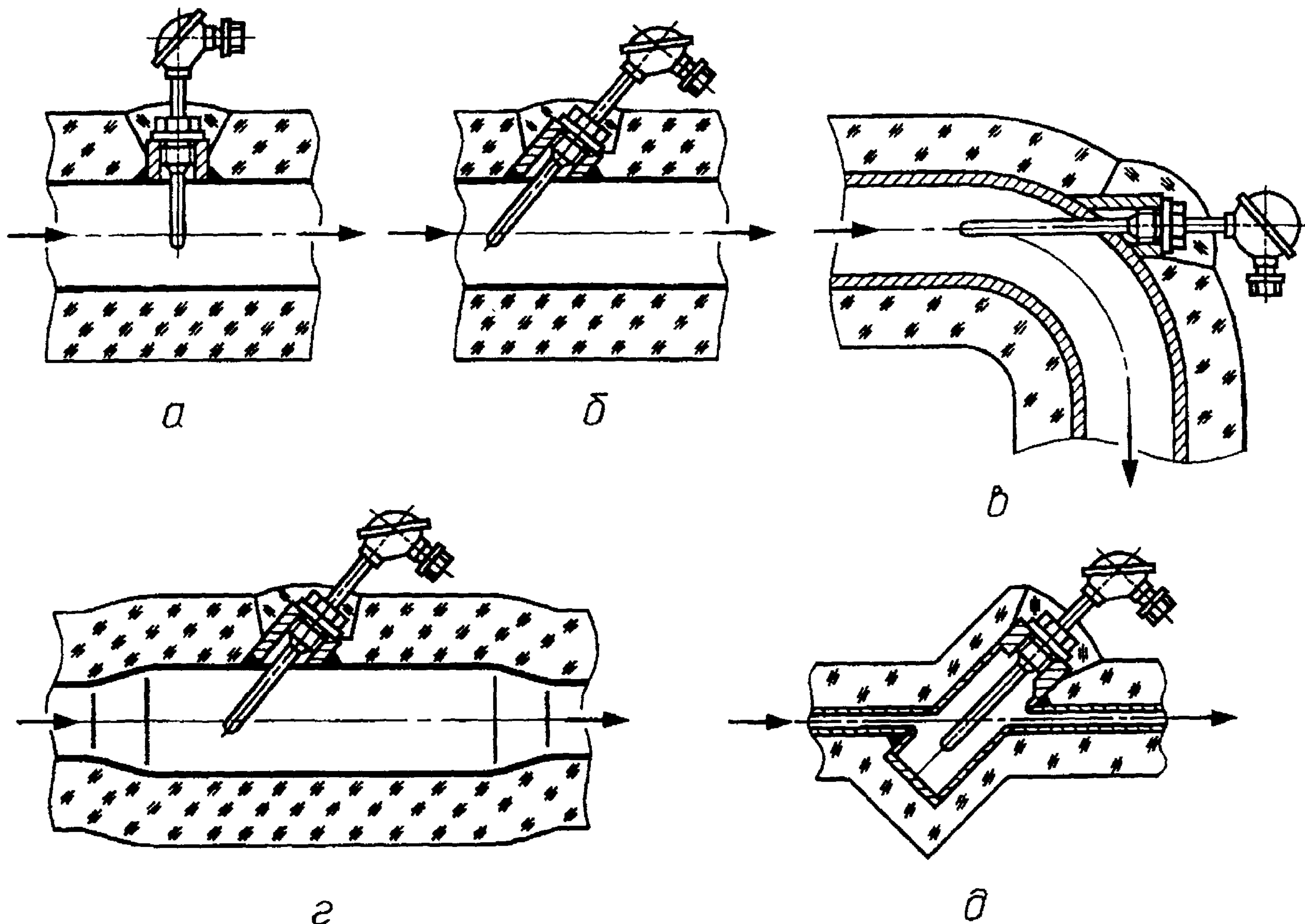
Расположение термометра: а — радиально; б — наклонно; в — в изгибе колена; г, д — в расширителе
