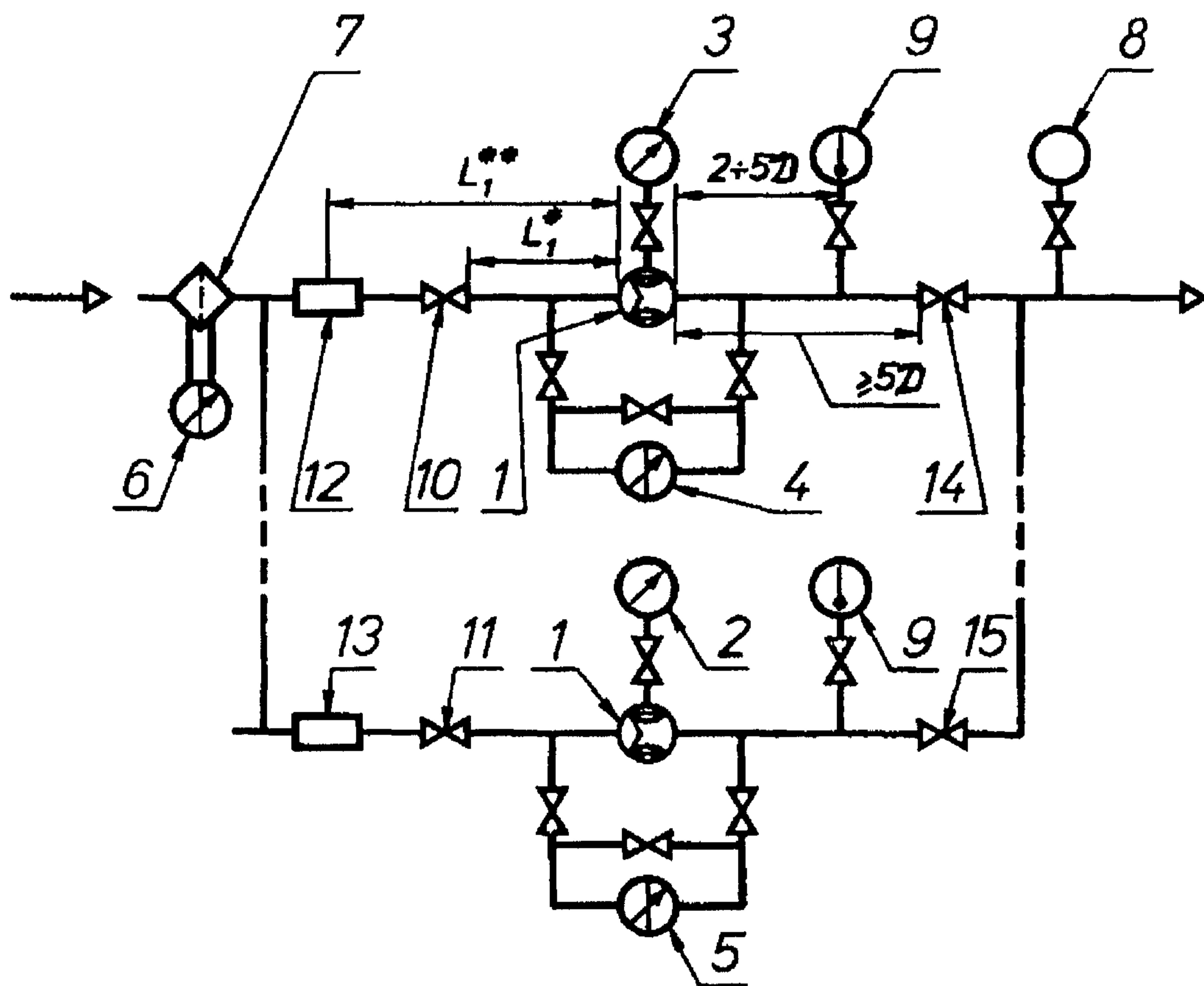
1 — счетчики; 2, 3 — манометры; 4, 5, 6 — дифманометры; 7 — фильтр очистки газа; 8 — хроматограф состава газа; 9 — термометры; 10, 11, 12, 13, 14, 15 — гидравлические сопротивления;  $L^{**}$ ,  $L^*$  — длины прямолинейных участков трубопроводов;  $L^{**}$ ,  $L^*$  — определяется в соответствии с 6.2.2.5
