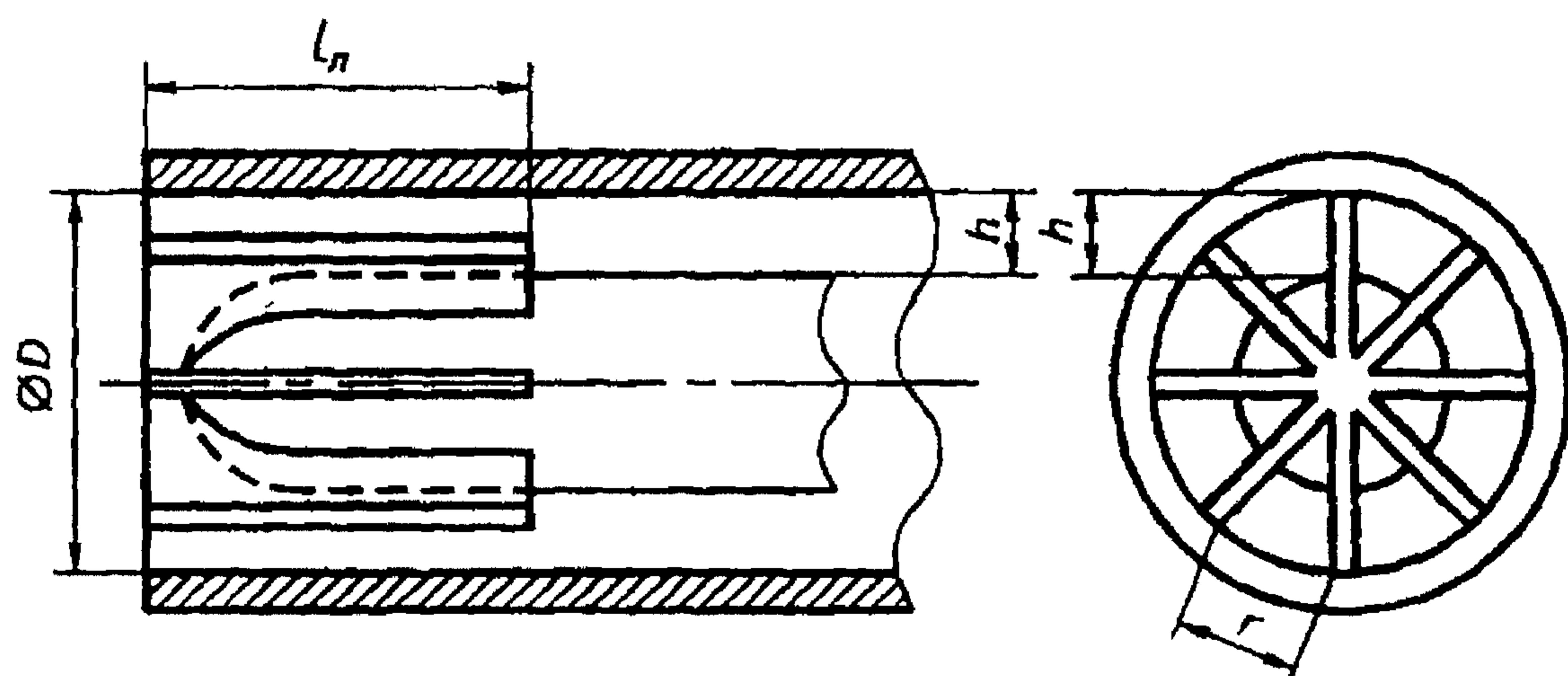
$D$  — внутренний диаметр счетчика;  $h$  — высота спрямляющих лопастей;  $l$  — длина спрямляющих лопастей;  $r$  — расстояние между спрямляющими лопастями
