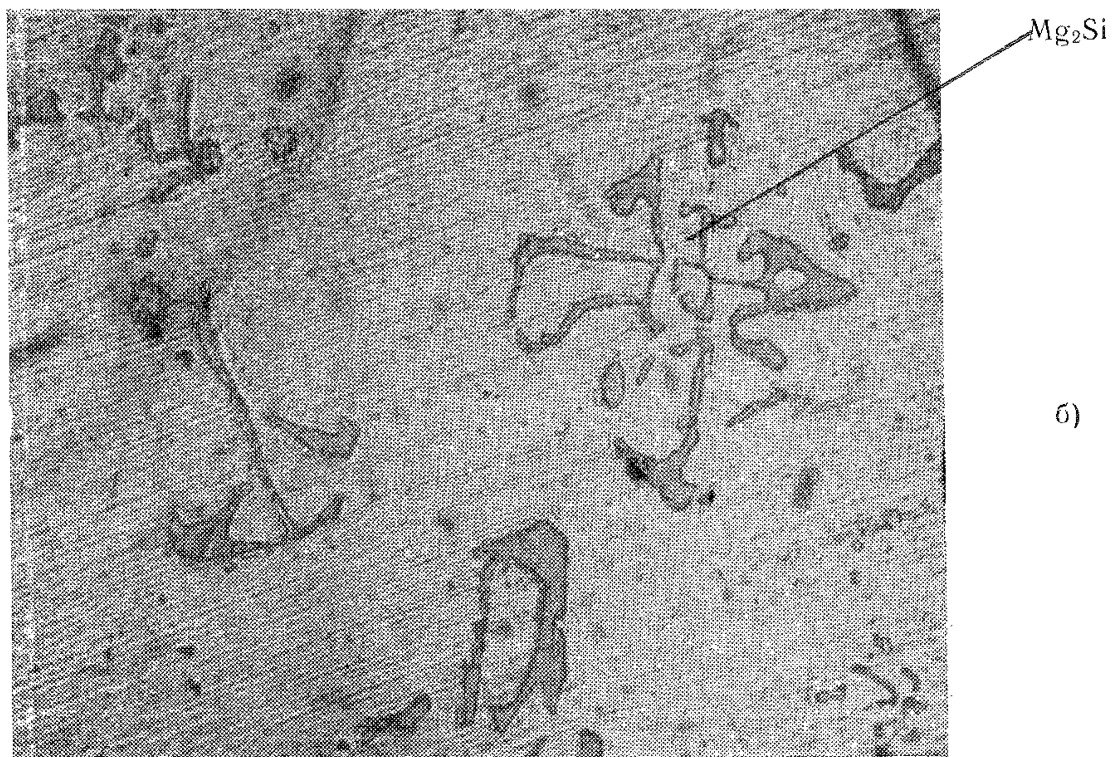
Рис. 3 Сплав МЛ5, МЛ5пч МЛ5оп. Состояние Т4 (Закален- ный) а — травление в реактиве № 1, \times 200 ; б — без травления, \times 500
