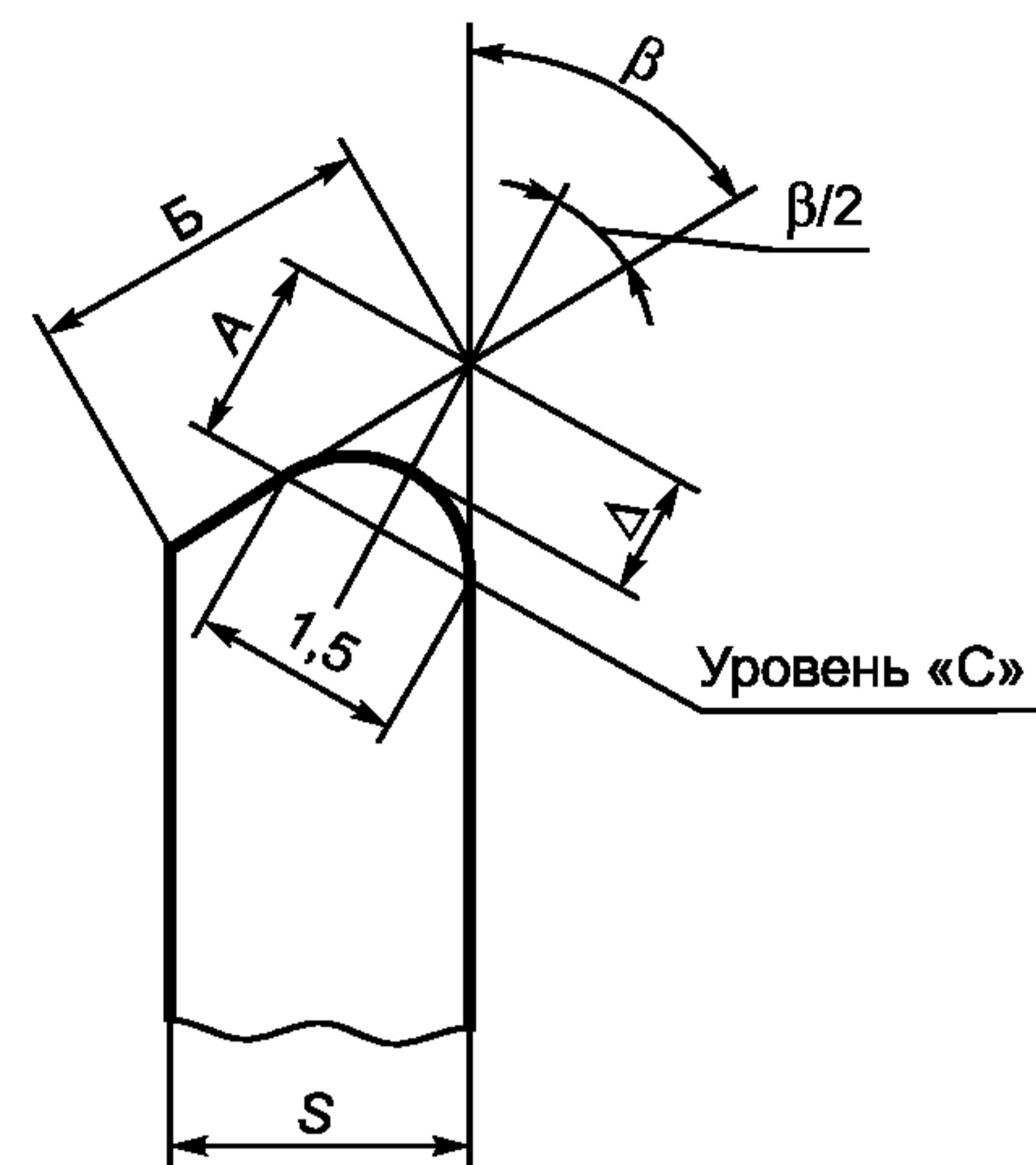
Рисунок А.2 — Схема измерения износа режущих кромок фрез
