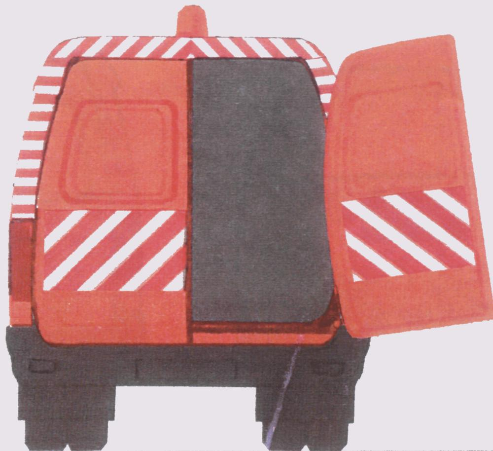
Рисунок Б.4 - Дорожная машина на базе микроавтобуса ГАЗ
