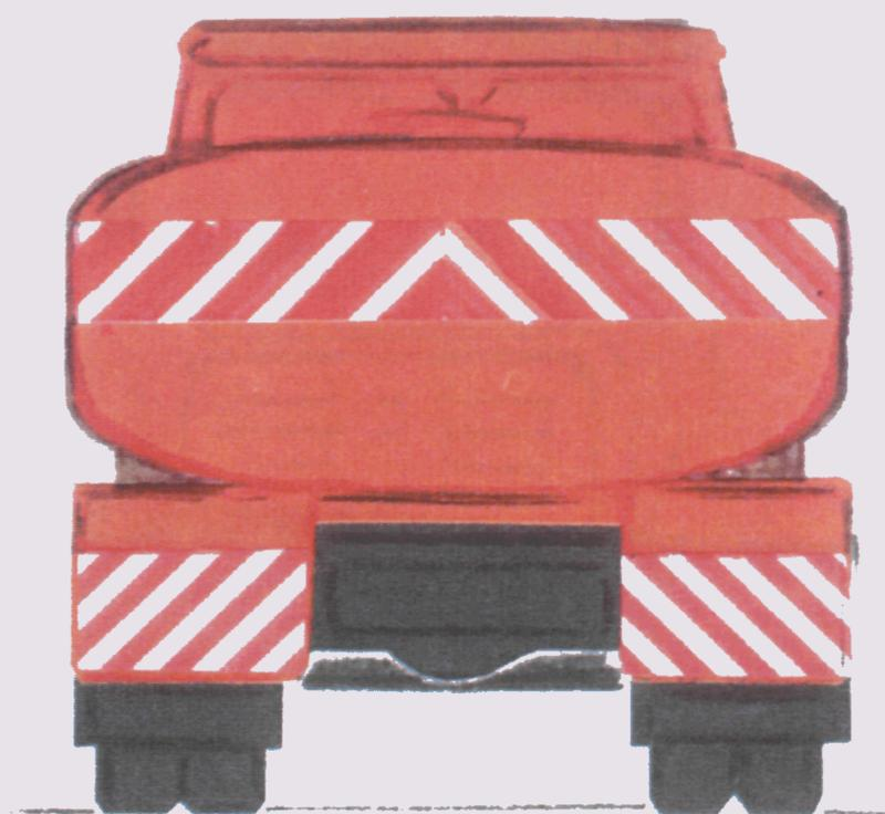
Рисунок Б.10 - Комбинированная дорожная машина на автомобильном шасси ЗИЛ (летний вариант)
