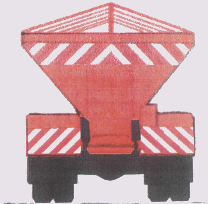
Рисунок Б.9 - Комбинированная дорожная машина на автомобильном шасси КАМАЗ (зимний вариант)
