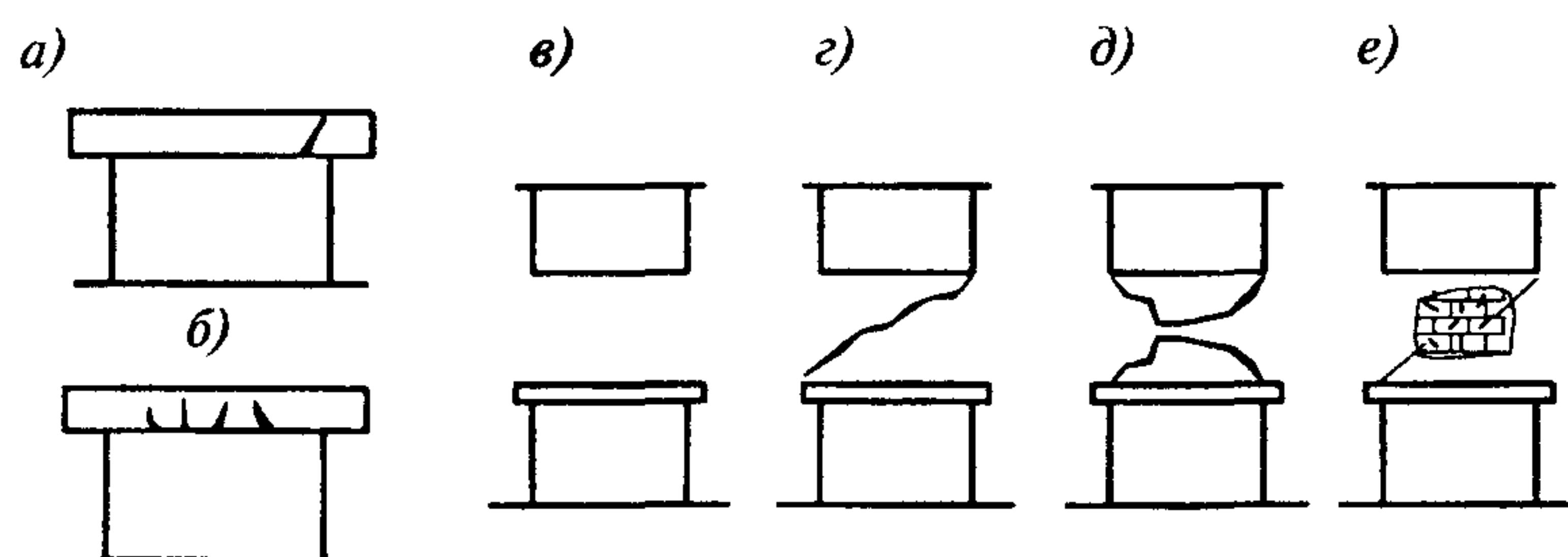
*a, b* — повреждение перемычки, *c-e* — повреждение кладки под перемычкой
