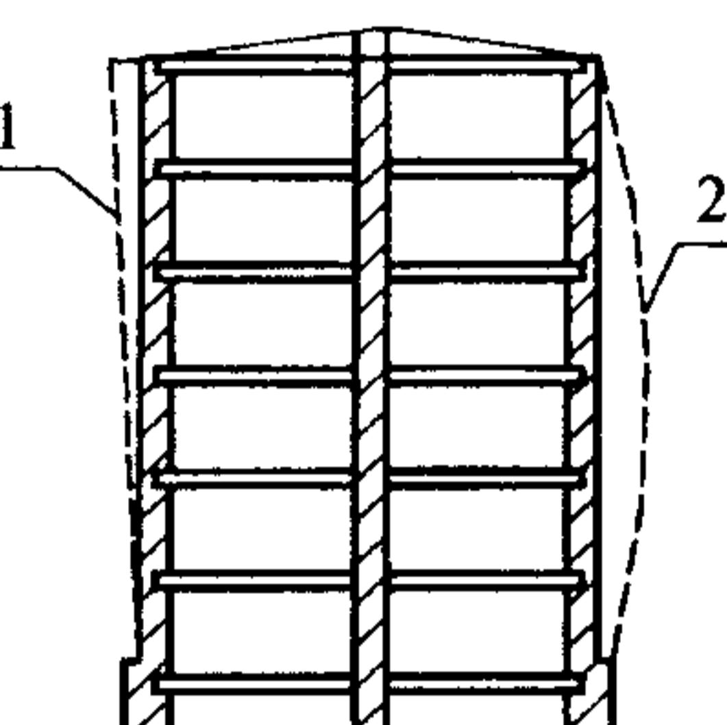
**Рисунок 9.2** — Схема отрыва продольных несущих стен от поперечных конструкций здания
