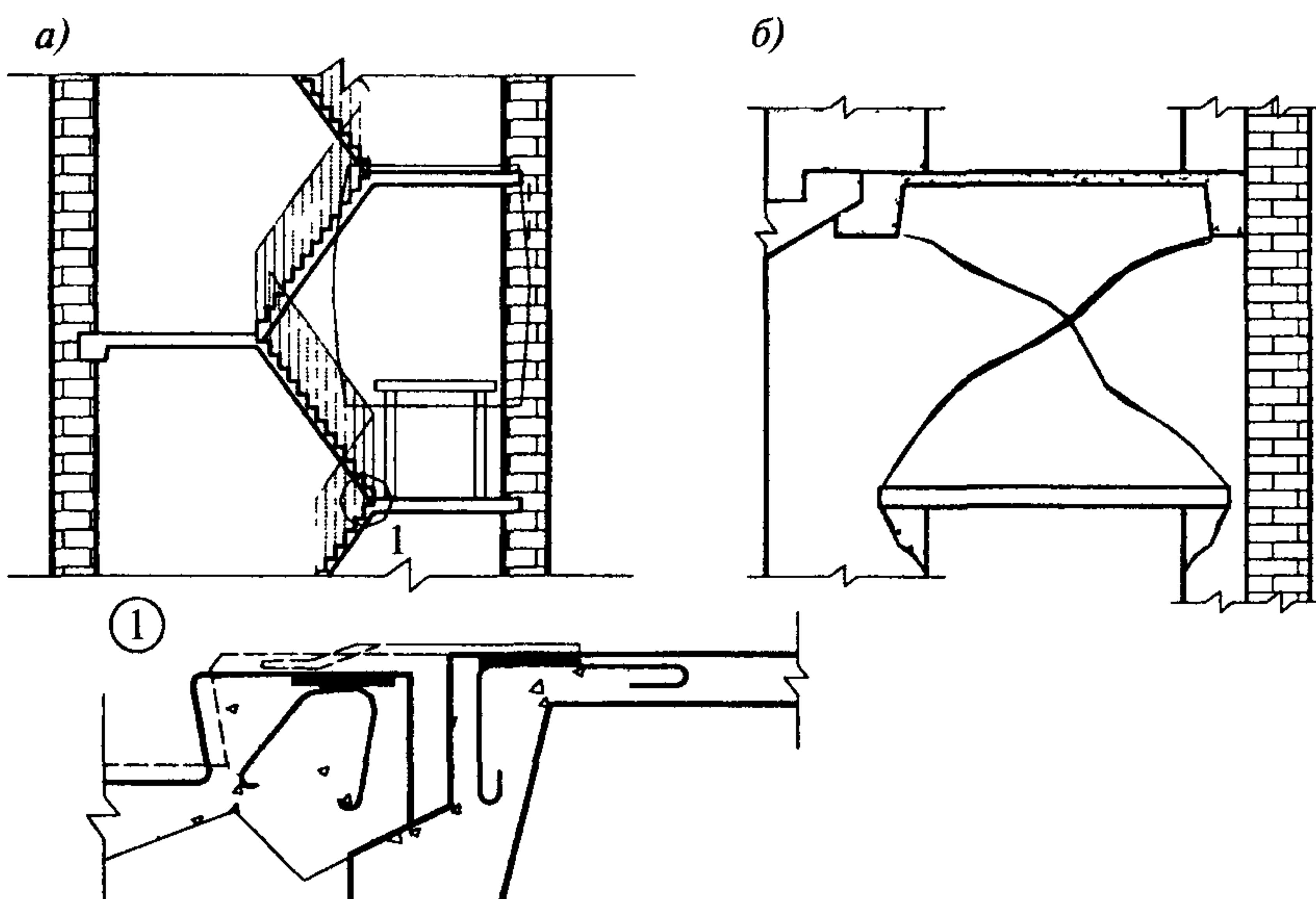
*a* — основные места повреждений кладки и конструкций лестниц; *b* — повреждение над дверным проемом
