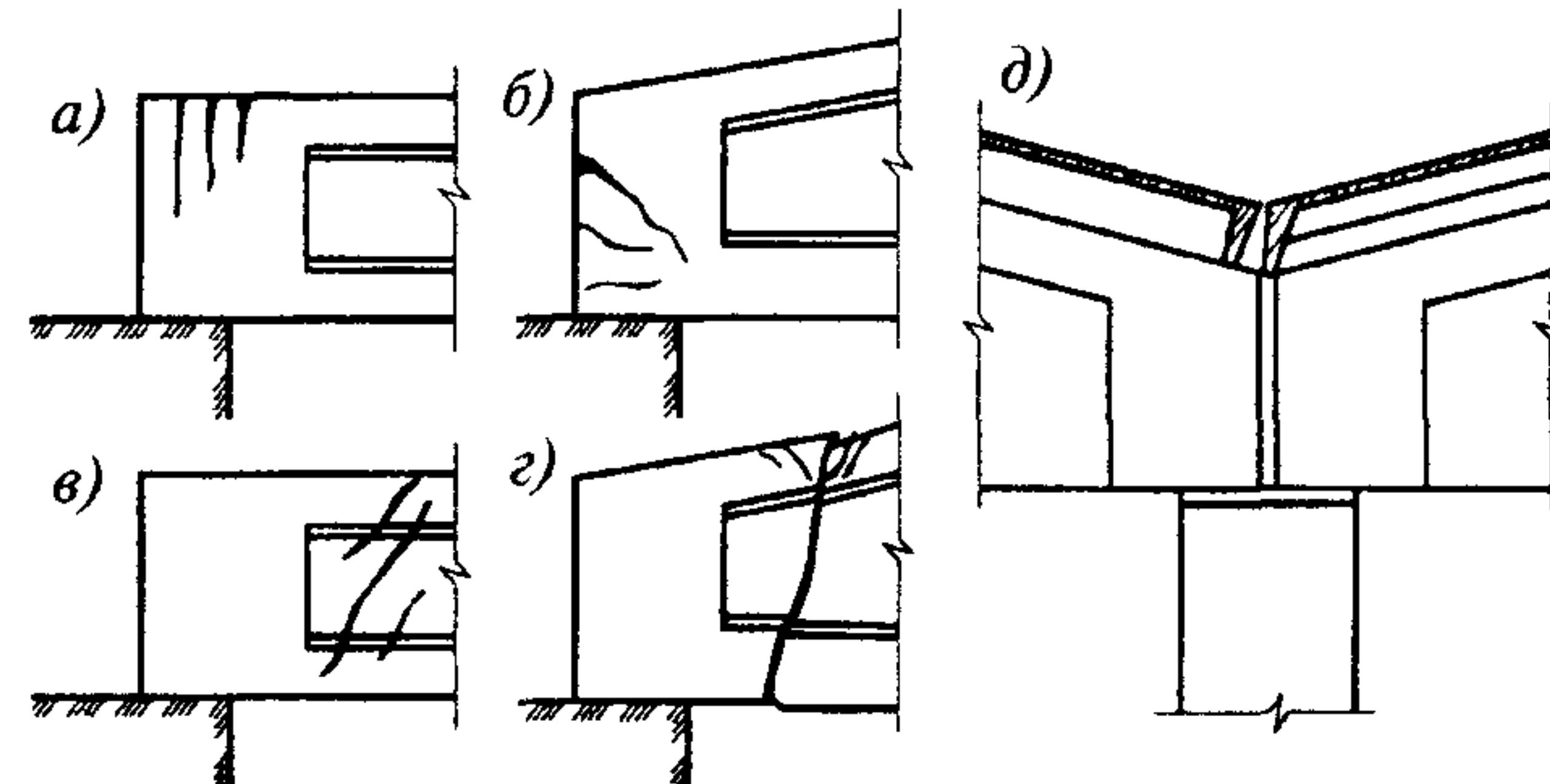
а, б — трещины, вызванные недостаточным армированием торца балки, жестко закрепленной на опоре; в, г — трещины в балке с недостаточной площадью сечения отогнутой или поперечной арматуры; д — смещение плит покрытия
