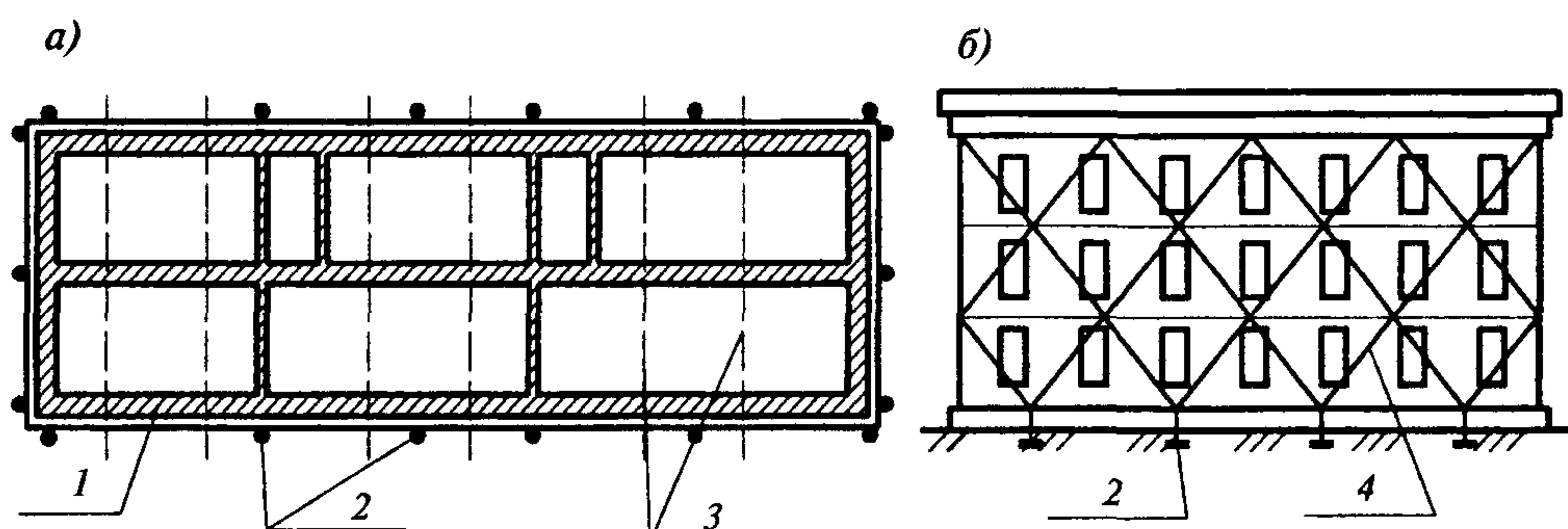
*a* — расположение элементов каркаса на плане здания; *б* — вариант схемы размещения каркаса по наружным стенам;
