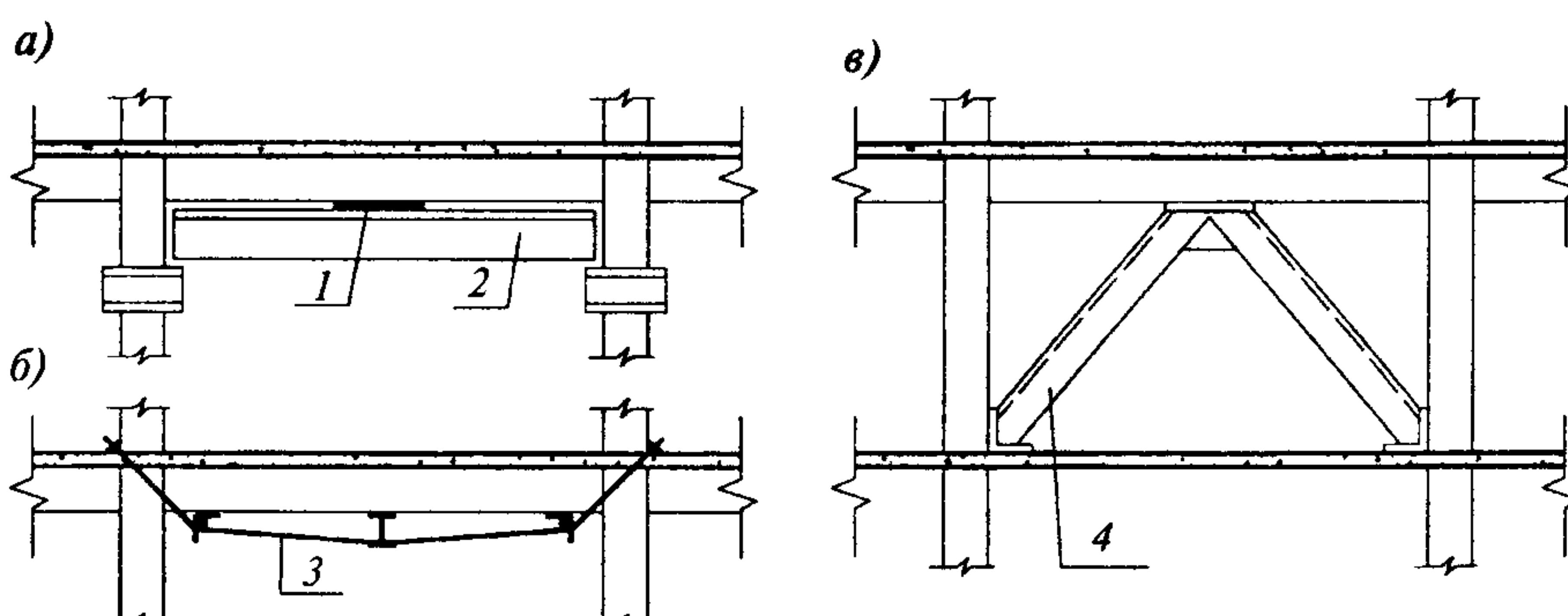
а — усиление с помощью балки, б — усиление шпренгельной конструкцией, в — усиление разгружающими рамами, 1 — клин, 2 — балка, 3 — шпренгель, 4 — разгружающая рама
