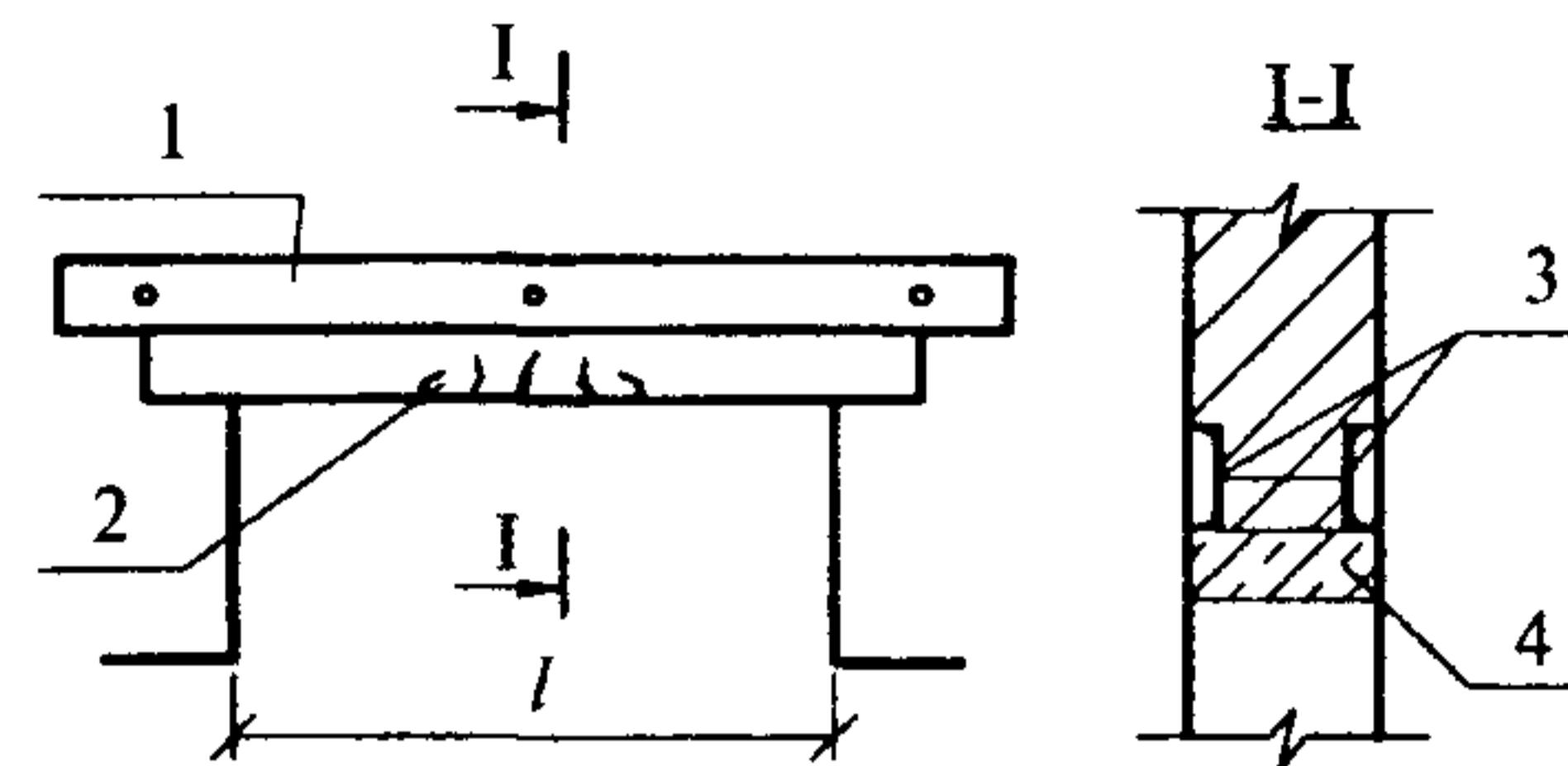
1 — разгрузочная балка; 2 — поврежденная перемычка; 3 — швеллер; 4 — поврежденная несущая перемычка длиной  $l$
