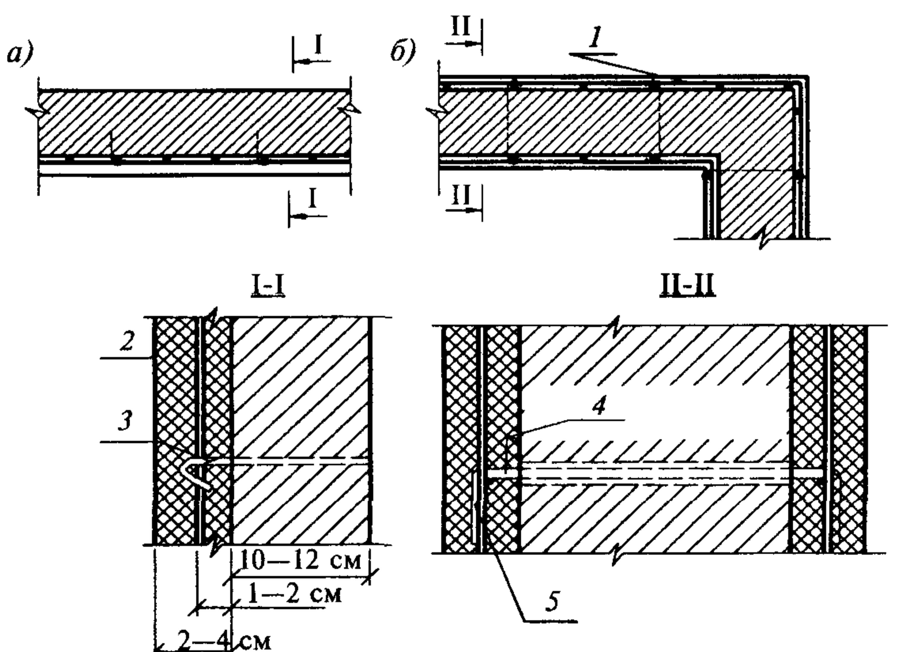
Таким методом можно надежно усилить как угодно сильно разрушенный, но не потерявший устойчивости участок стены. Способность такой комплексной конструкции воспринимать сдвигающие усилия  $Q_{cd}$  от сейсмической нагрузки определяется площадями сечения кладки  $F_{kl}$ , нанесенного бетонного или песчаноцементного слоя  $F_{cl}$ , общего сечения арматуры одного направления  $F_{ap}$  и определяется зависимостью
