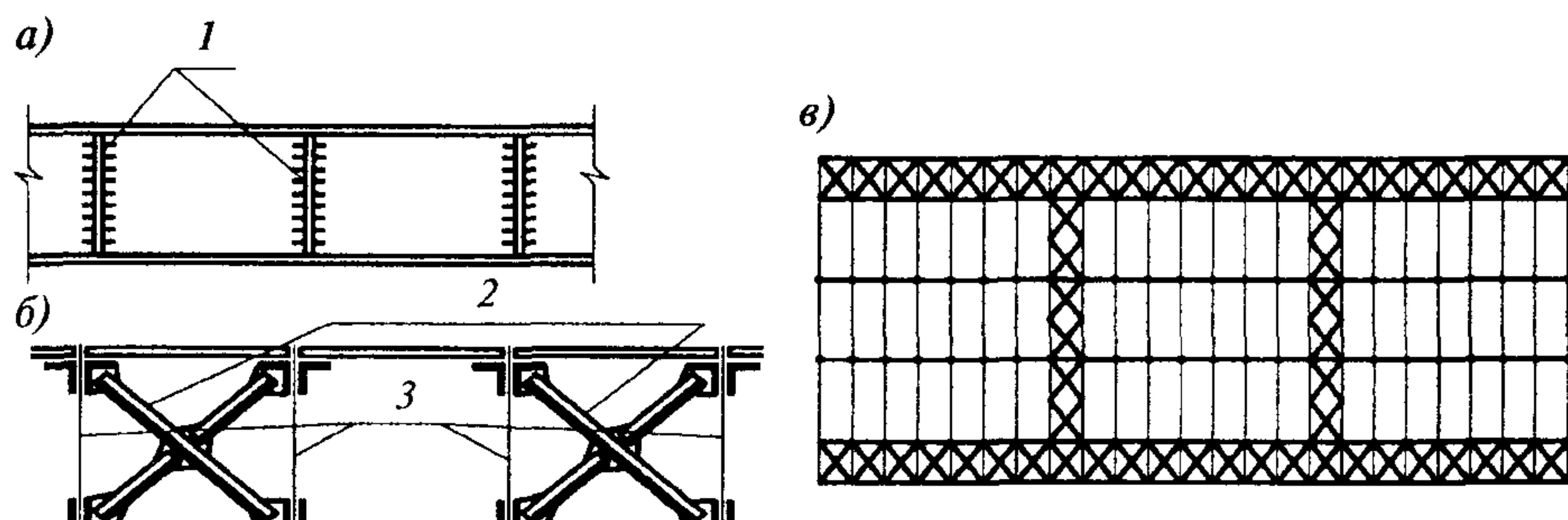
*а* — увеличение пространственной жесткости балки усиливающими ребрами, *б* — усиление ферм покрытия диагональными стяжками, *в* — схема усиления перекрытия полосами диагональных связей между фермами для увеличения горизонтальной жесткости, 1 — дополнительные ребра жесткости, 2 — дополнительные связи, 3 — фермы
