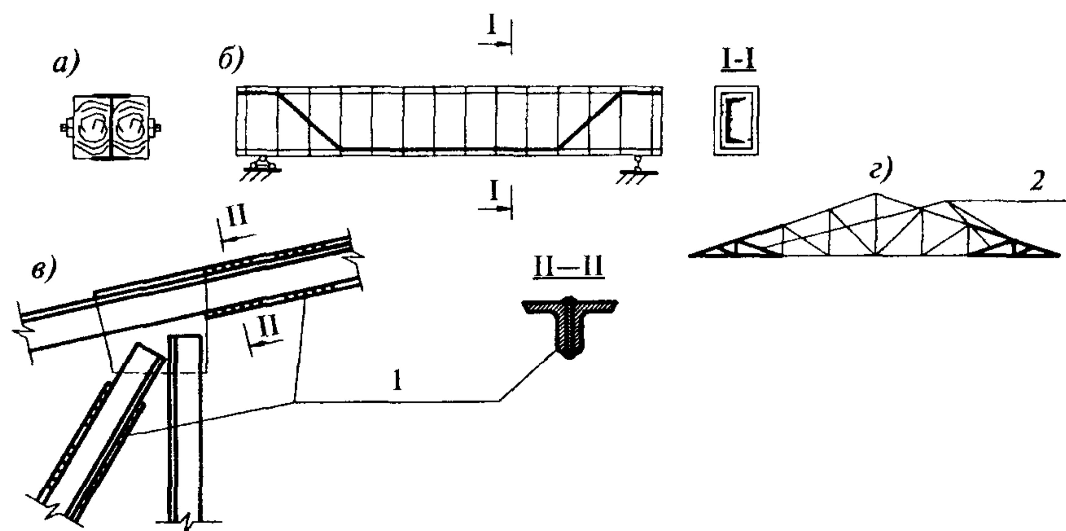
*a* — усиление металлического элемента деревянными брусьями, *b* — увеличение несущей способности швеллерной балки обетонированием (приведена схема армирования), *c* — усиление верхнего пояса и решетки фермы добавлением сплошной полосы между уголками, *г* — схема раскосной фермы с обозначением усиливаемых элементов стальными полосами или уголками, 1 — усиление стержней фермы полосовым металлом, 2 — усиливаемые стержни
