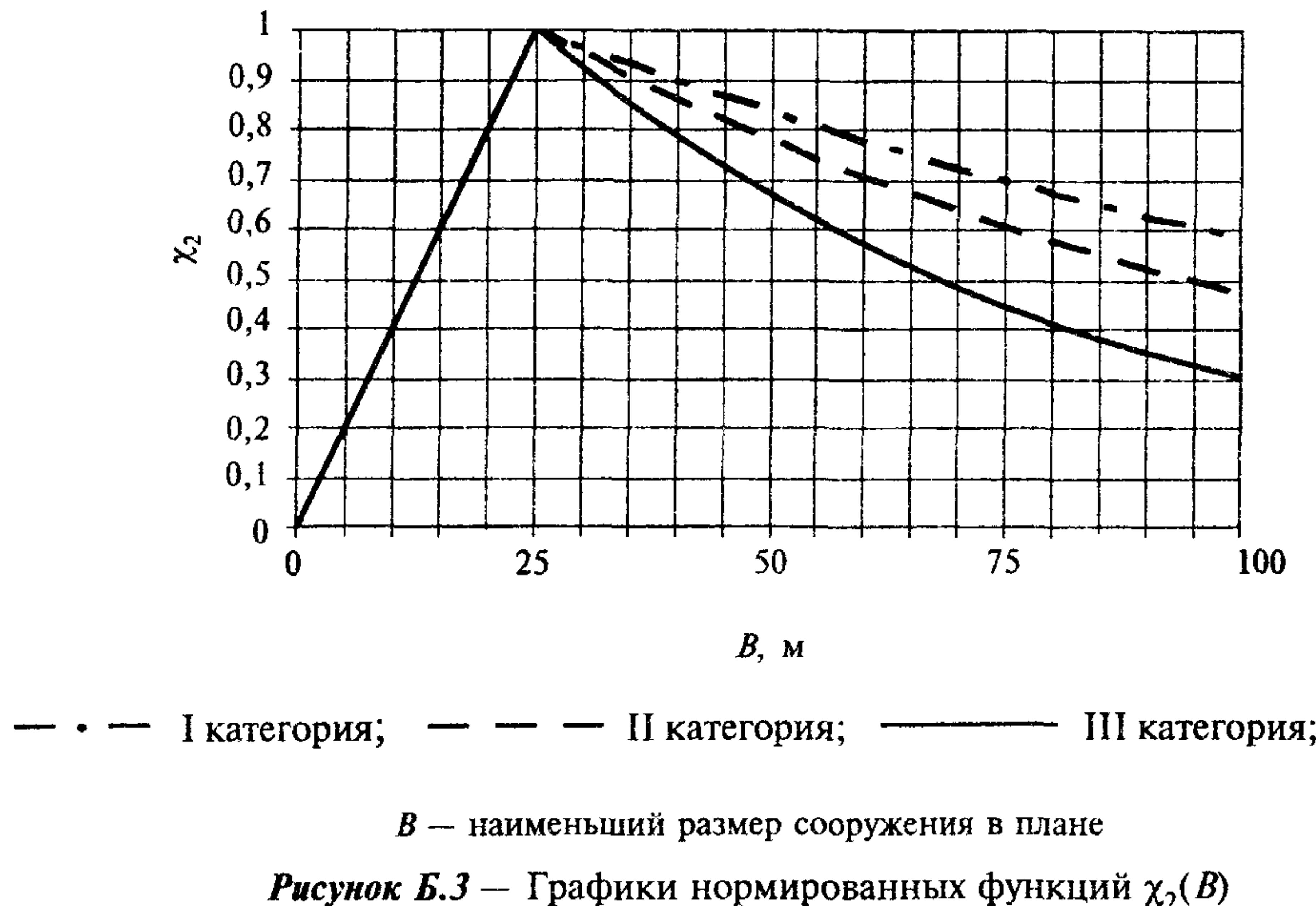
**Рисунок Б.3 — Графики нормированных функций  $\chi_2(B)$**
