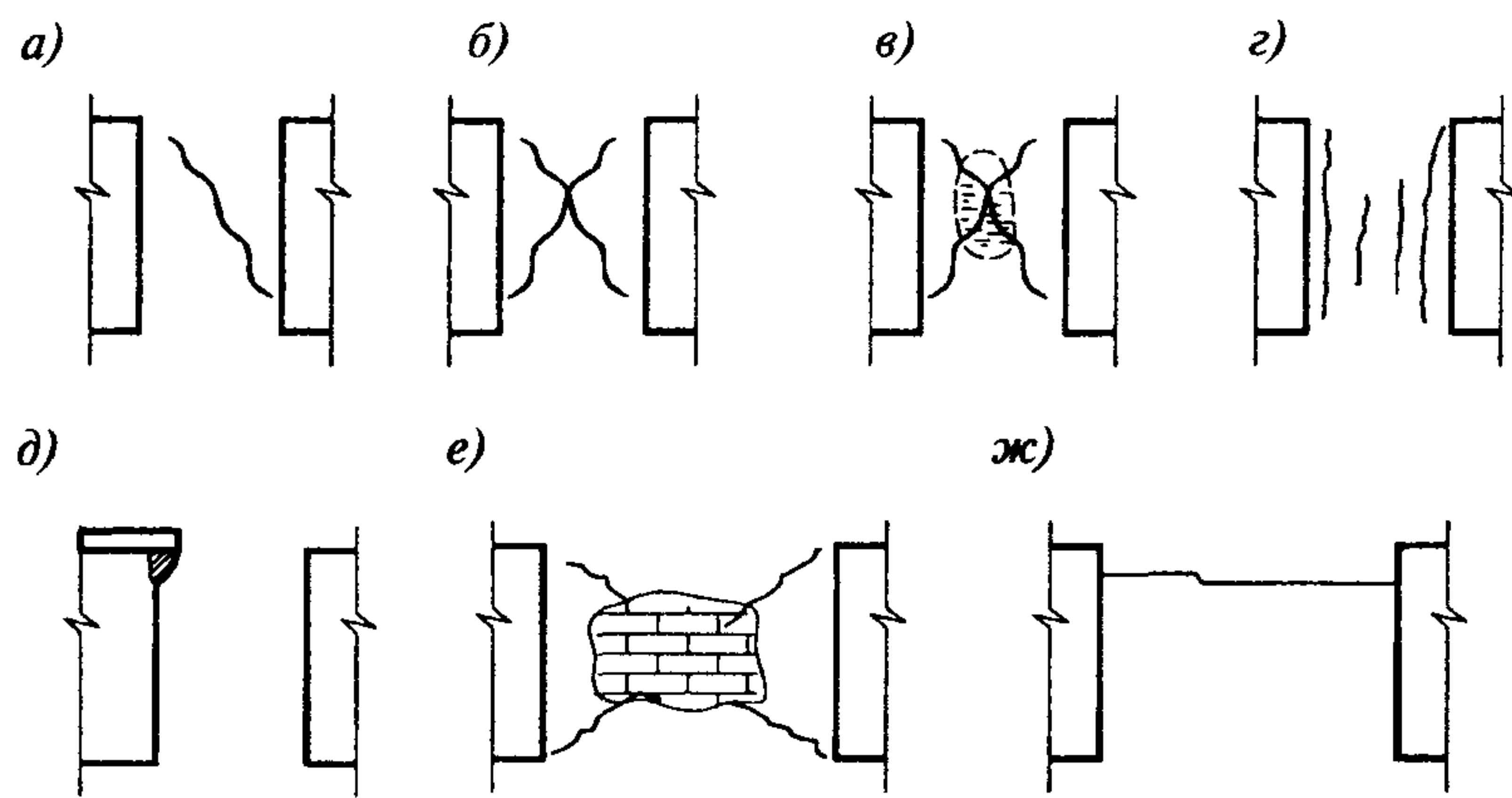
*a-d* — повреждения в относительно узких простенках; *e, jc* — повреждения в более широких простенках
