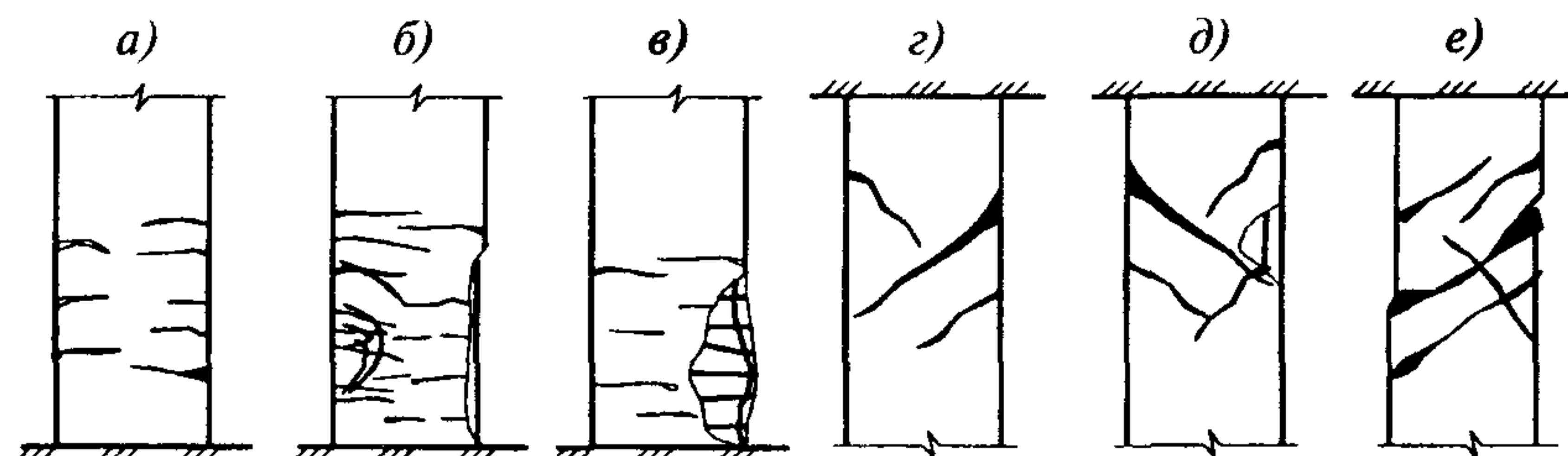
а—в — повреждение при увеличении изгибающего момента; г—е — повреждение стоек каркаса при недостаточном косвенном их армировании
