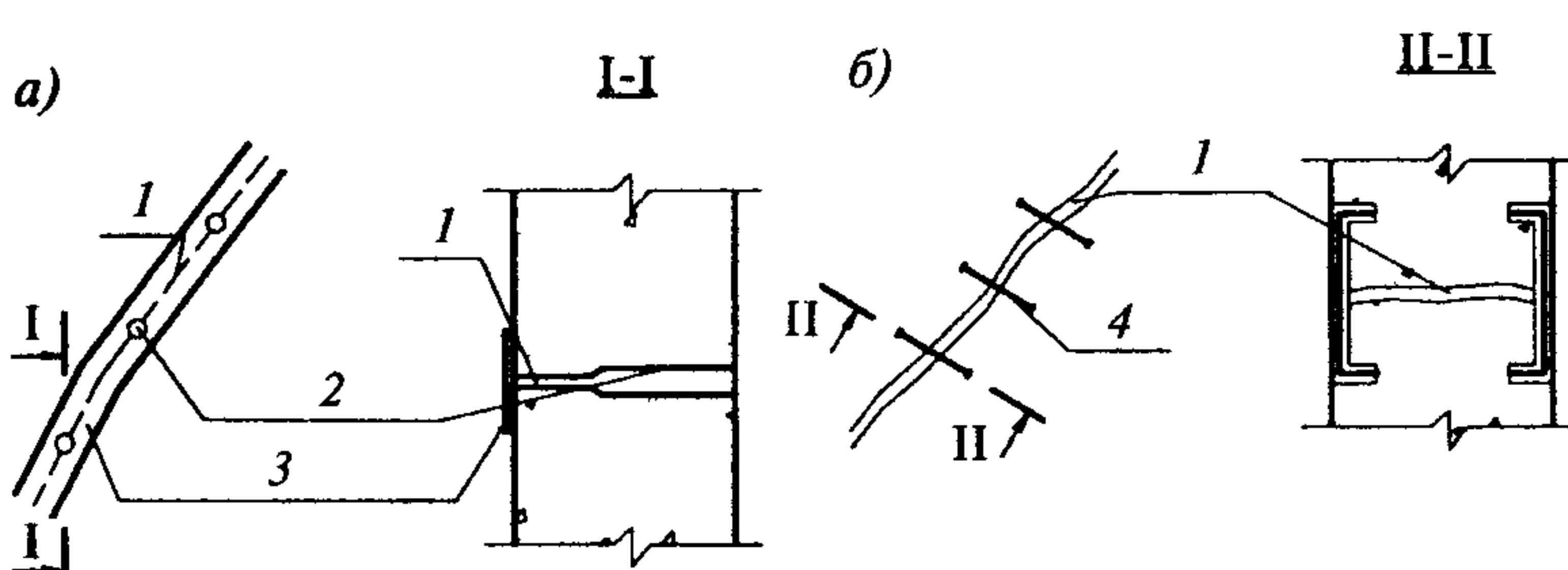
а — усиление конструкции заполнением трещины и пустот эпоксидным kleем, б — усиление с использованием полимерных армированных шпонок, 1 — трещина, 2 — отверстие для штуцера, 3 — герметик, 4 — полимерные армированные шпонки
