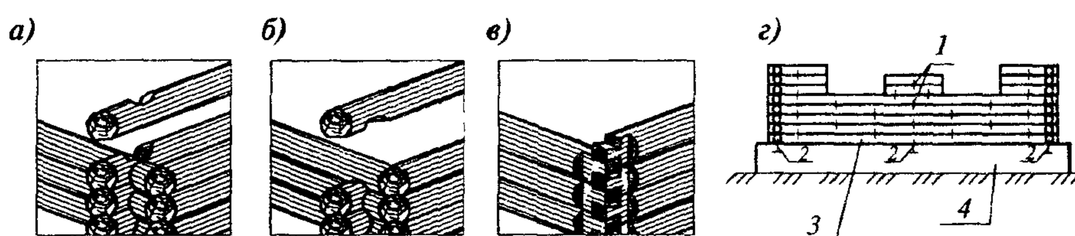
а — соединение углов «в обло» с чашками в нижних бревнах; б — то же, в верхних бревнах; в — соединение «в лапу» с чашками в нижних бревнах; г — схема размещения шпонок, крепящих деревянные бревенчатые или брусчатые венцы, и анкерное крепление нижнего венца с фундаментом; 1 — шпонки для соединения венцов между собой; 2 — анкерные крепления нижнего венца с фундаментом; 3 — нижний венец; 4 — фундамент
