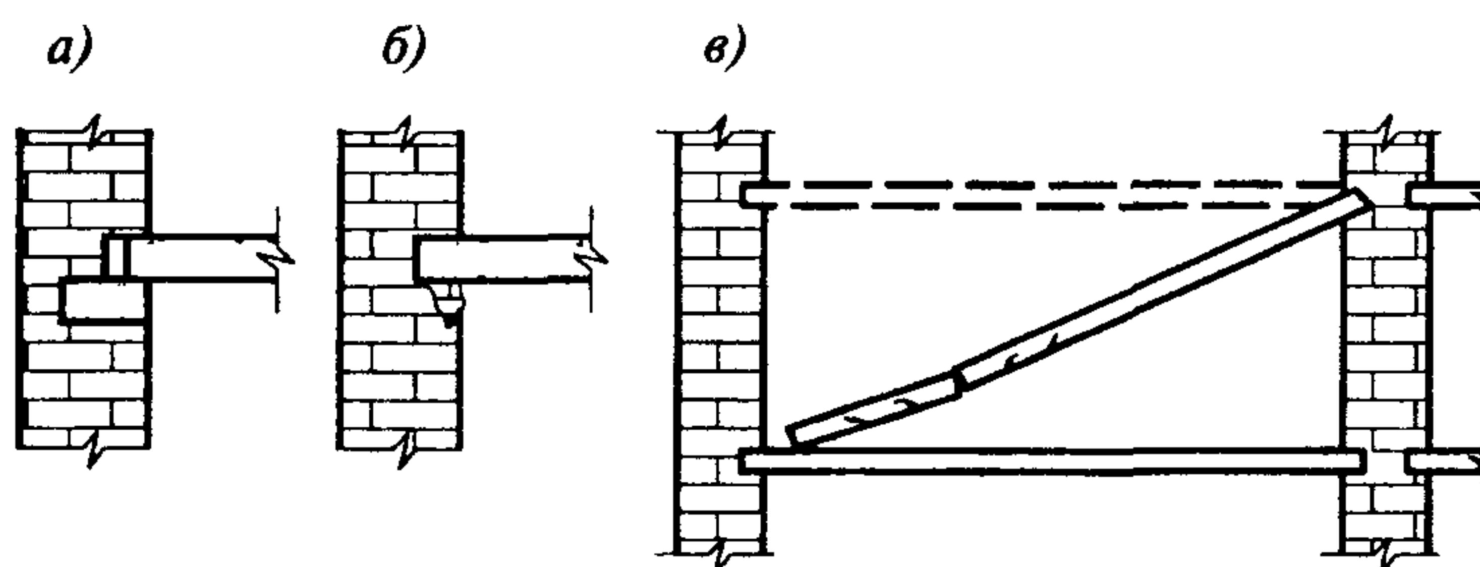
*a* — сдвиг по бетонной подкладке; *b* — разрушение кладки в местах опирания плит; *c* — вырыв конца плиты из кладки стены
