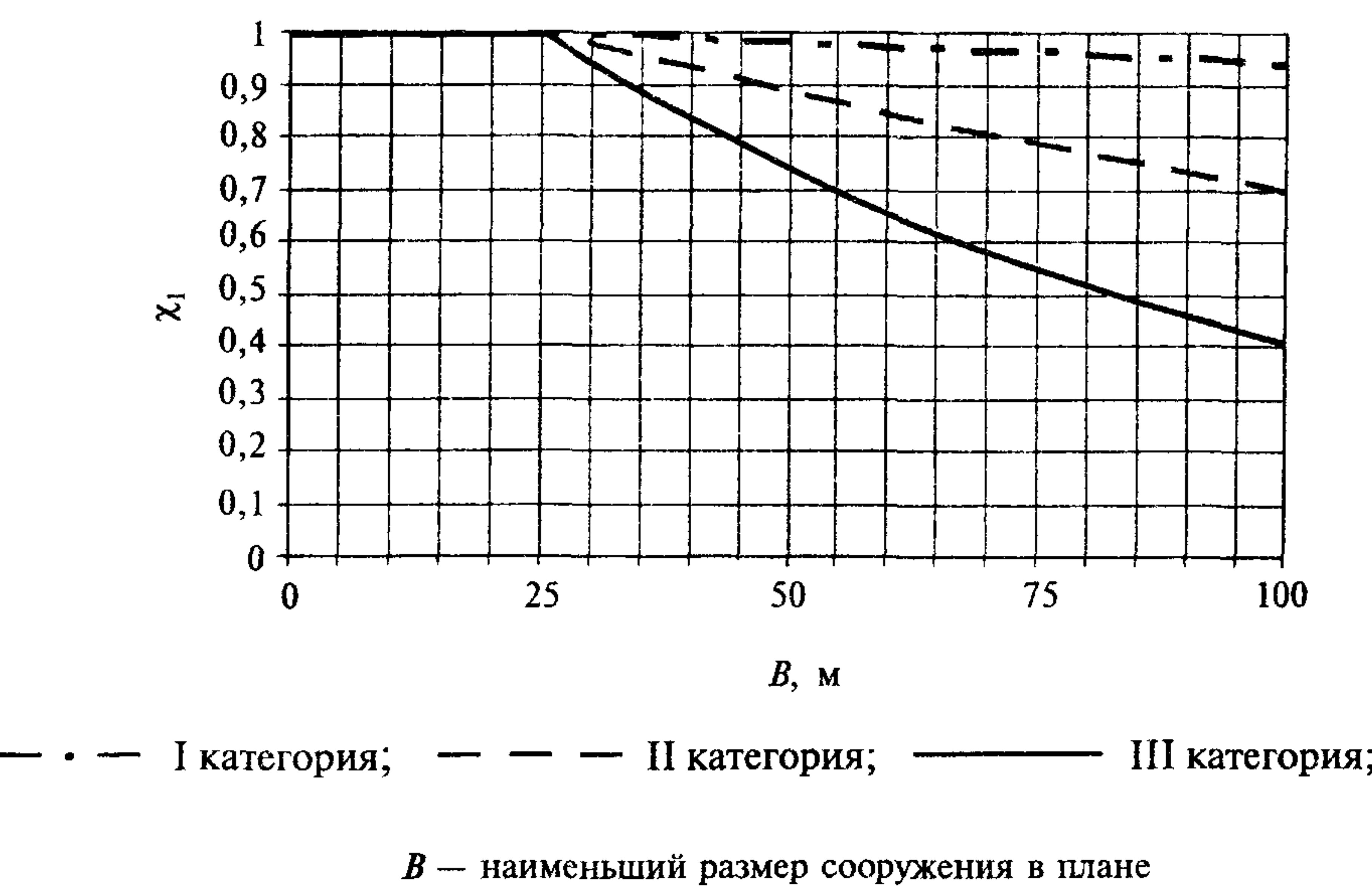
Рисунок Б.2 — Графики нормированных функций  $\chi_1(B)$
