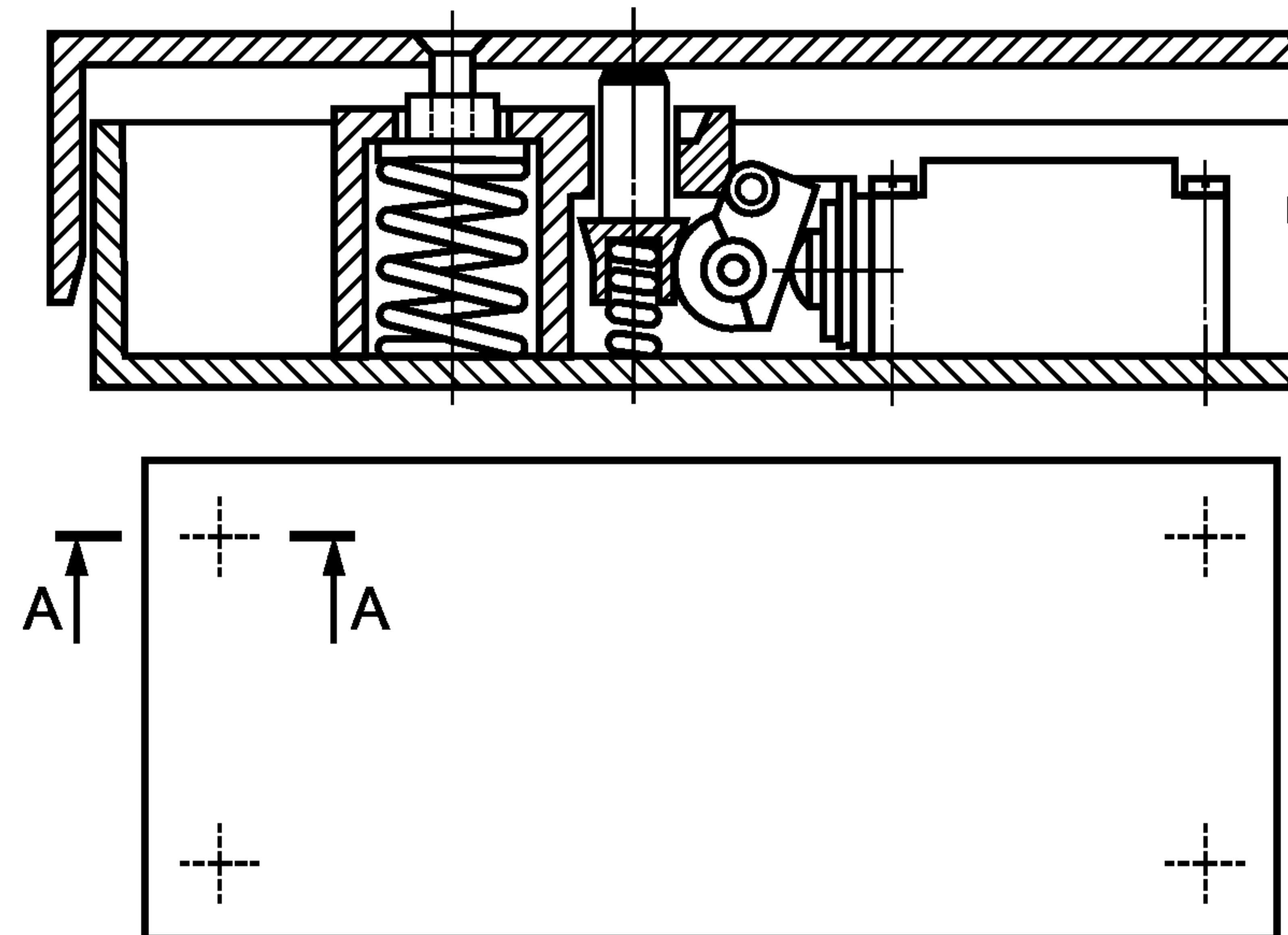
Рисунок С.1 — Использование концевых включателей
