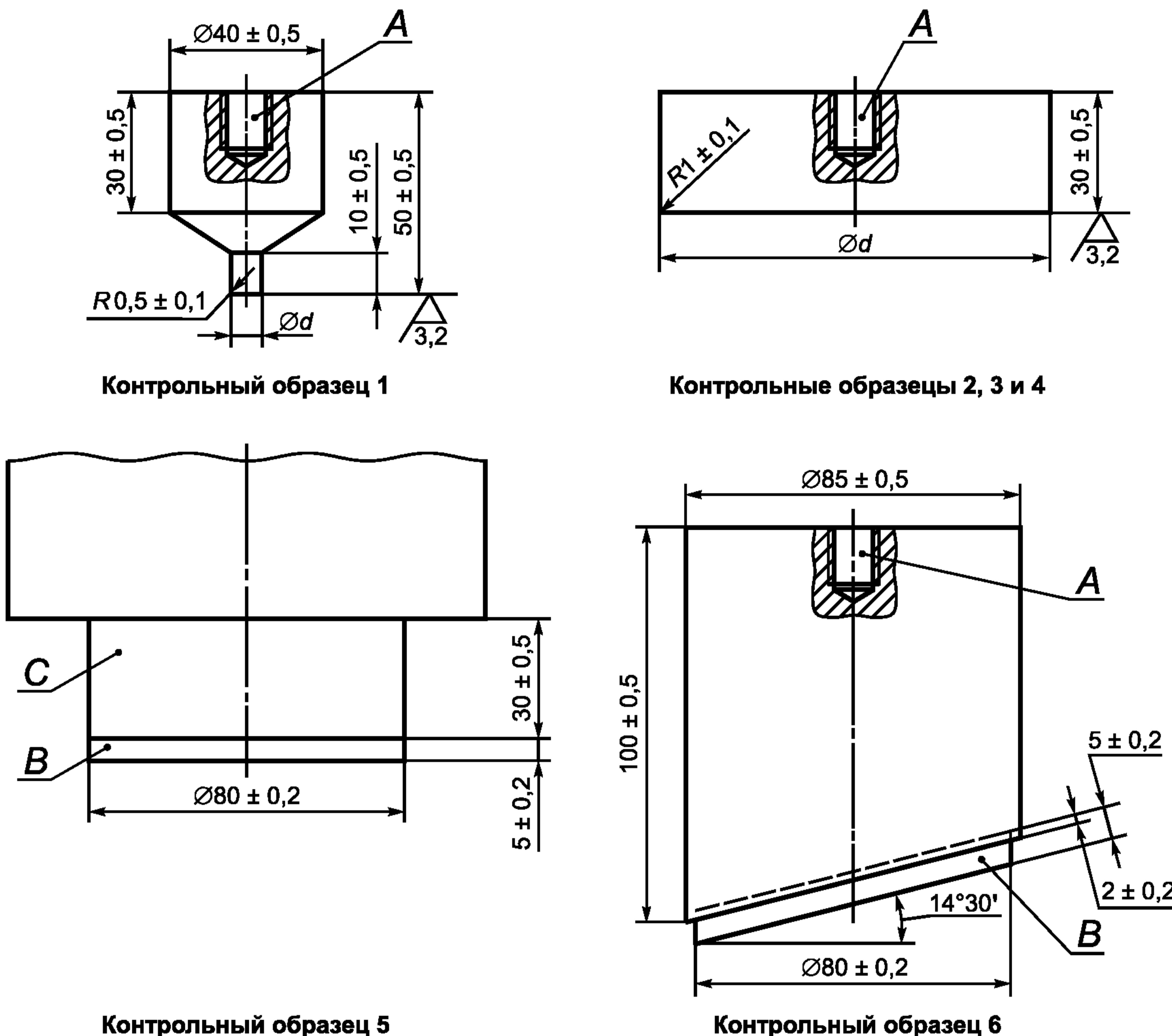
A — только для монтажа; B — наклеенный резиновый «башмак», твердость по Шору  $(60 \pm 5)$  A;
