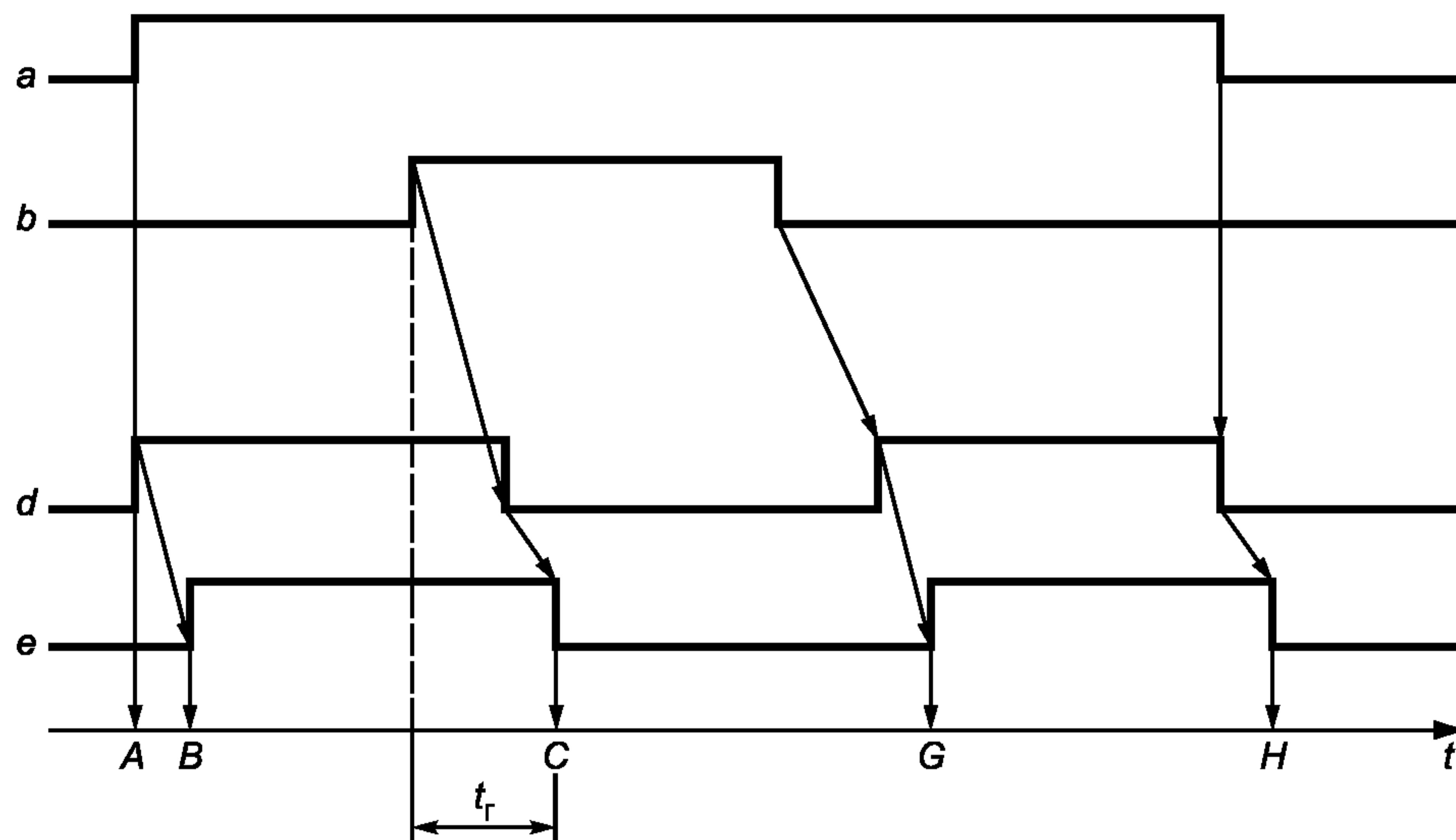
*a* — питание, поданное на коврик или пол; *b* — воздействующая сила; *d* — выход датчика; *e* — выходное состояние выходного переключателя (переключателей); *t* — время; *t<sub>r</sub>* — время реагирования
