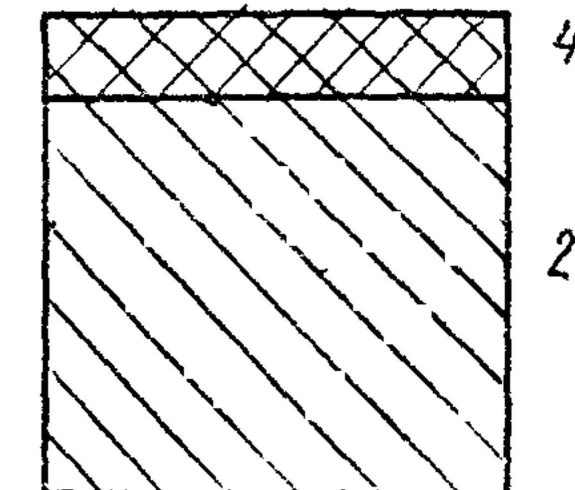
1-асфальтобетон или битумоминеральная смесь; 2-песок мелкий, укрепленный битумной эмульсией, пастой, жидким битумом или сырой нефтью с добавкой золы уноса; 3-грунт, укрепленный цементом или золой уноса; 4-слой износа
