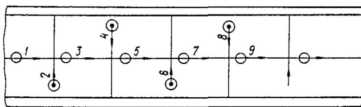
Положение рабочего органа нарезчика швов ДНШС-60 перед нарезкой поперечного шва: 1 — зуб вибропластины; 2 — прорезь на вибропластине; 3 — изоловая прокладка; 4 — головка фиксатора; 5 — рельс-форма.
