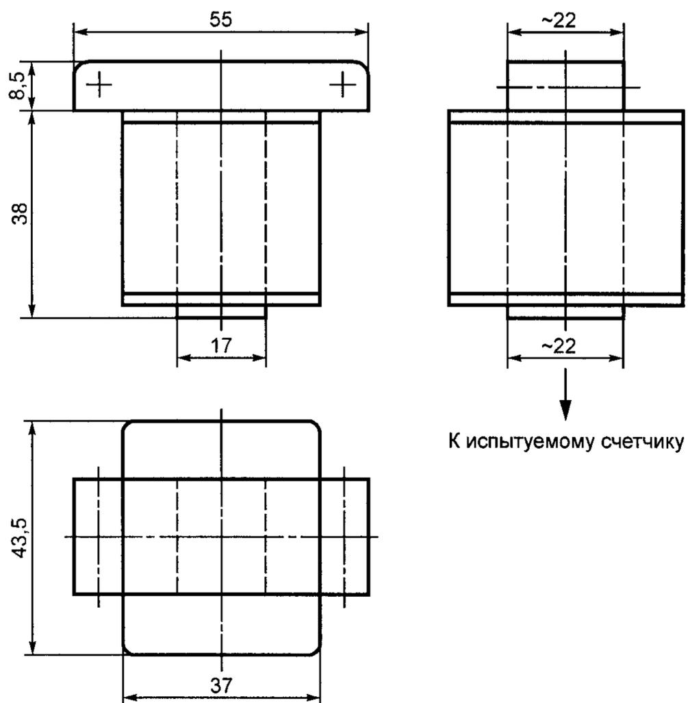
Примеры обмотки: 500 витков проволоки диаметром 0,6 мм, сечением 0,28 мм<sup>2</sup> или 1000 витков проволоки диаметром 0,4 мм, сечением 0,126 мм<sup>2</sup>.
