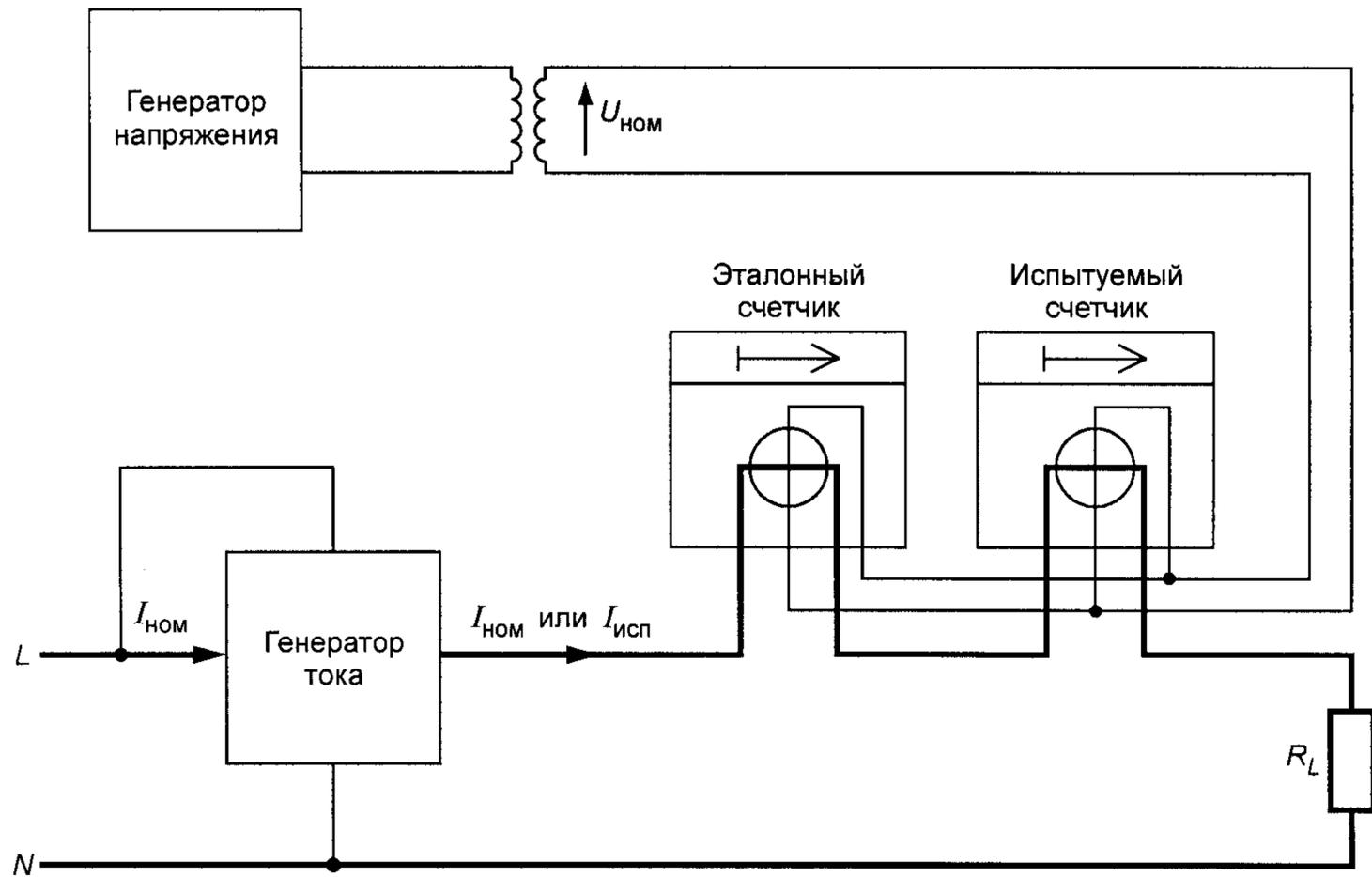
Рисунок А.1 — Схема испытательной цепи (справочная)
