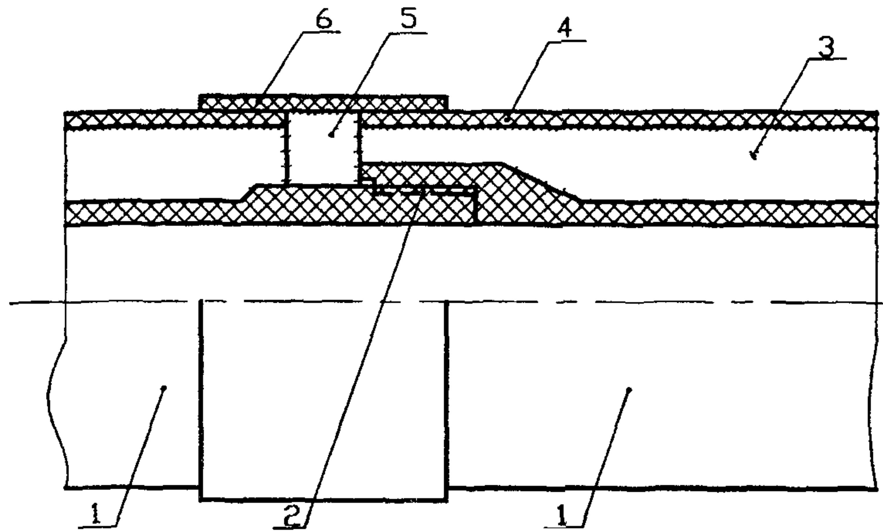
Рис 6 Термогидроизоляция стыков теплоизолированных труб и фасонных изделий из стекло – базальтопластика
