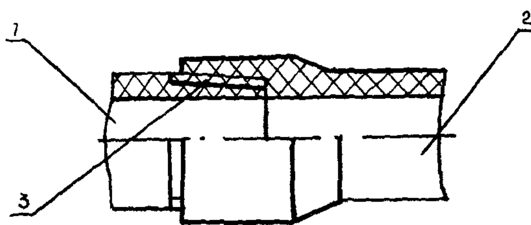
б) соединение труб из стекло базальто-пластика со стальными концами труб, арматуры и компенсаторов
