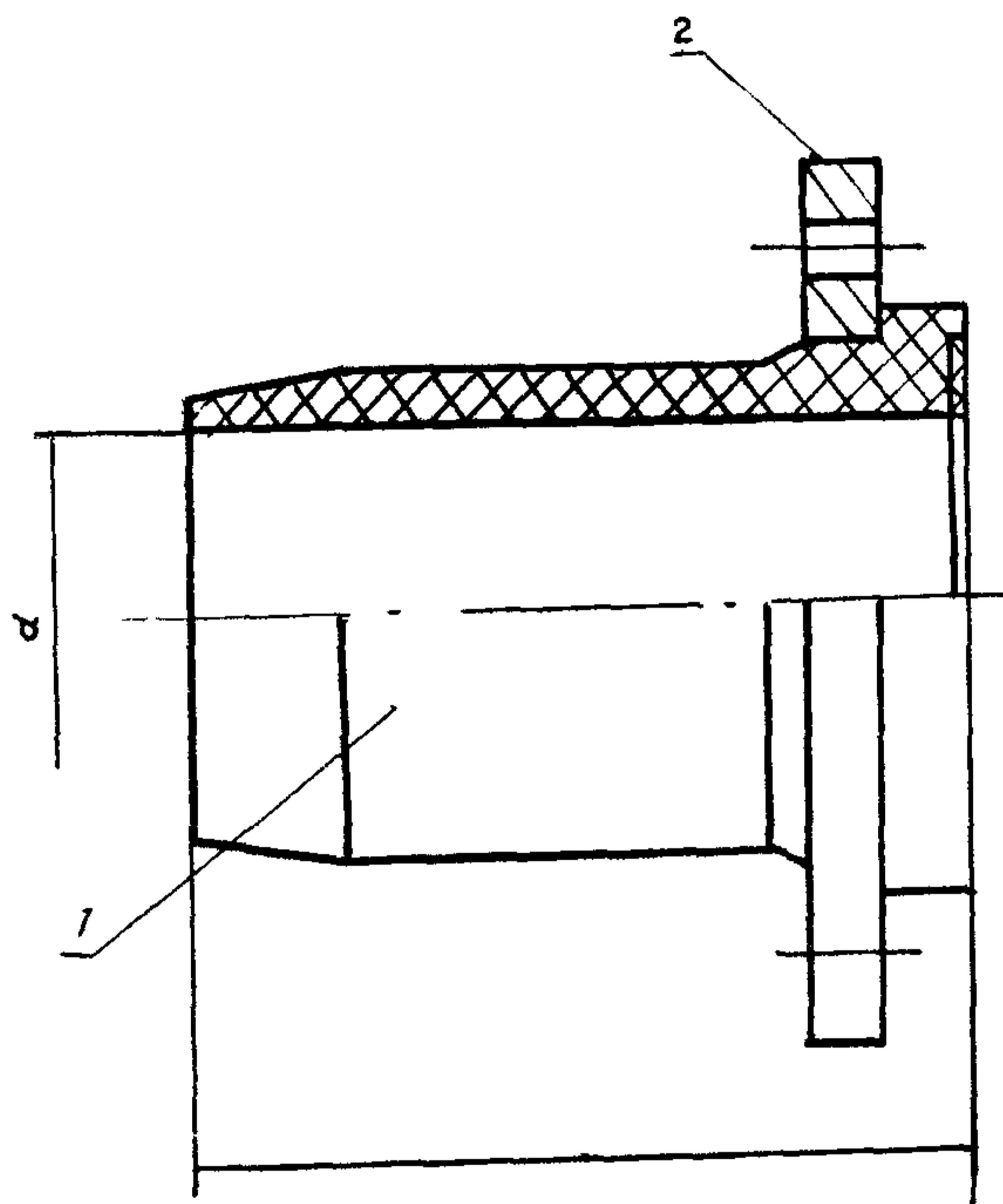
Рис. 5. Фланцевое соединение труб из стекло базальто пластика с металлическими трубами и фланцевой арматурой
