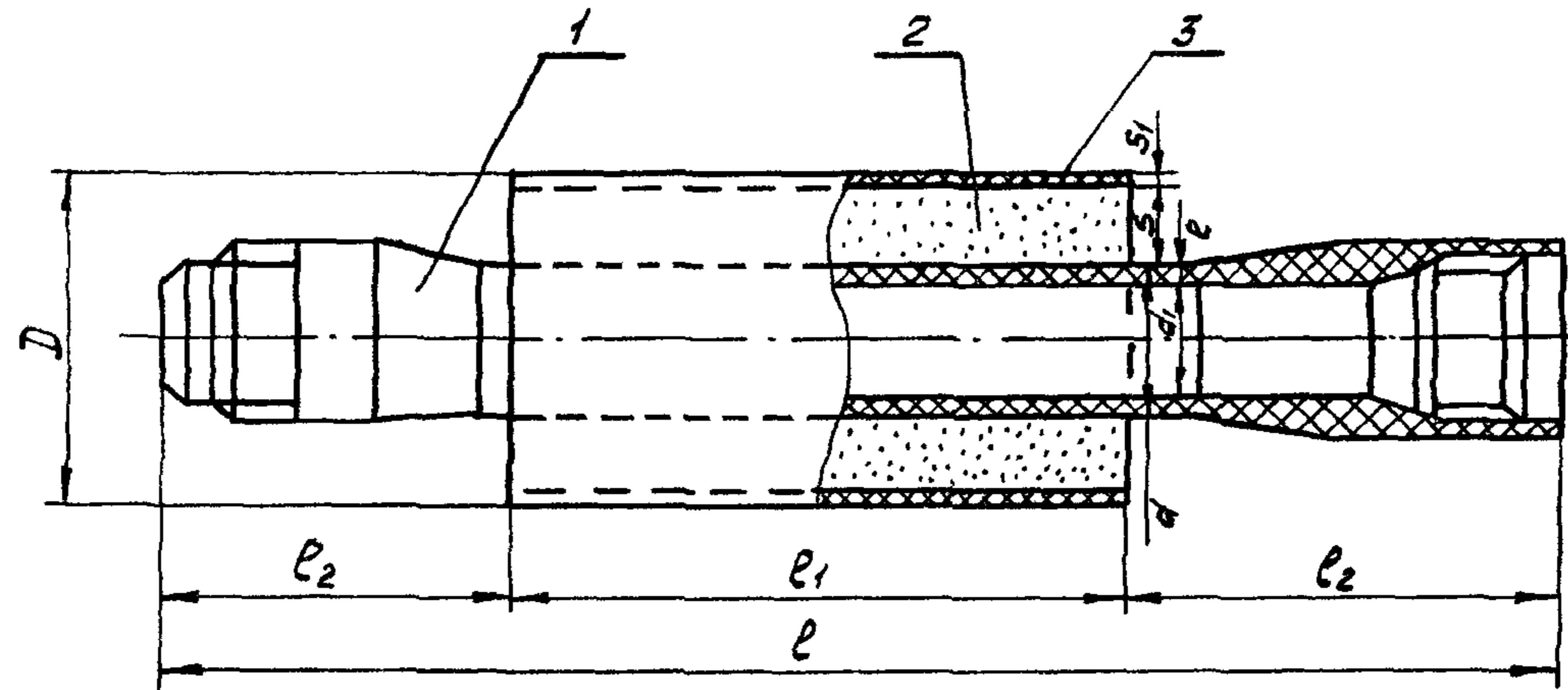
Рис 1 Термоизолированная труба из стекло-базальто пластика.
