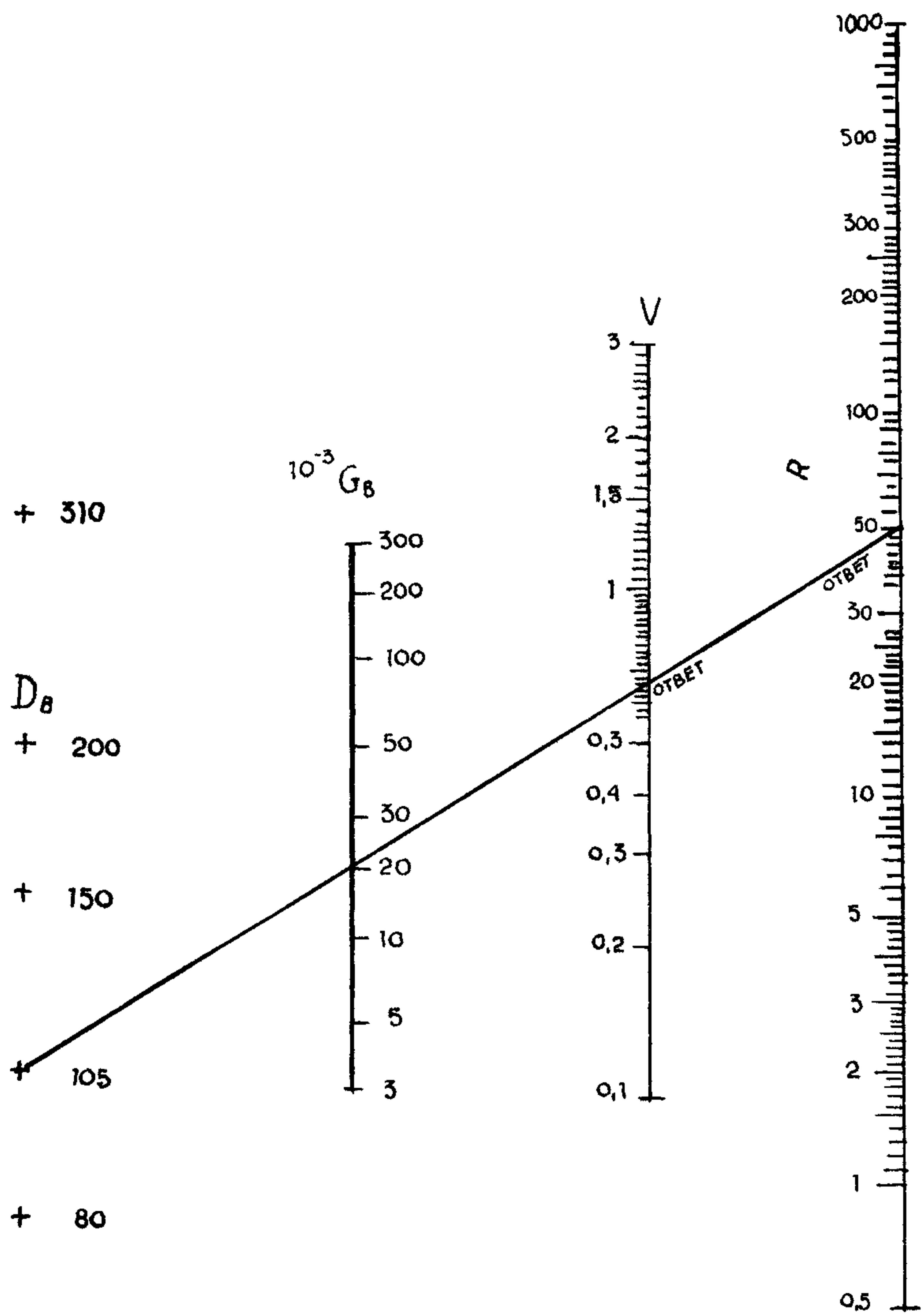
Рис 3. Номограмма для гидравлического расчета теплопроводов из стекло (базальто)
