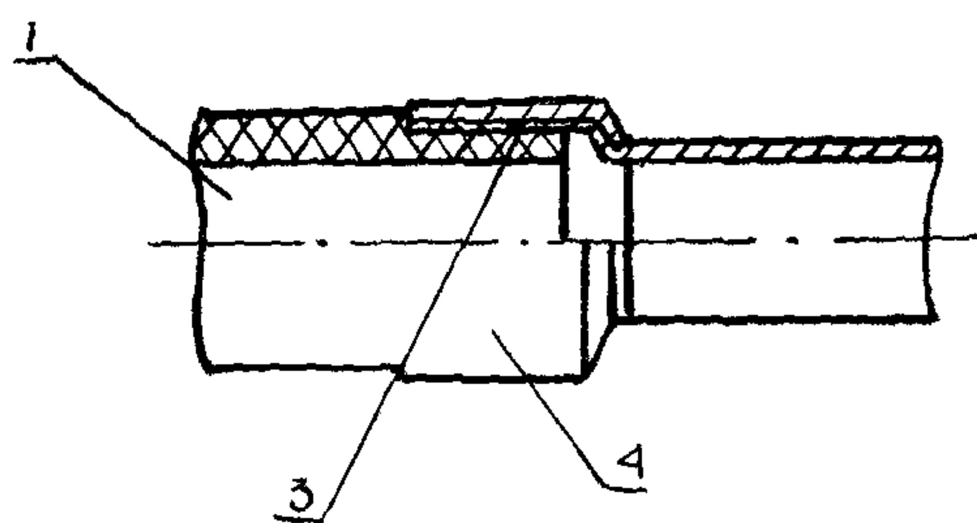
Рис 4 Резьбо-клеевое соединение труб и фасонных изделий из стекло-базальто пластика между собой и со стальными концами труб, арматуры, стартовых компенсаторов
