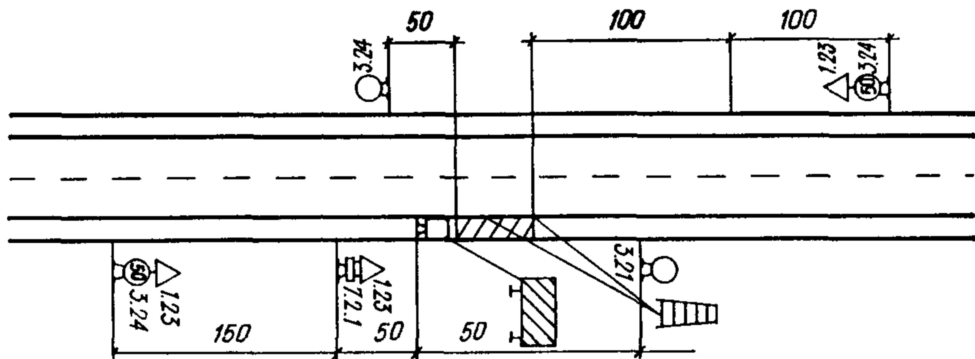
Рис. 4. Организация движения при ремонтных работах на обочине двухполосных дорог
