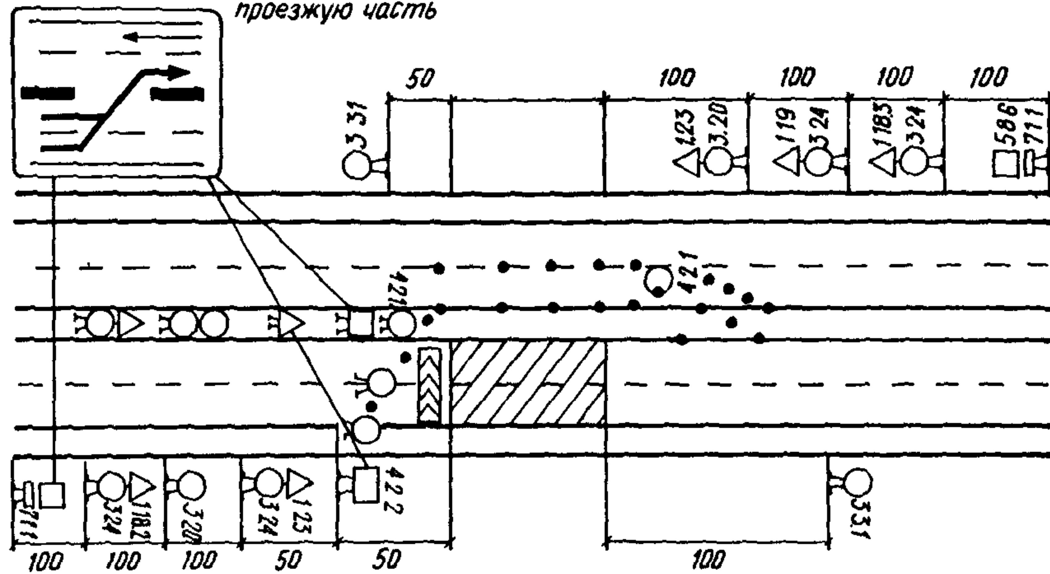
Рис. 8. Организация движения при ремонтных работах
