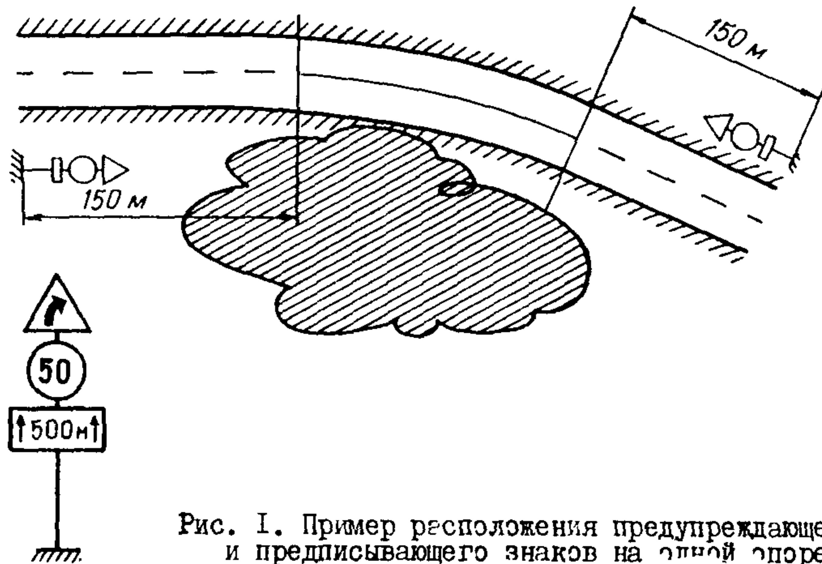
Рис. I. Пример расположения предупреждающего и предписывающего знаков на опоре
