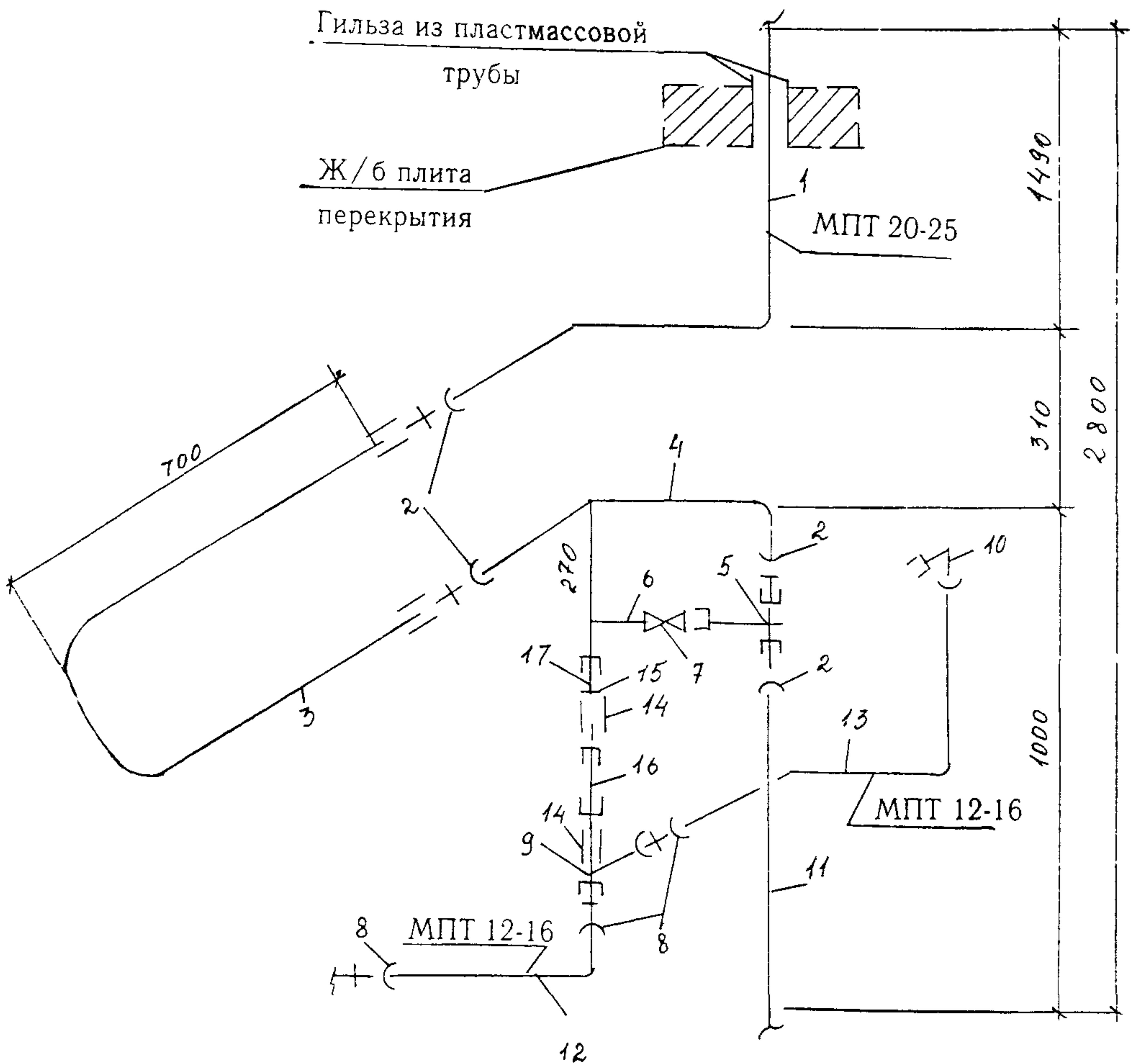
Рис.2. Схема горячего водоснабжения из МПТ:
