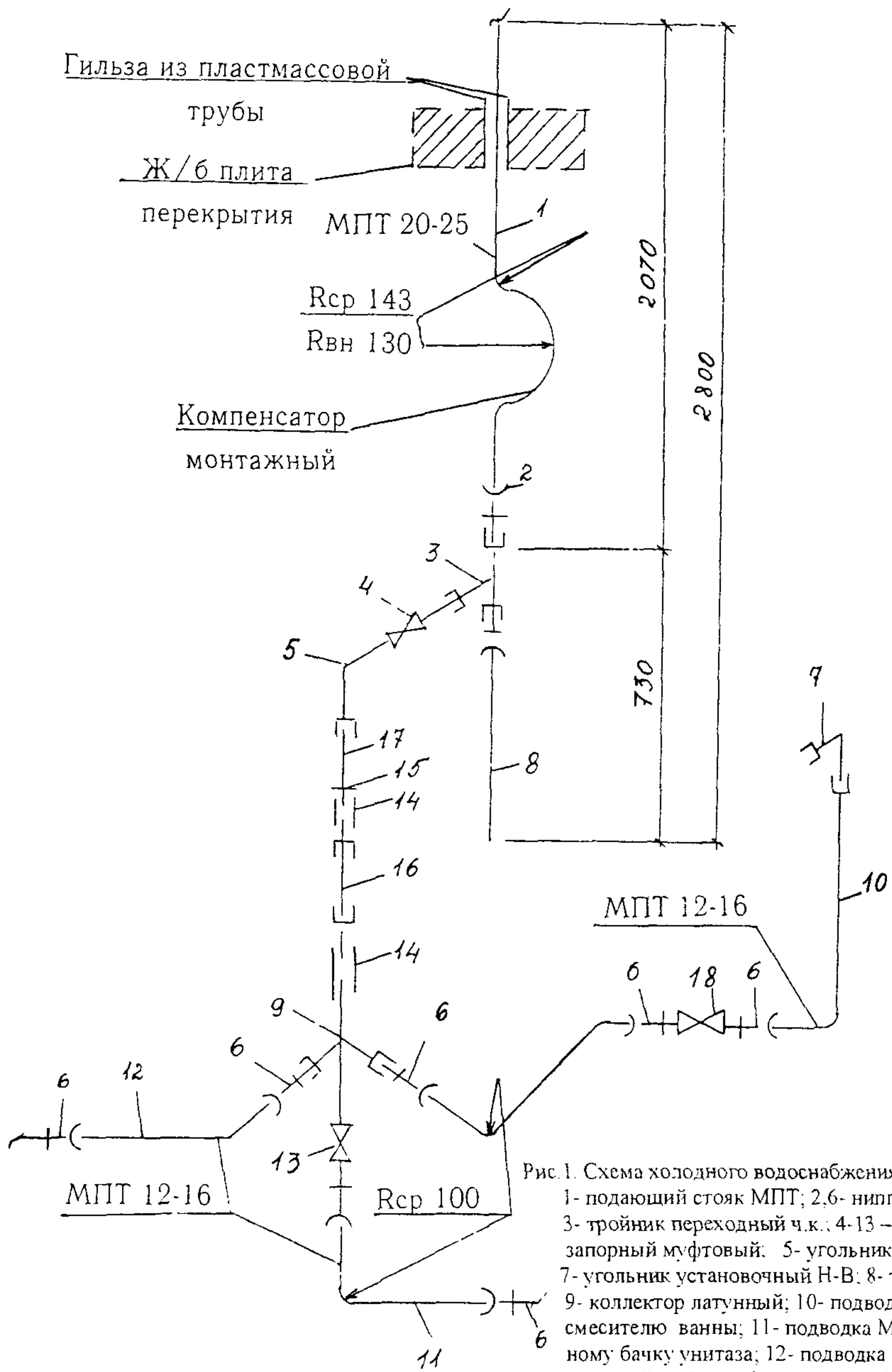
Рис. 1. Схема холодного водоснабжения из МПТ:
