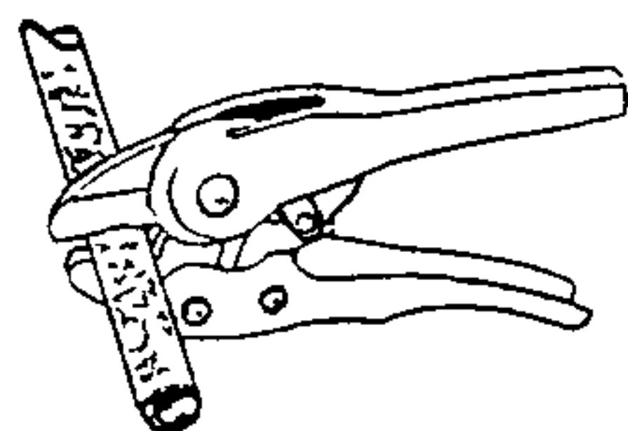
Рис. 3. Специальные ножницы для отрезания металлополимерных труб.
