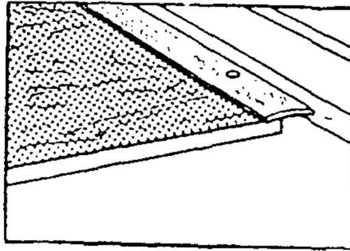
Рис. 6. Укладка металлической накладки на стыке двух видов покрытий
