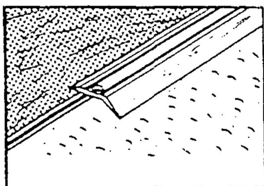
Рис. 7. Укладка уголка на стыке двух покрытий в разных уровнях
