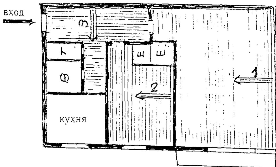
Рис. 3. Схема укладки досок ламинат-паркета:
