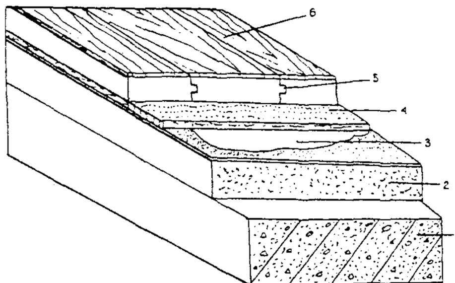
Рис. 1. Конструкция пола с покрытием из ламинат-паркета:
