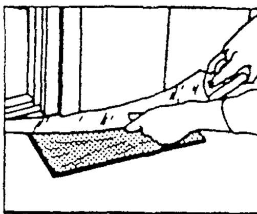
Рис. 8. Подрезка нижней части дверной коробки
