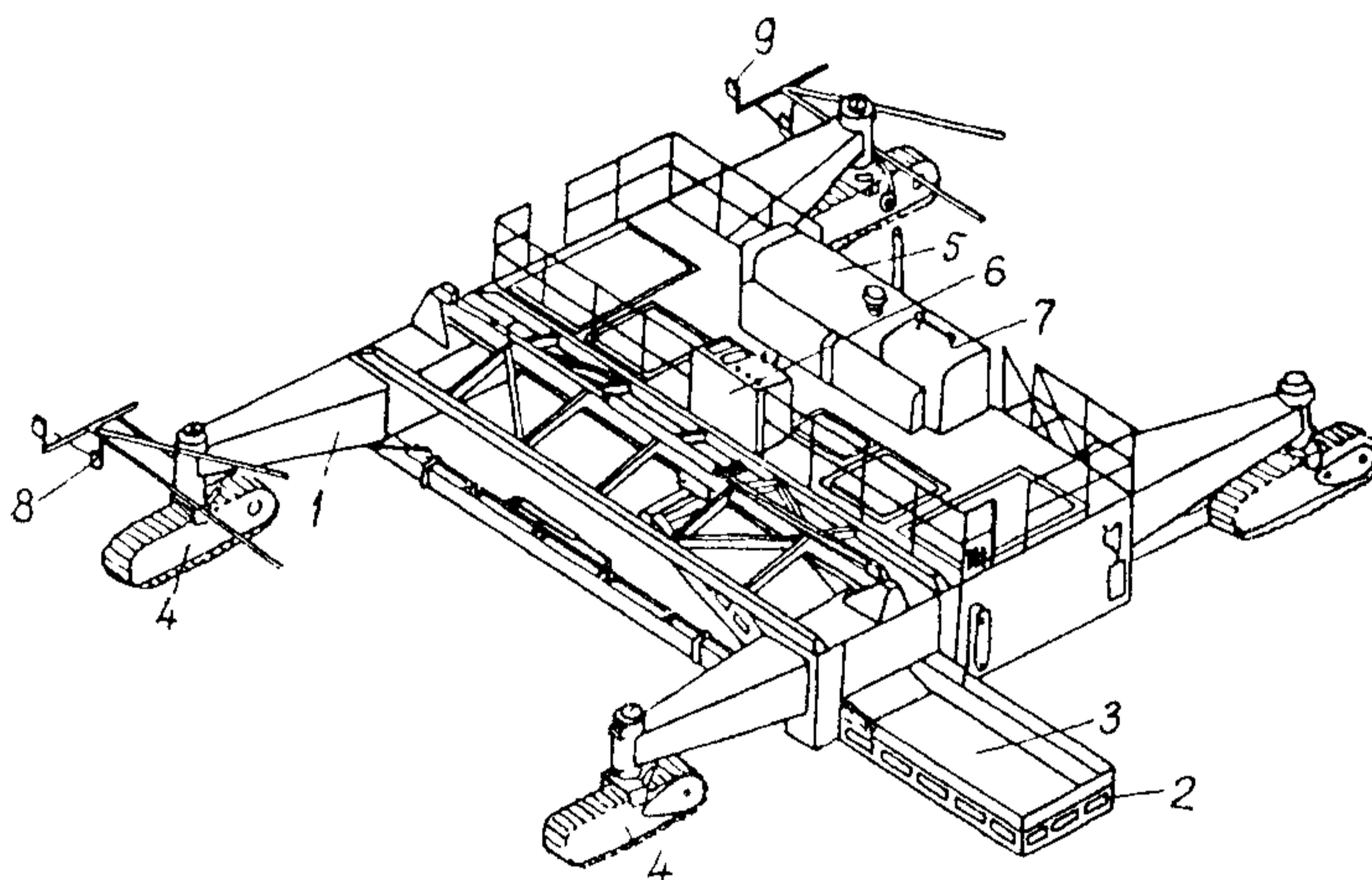
Рис. 1. Общий вид распределителя бетонной смеси.
