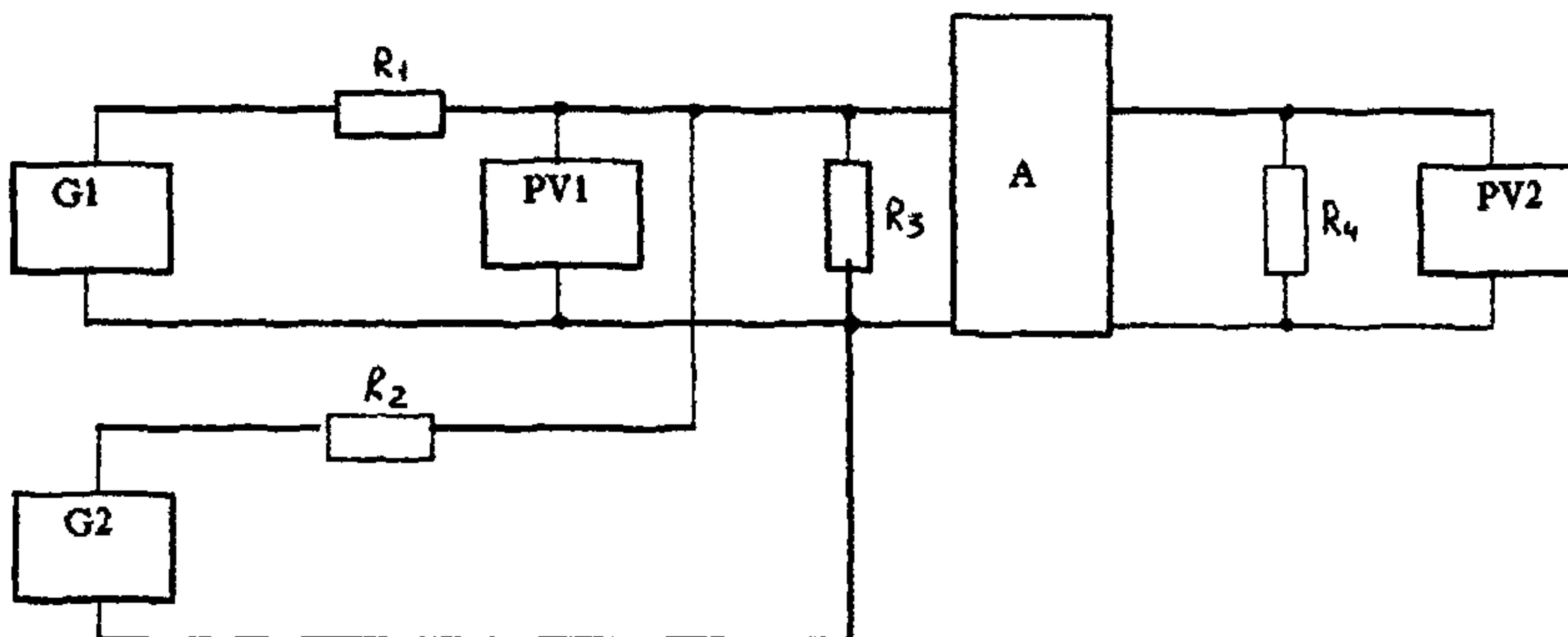
G1, G2 - генераторы сигналов низкочастотные;
