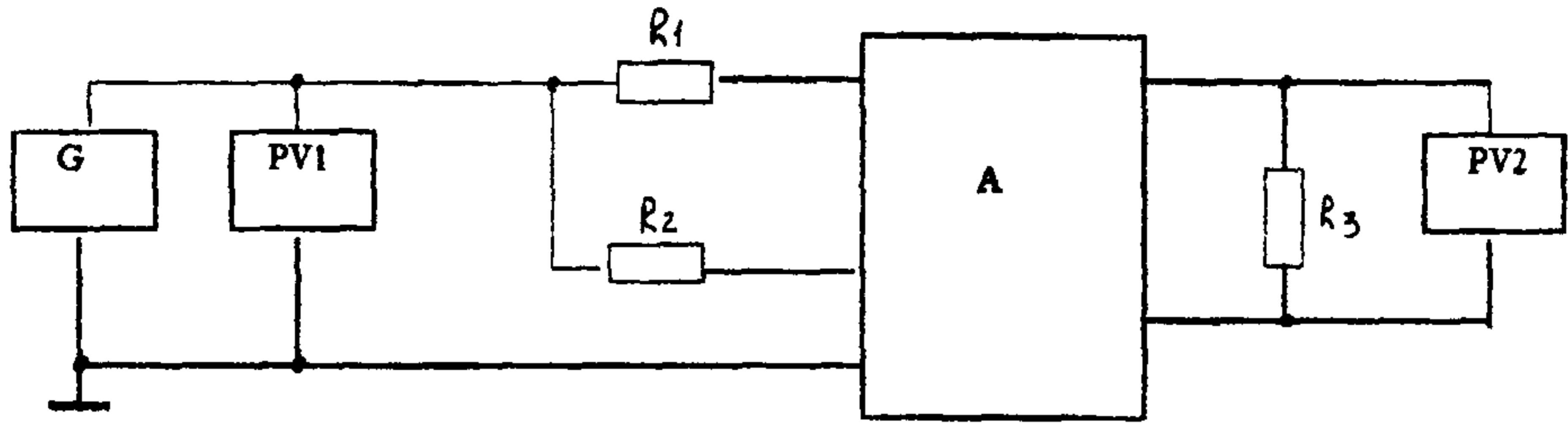
G - генератор сигналов низкочастотный;
