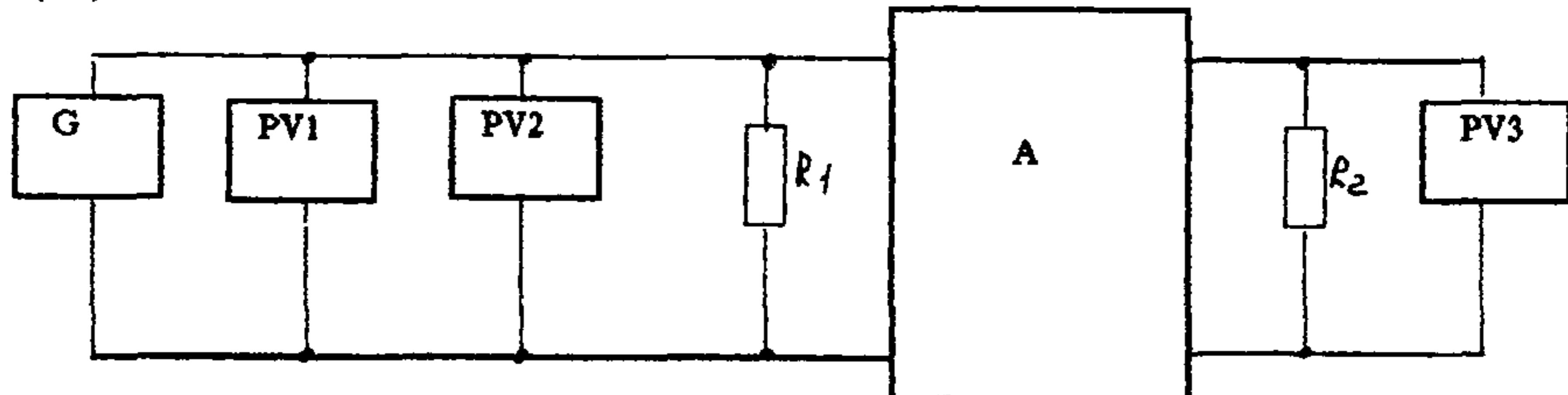
G - генератор сигналов низкочастотный;
