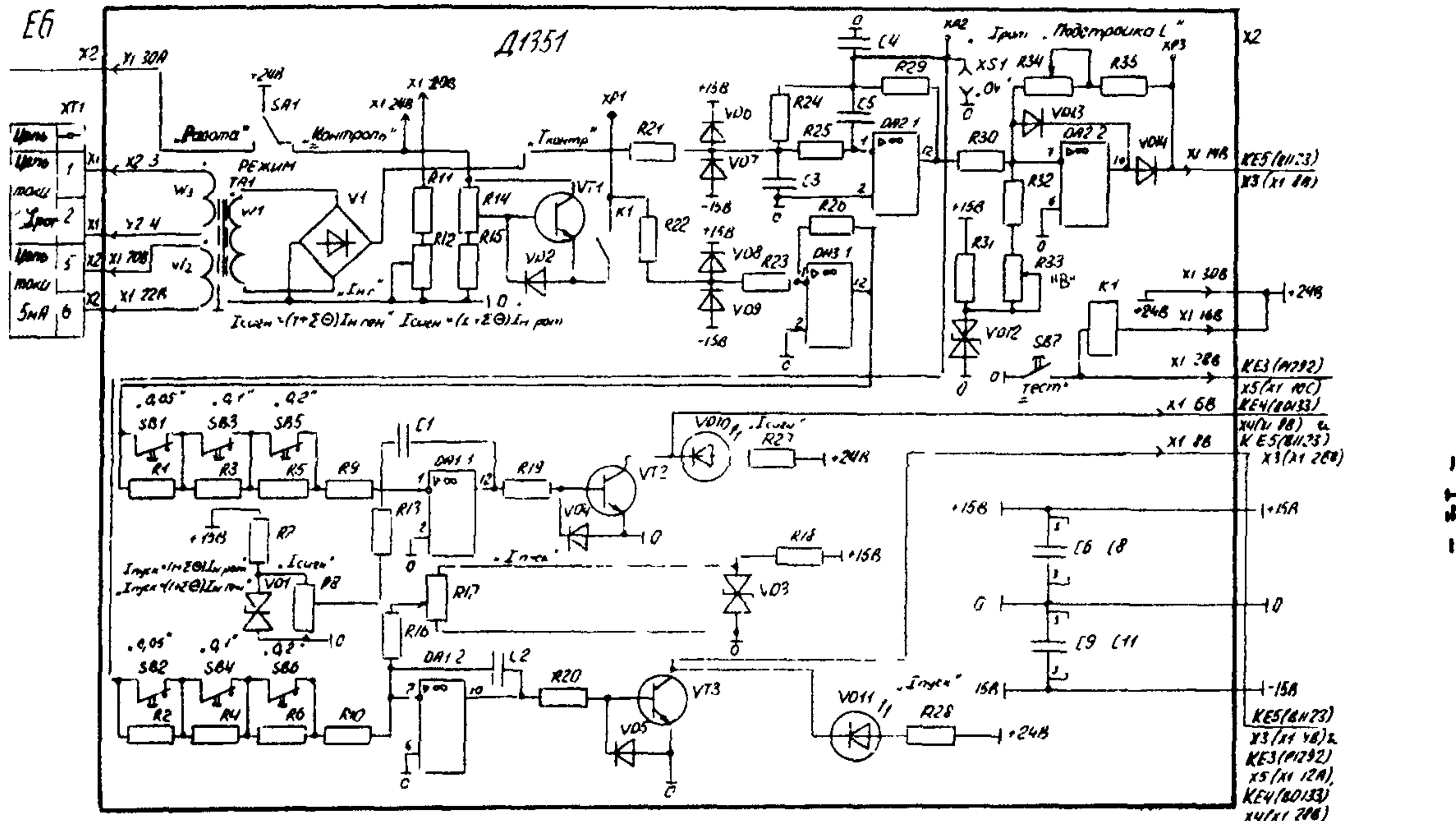
Рис.8. Принципиальная электрическая схема блока преобразователя входных сигналов Д135I
