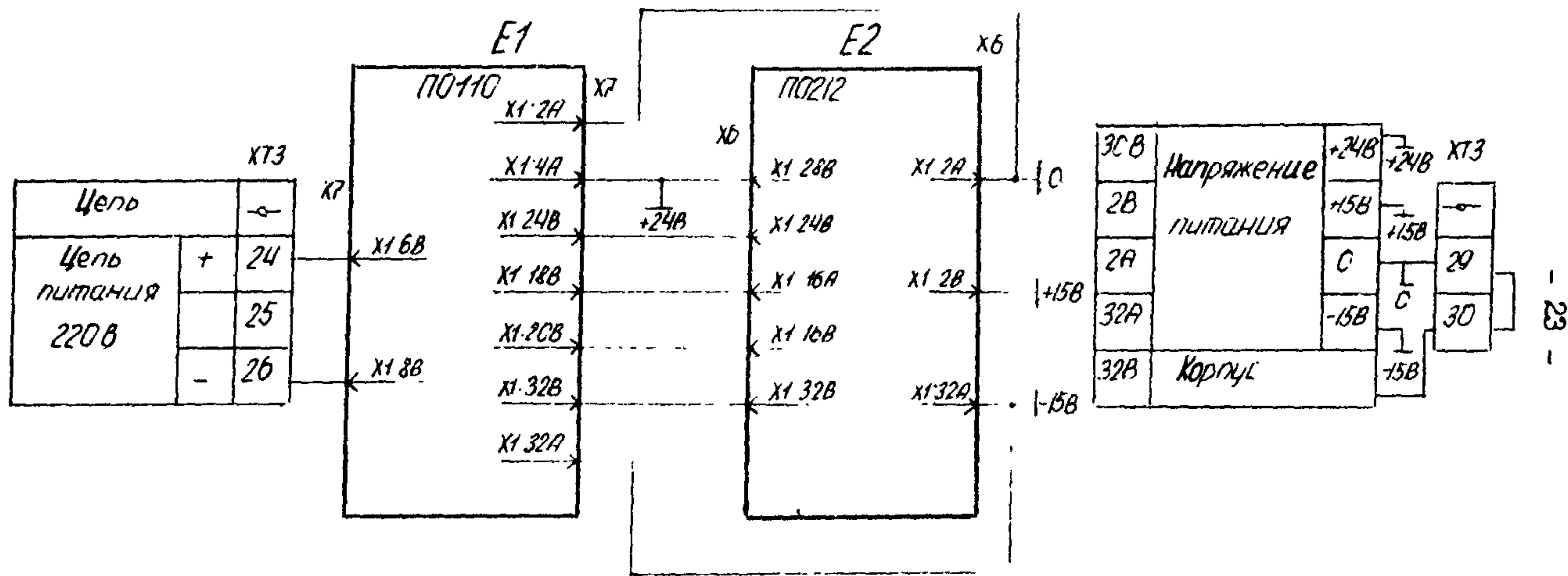
Рис. Г7. Электрические связи блоков питания и стабилизации напряжения защиты БЭИ03
