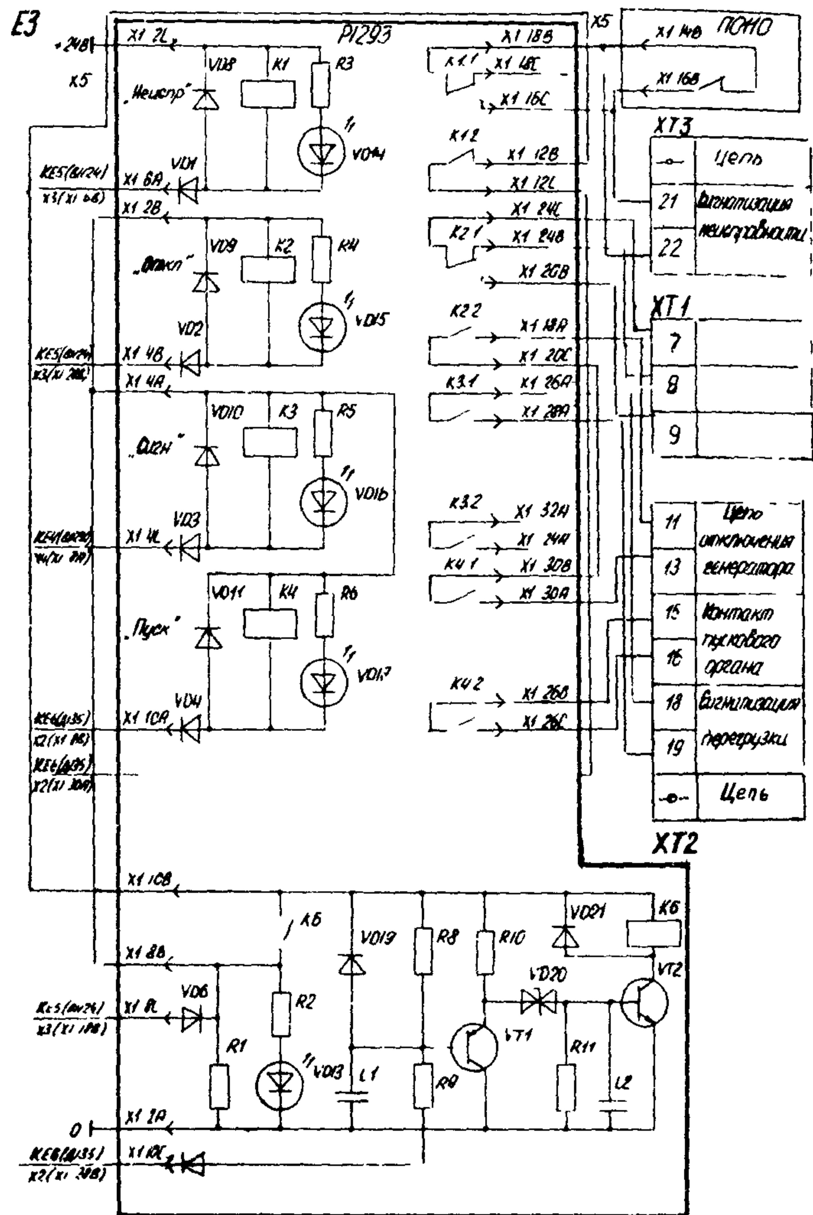
Рис. I6. Принципиальная электрическая схема блока реле Р1293 защиты
