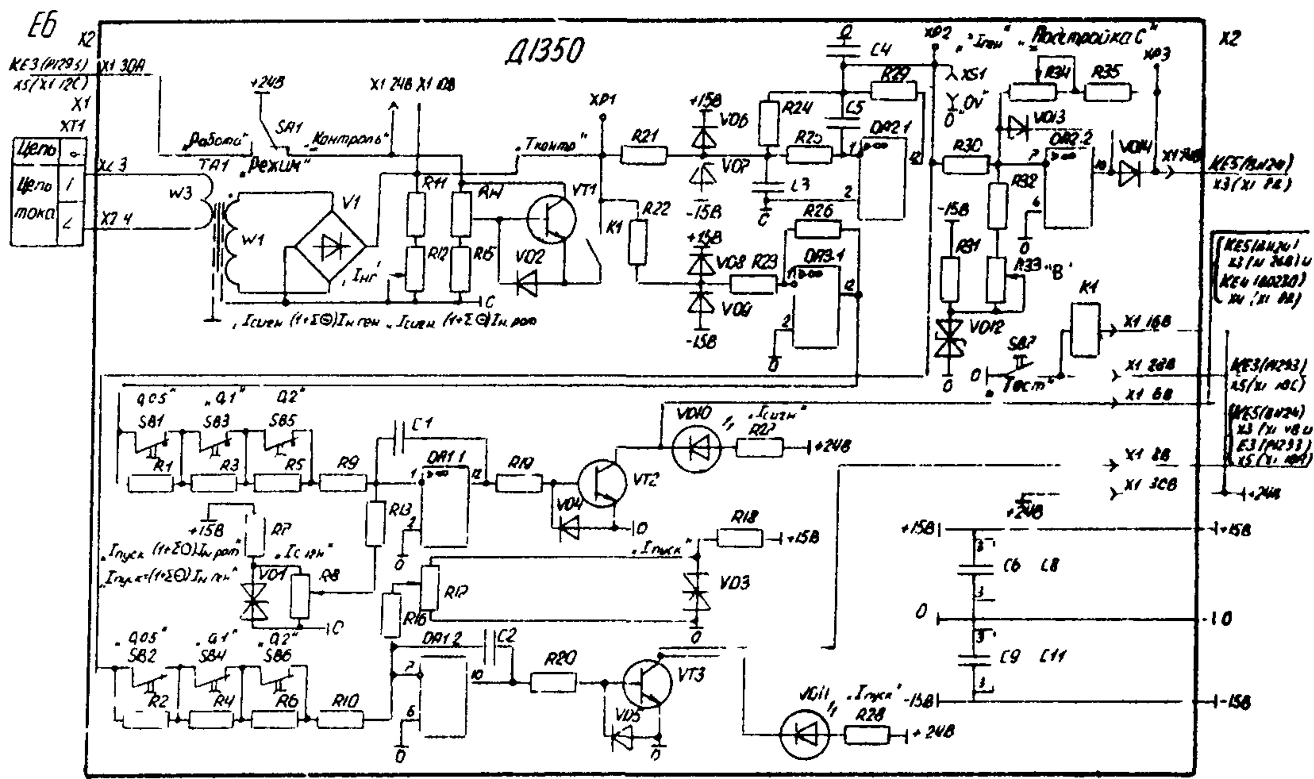
Рис. I3. Принципиальная электрическая схема блока преобразователя входных сигналов ДИ350 защиты БЭП103
