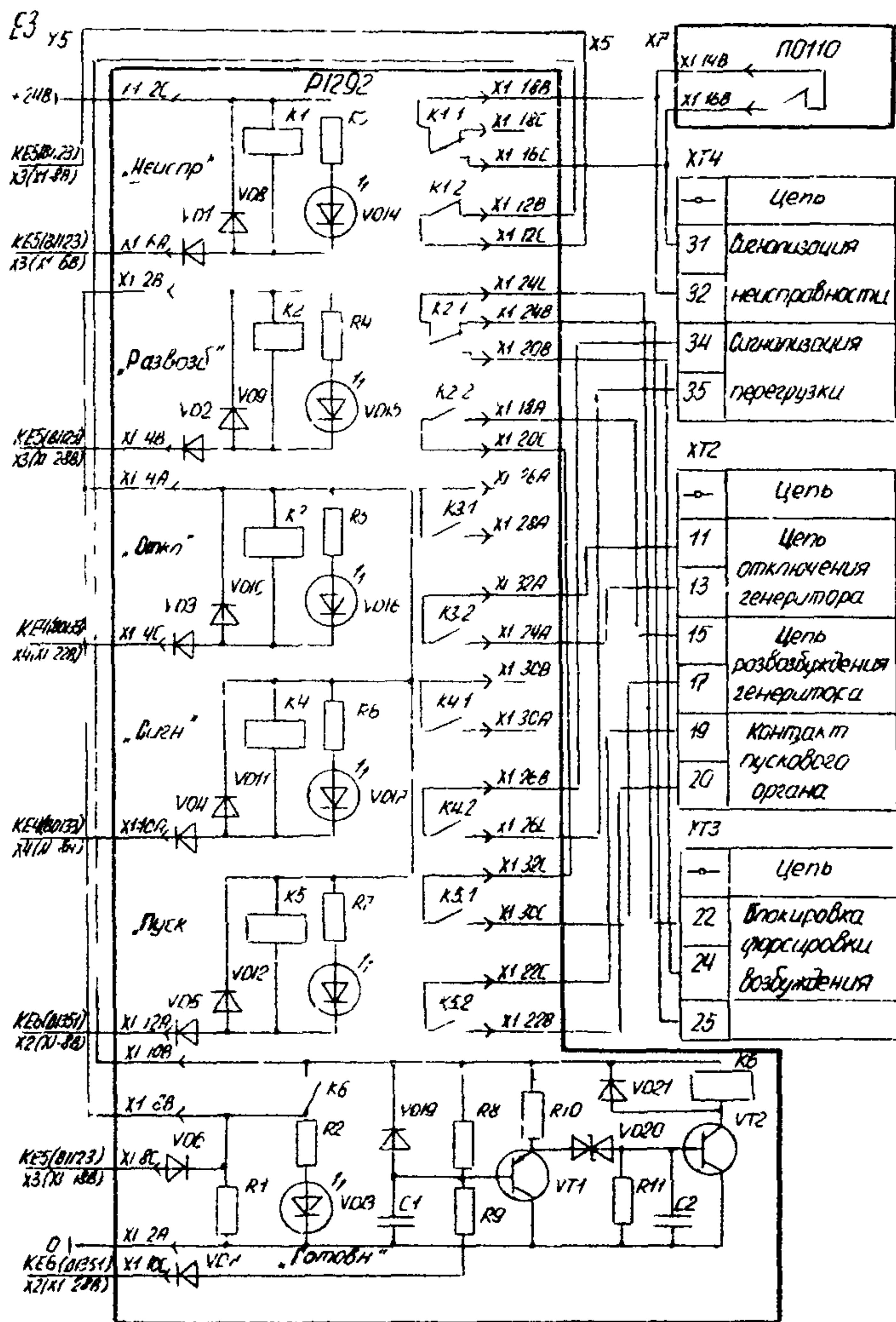
Рис. II. Принципиальная электрическая схема блока реле Р1292
