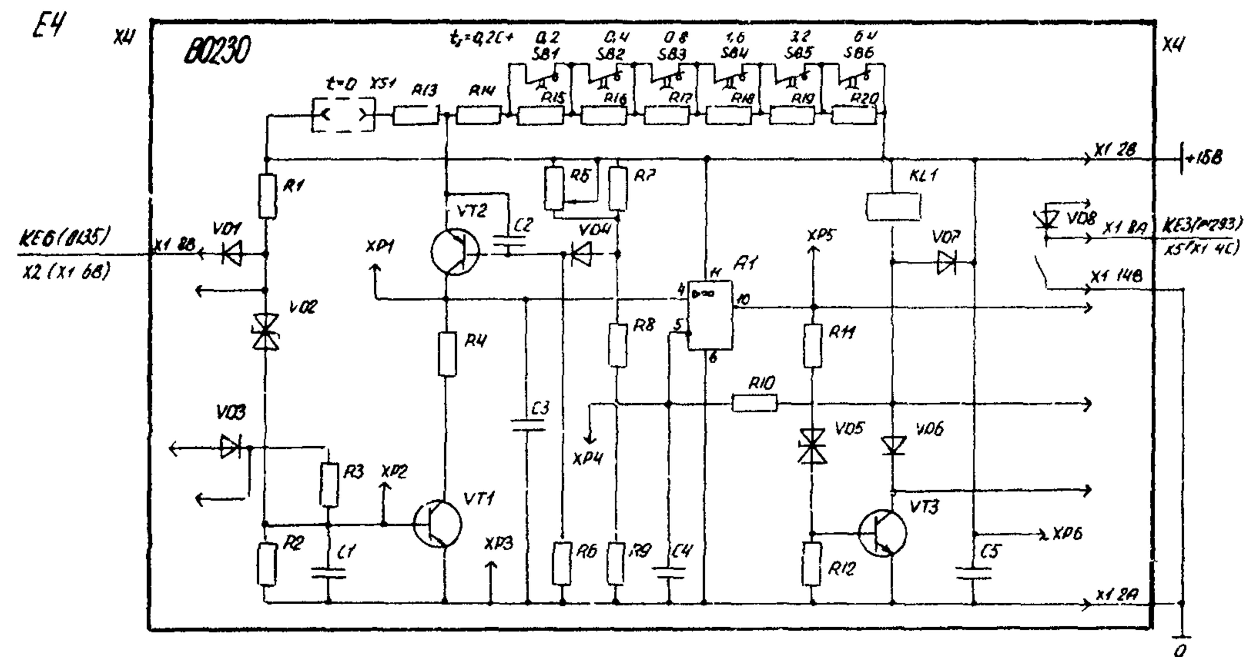
Рис.14. Принципиальная электрическая схема блока независимой выдержки времени В0230 защиты БЭП03
