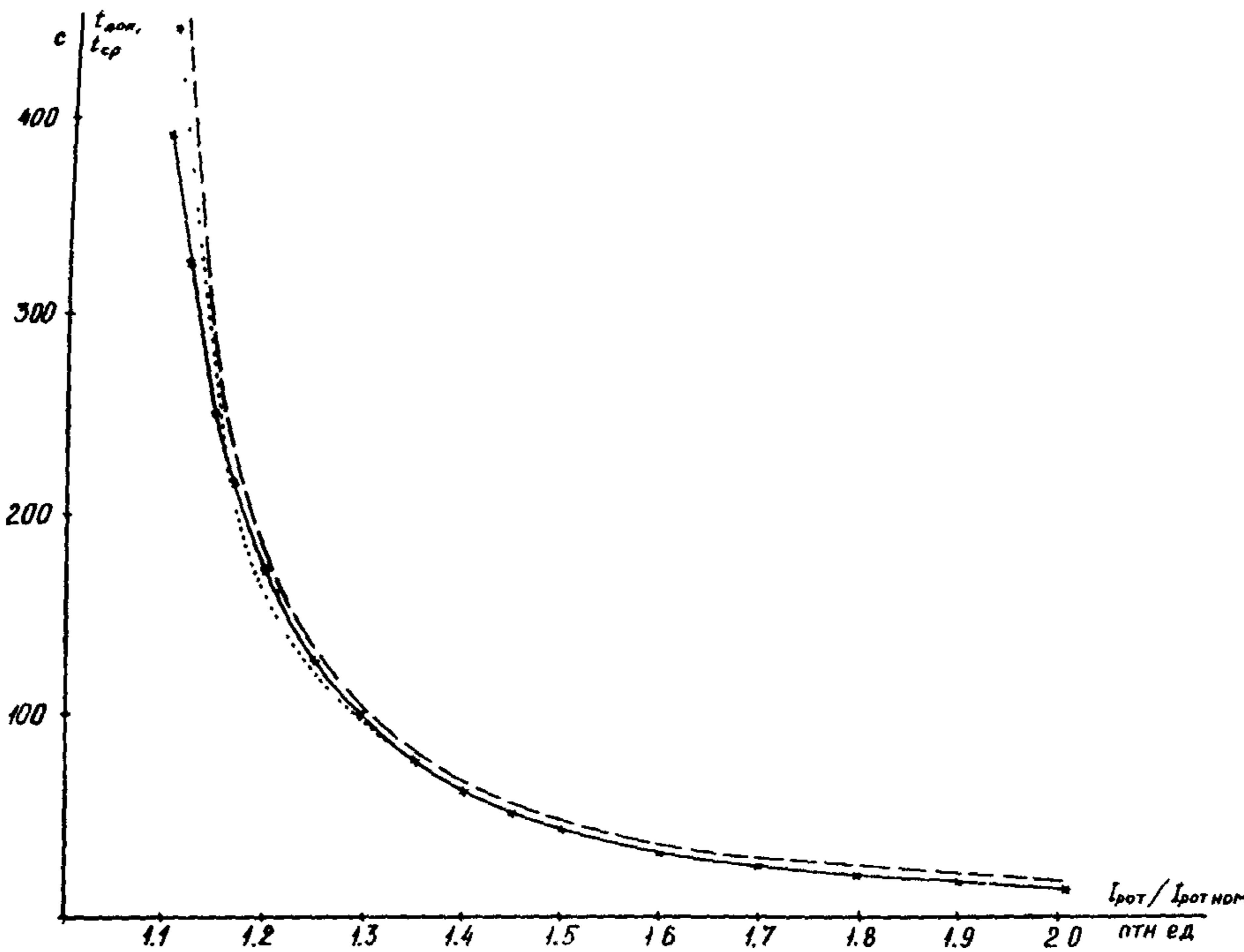
Рис. I8. Расчетная характеристика интегрального органа блока защиты БЭИ02:
