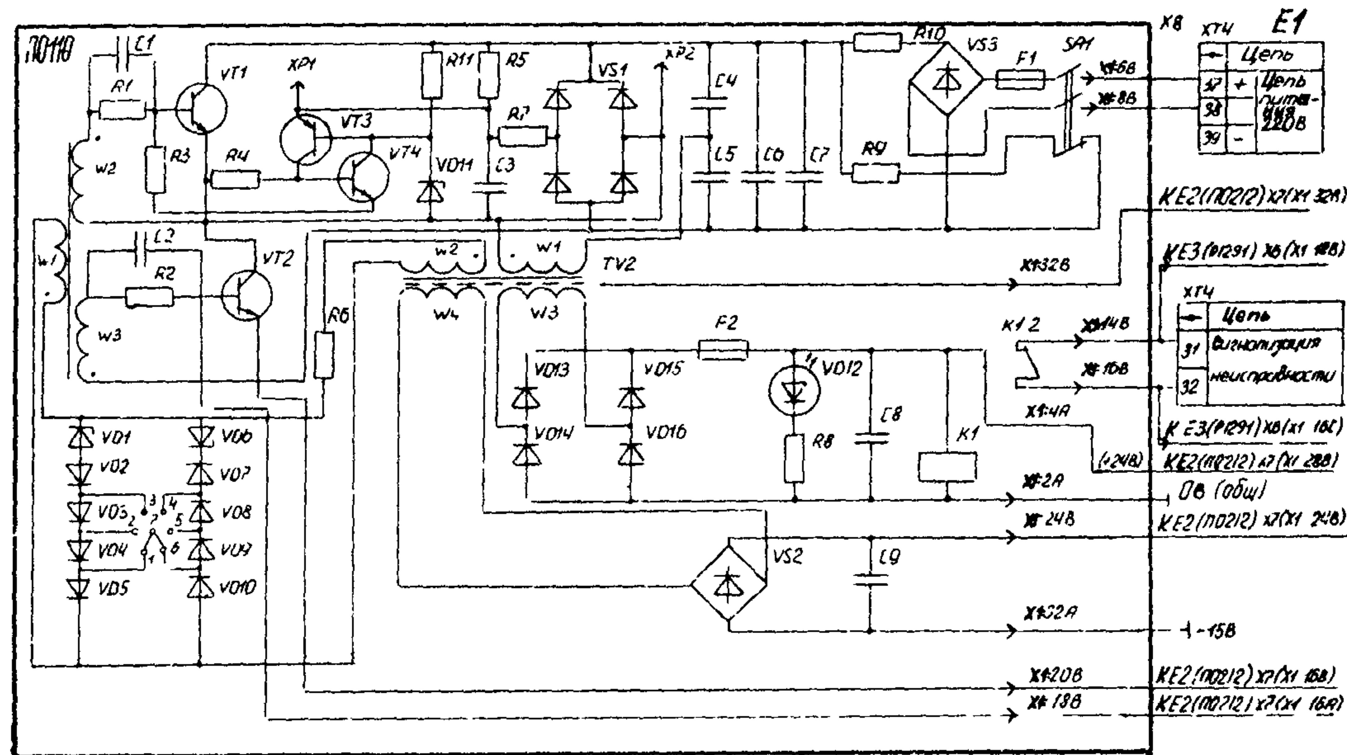
Рис.6. Принципиальная электрическая схема блока питания ПСИО защиты БЗИ01
