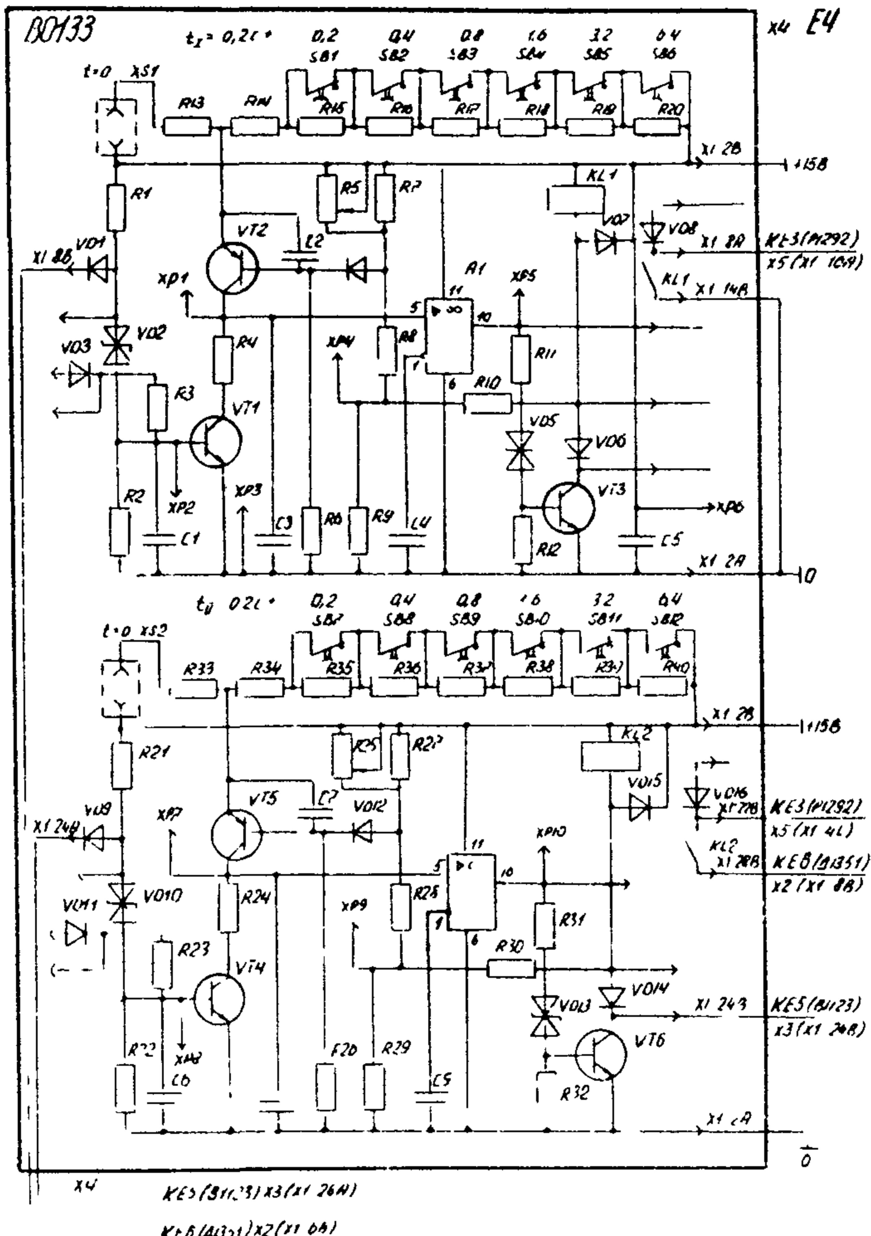
Рис.9. Принципиальная электрическая схема блока независимой задержки времени BOI33 защиты БЭИ02
