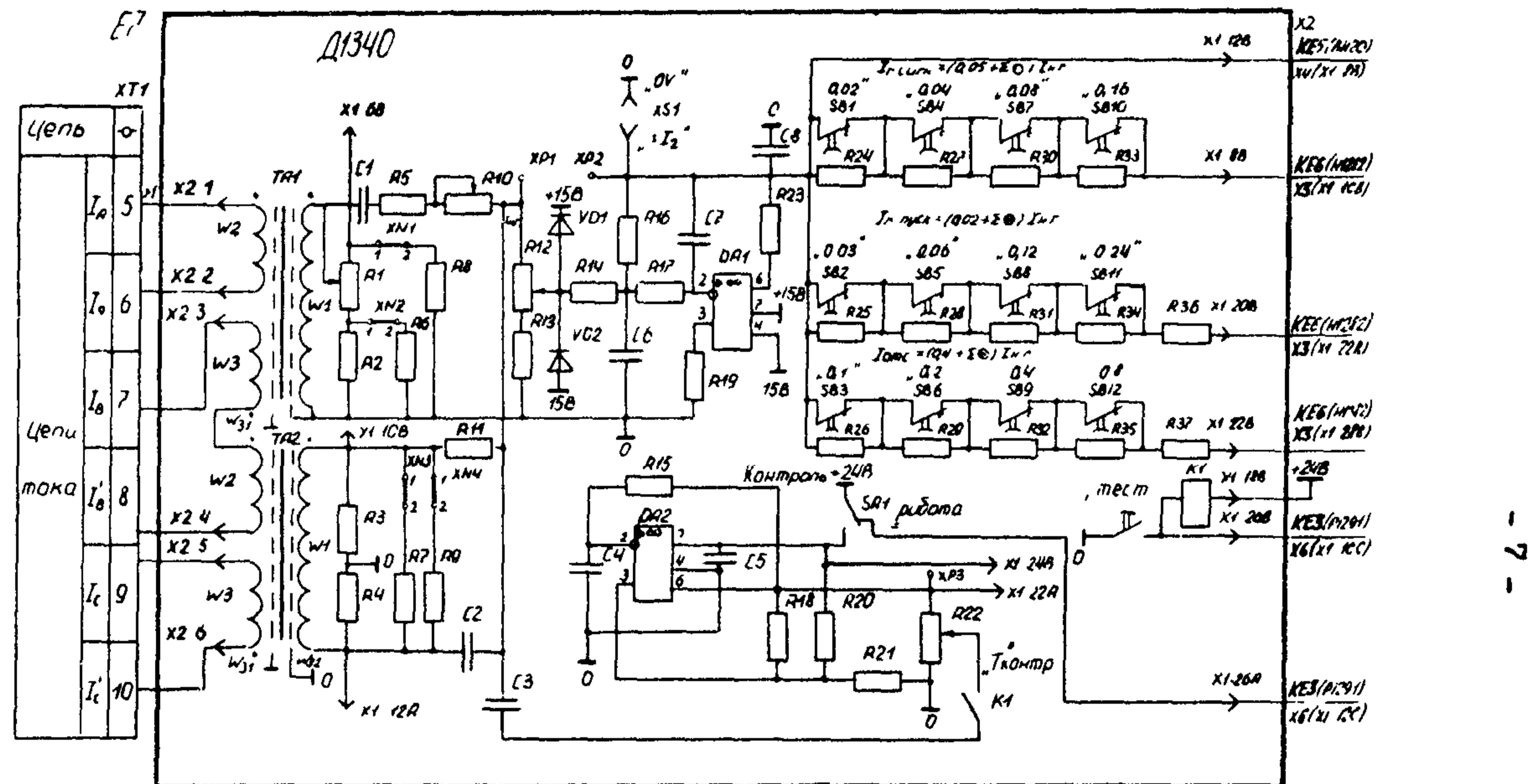
Рис. I. Принципиальная электрическая схема блока преобразования входных сигналов ДИЗ40
