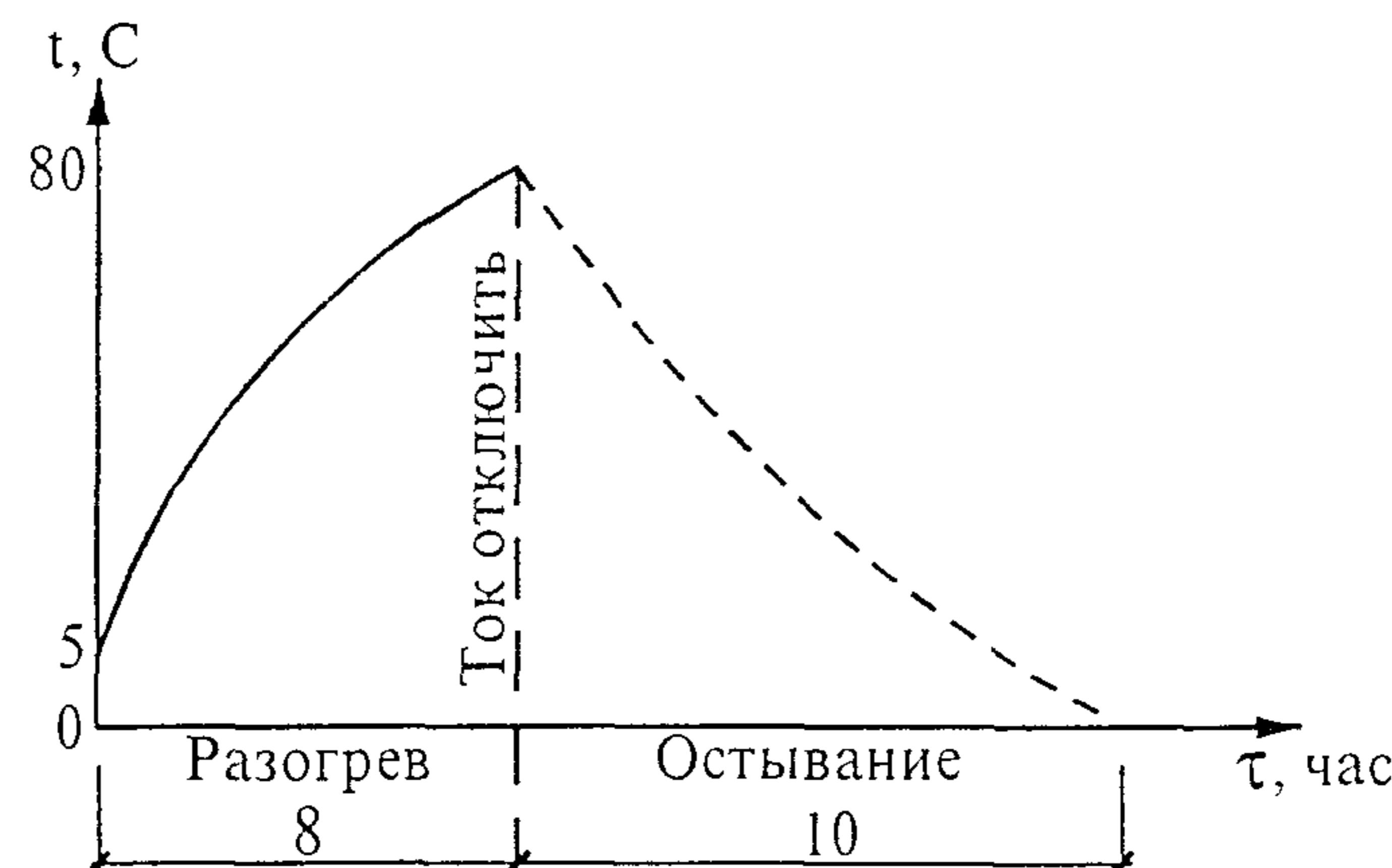
Рисунок 5 – График температурного режима
