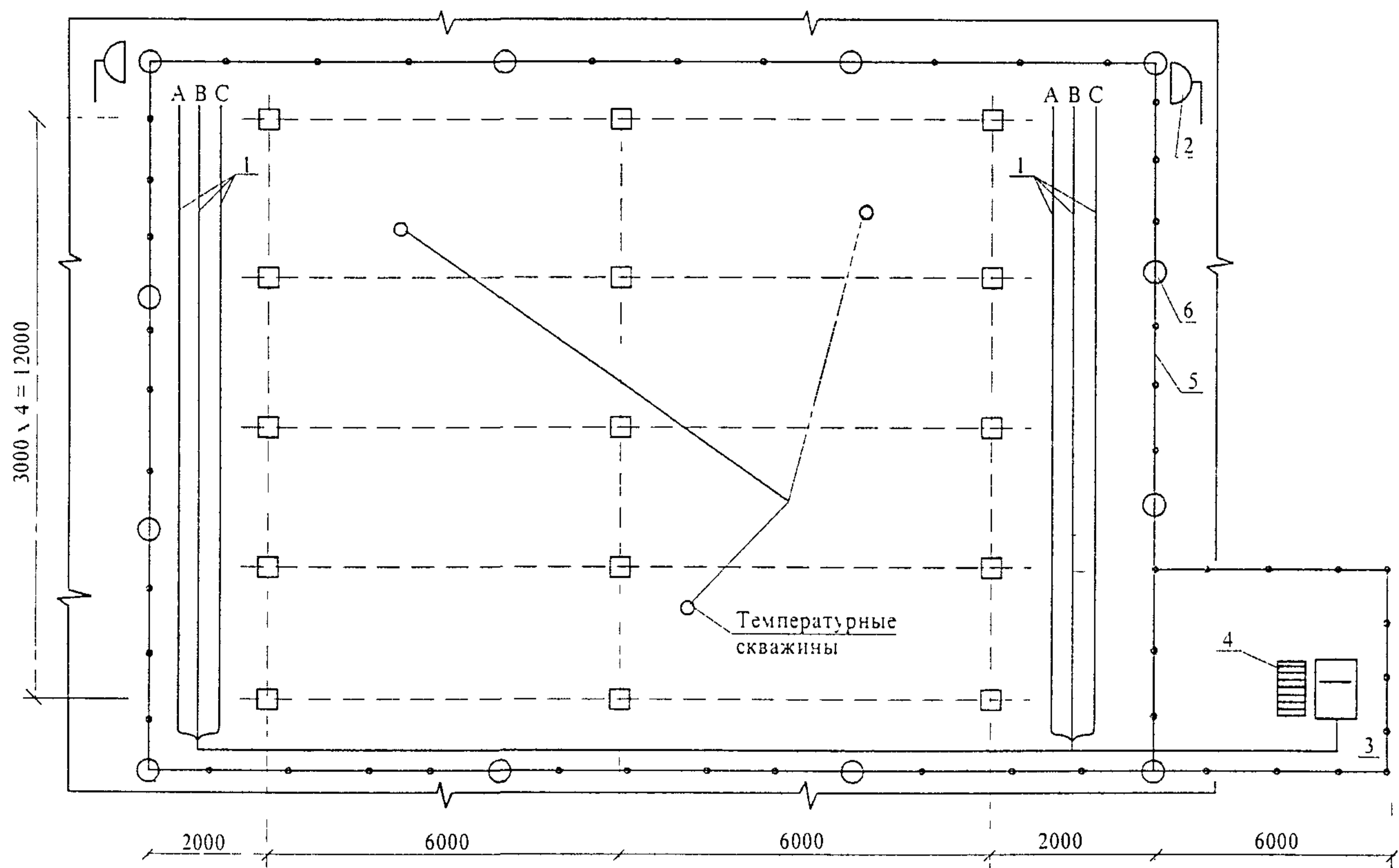
1 – инвентарная трехфазная секция шинопроводов; 2 – прожектор;
