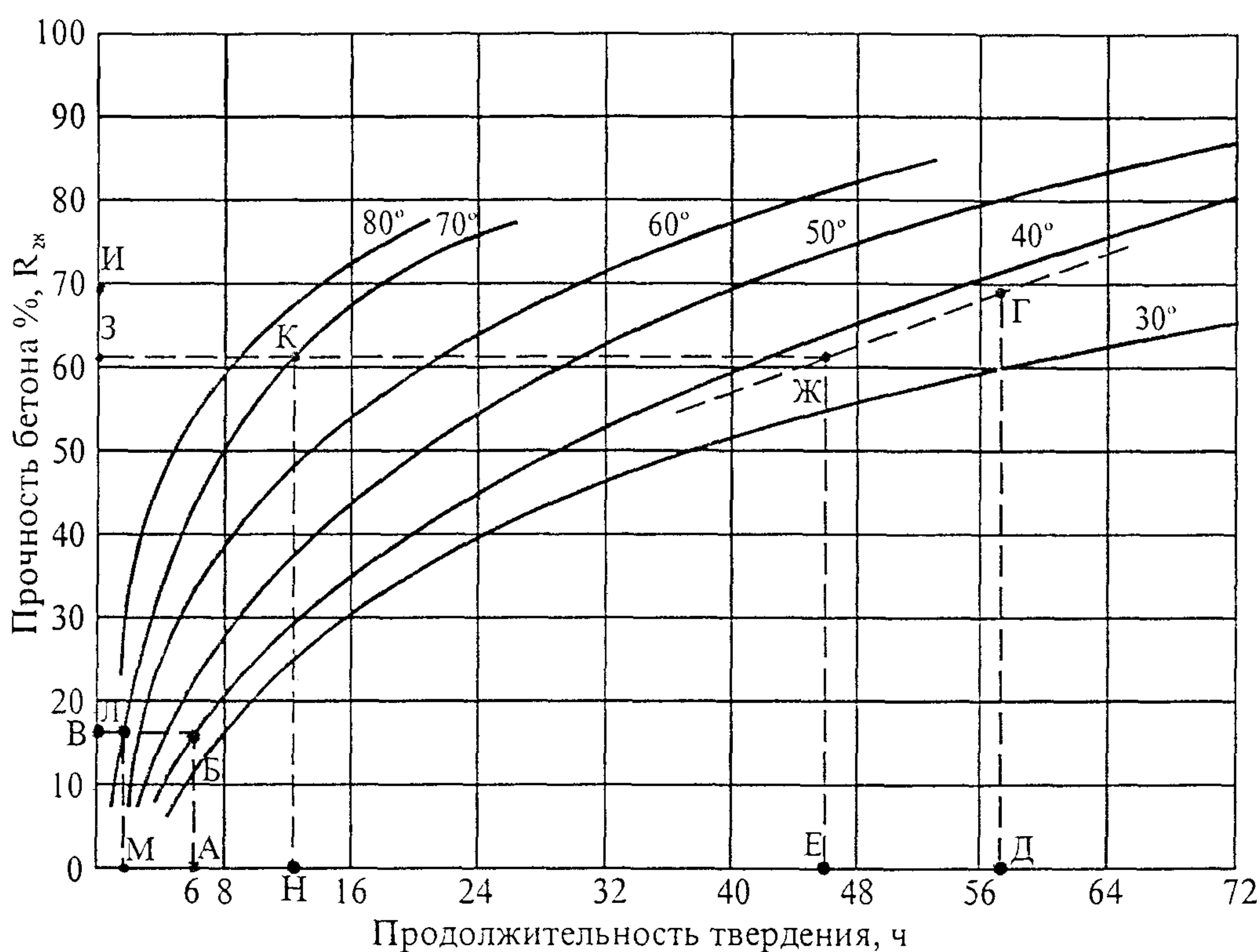
Рисунок 8 – Пример определения прочности бетона по графику
