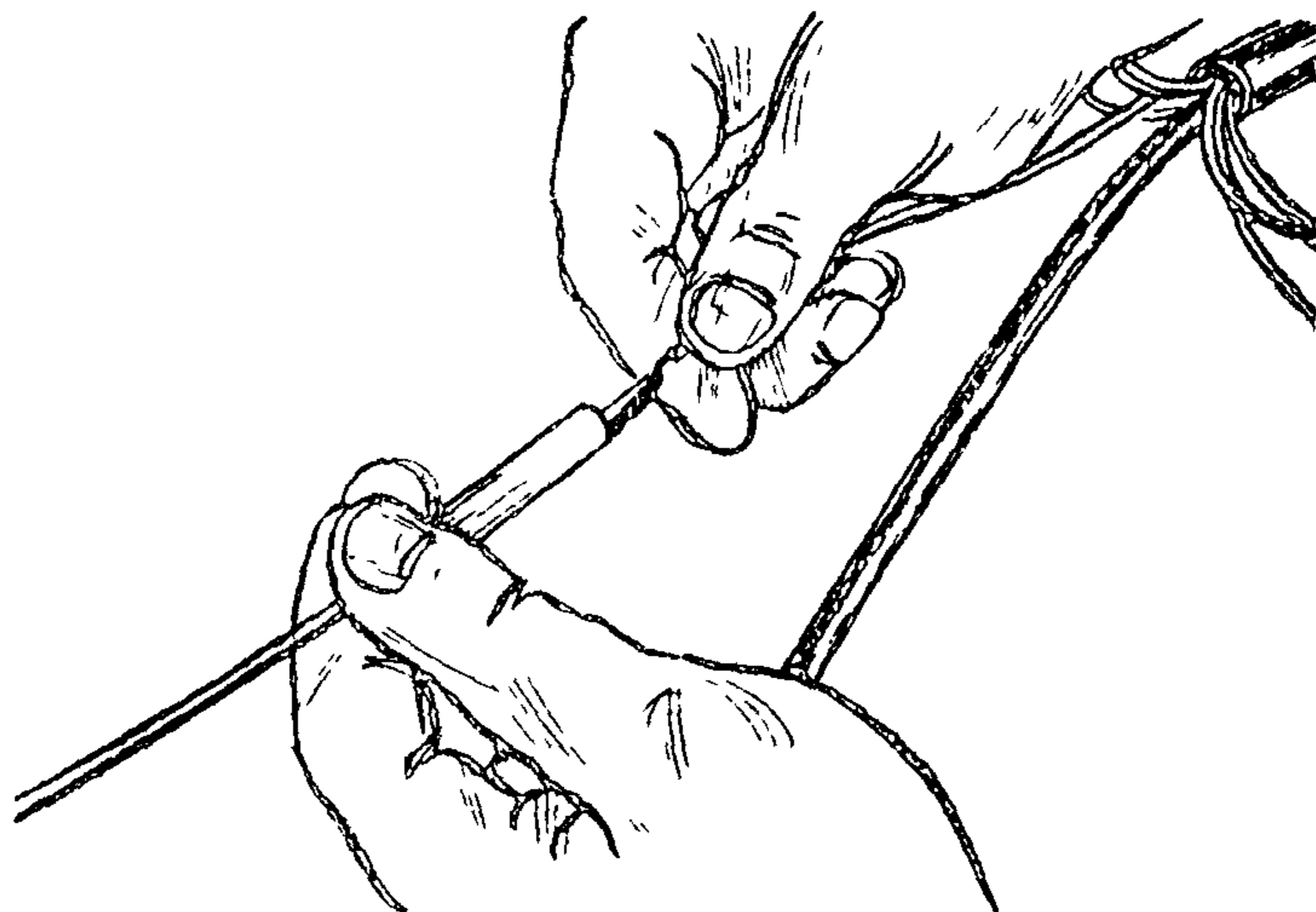
Рис. 19. Изоляция скруток гильзой.
