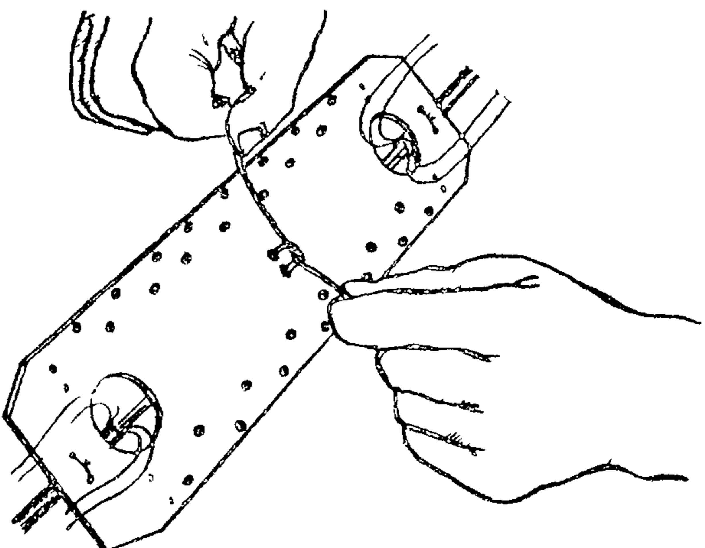
Рис. 9. Установка и скрепление пластины кассеты нитками (поливинилхлоридная оболочка обоих концов кабеля должна выступать в отверстиях пластины на 2 - 3 мм).
