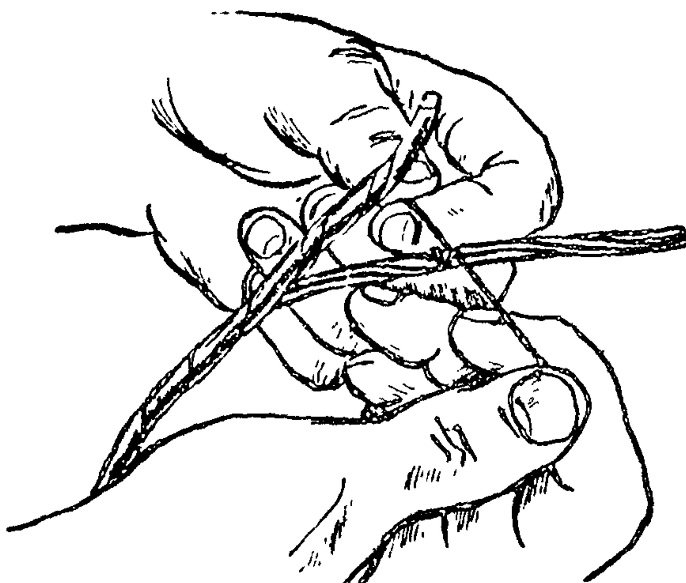
Рис. 6. Закрепление оптических волокон в пазах стержня.
