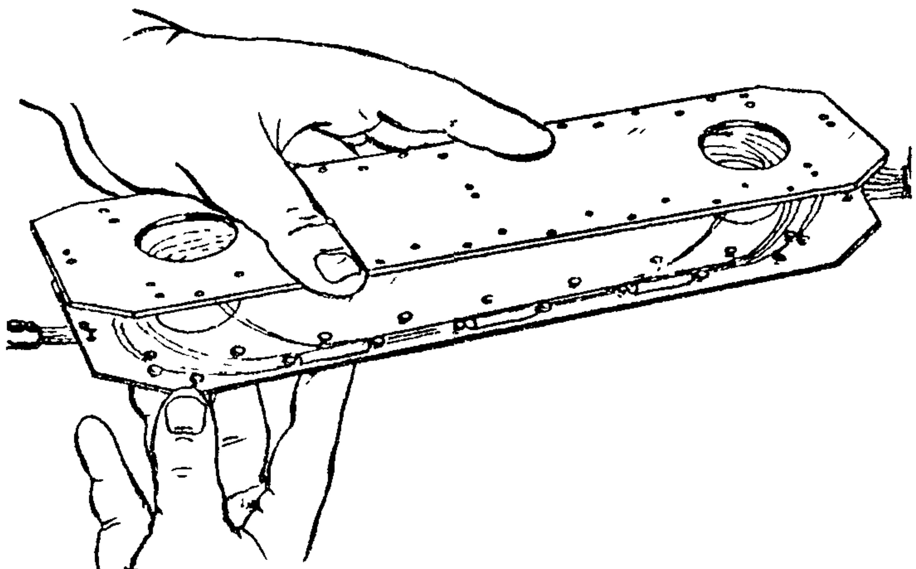
Рис. I5. Установка пластины без фиксаторов
