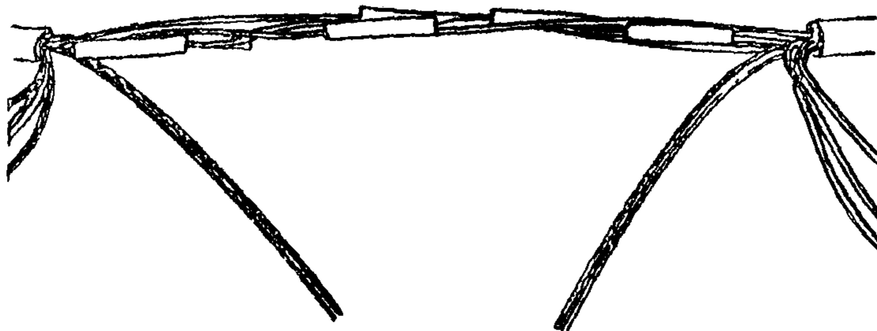
Рис. 20. Соединение металлических проволок и медных жил
