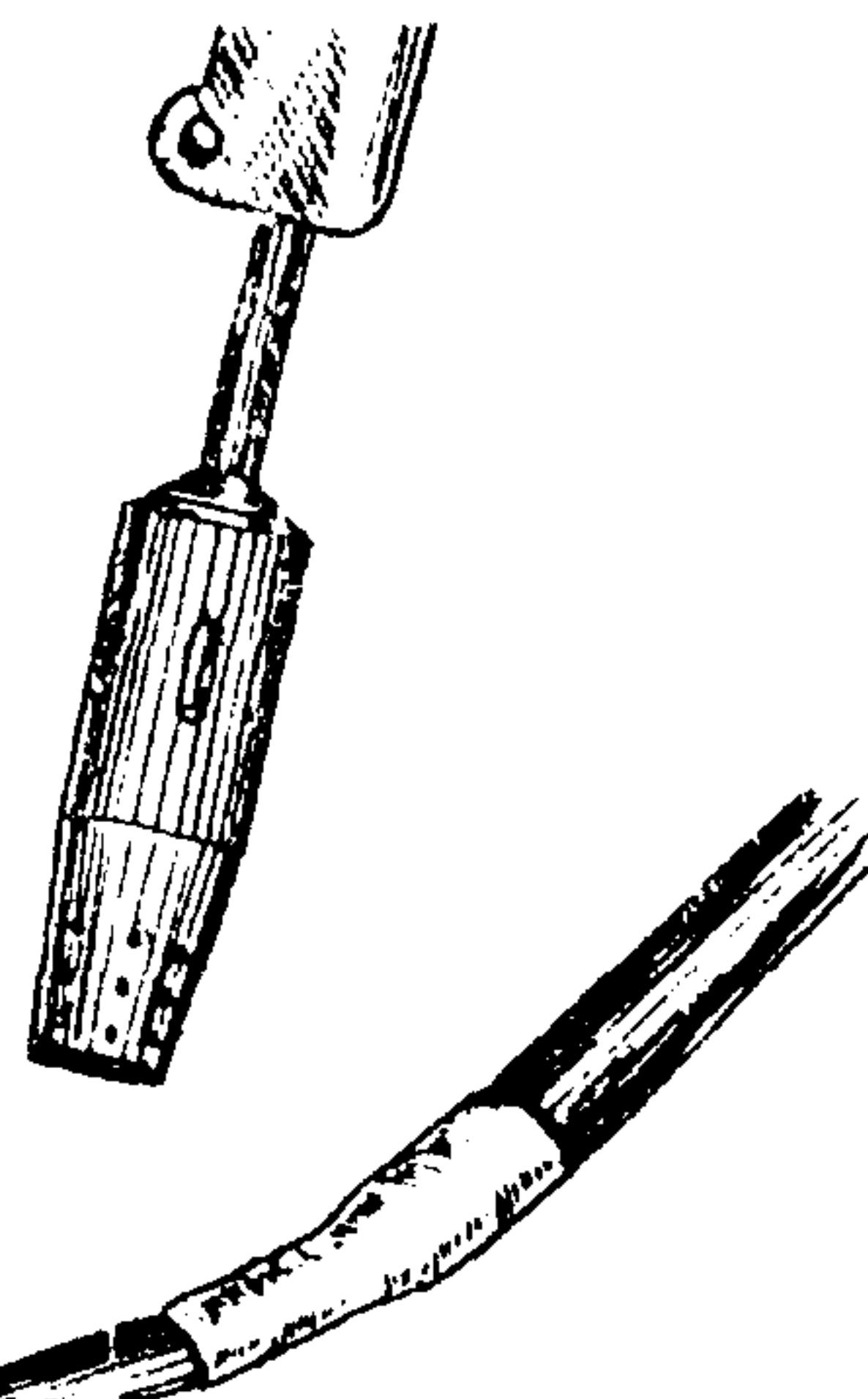
Рис. 5. Герметизация внешней полиэтиленовой оболочки термоусаживаемой трубкой
