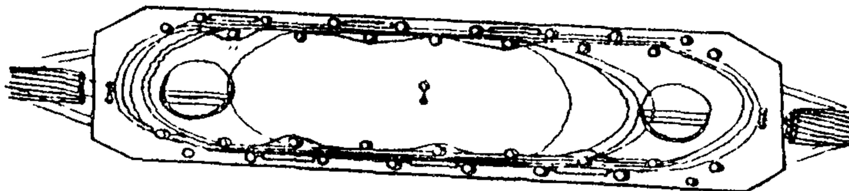
Рис. 14. Выкладка оптических волокон
