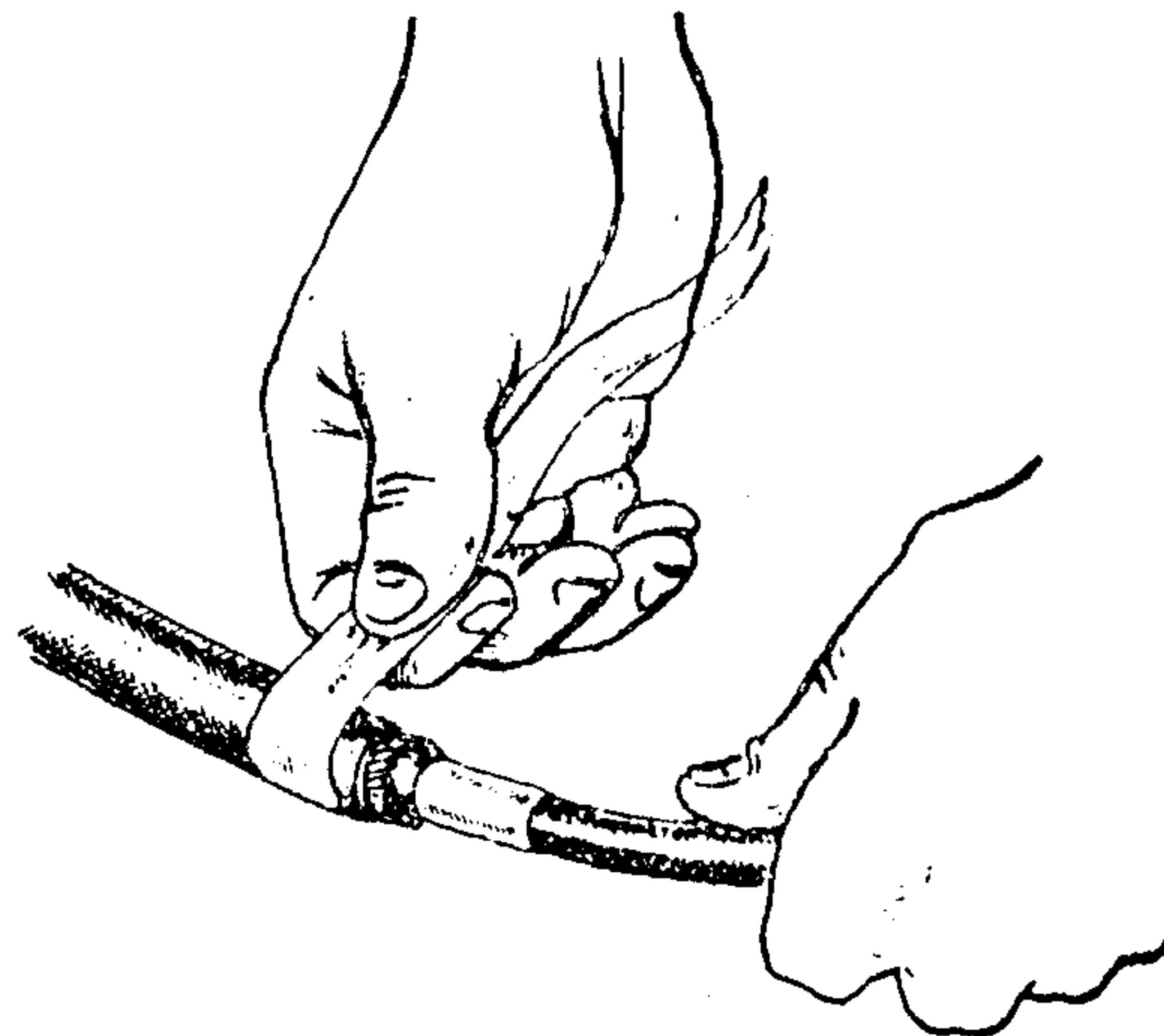
Рис. 4. Наложение паясков сэвилена при герметизации внешней полиэтиленовой оболочки
