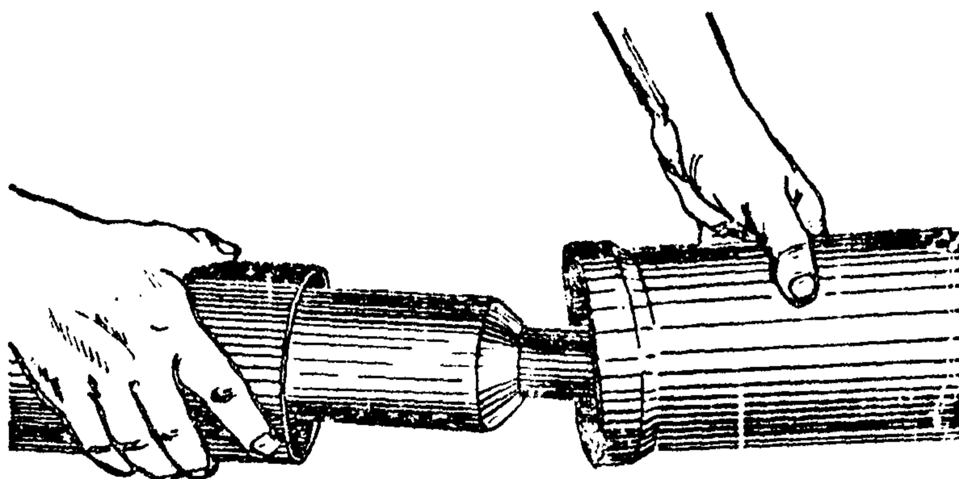
Рис. 25. Установка внешней полизтиленовой муфты.
