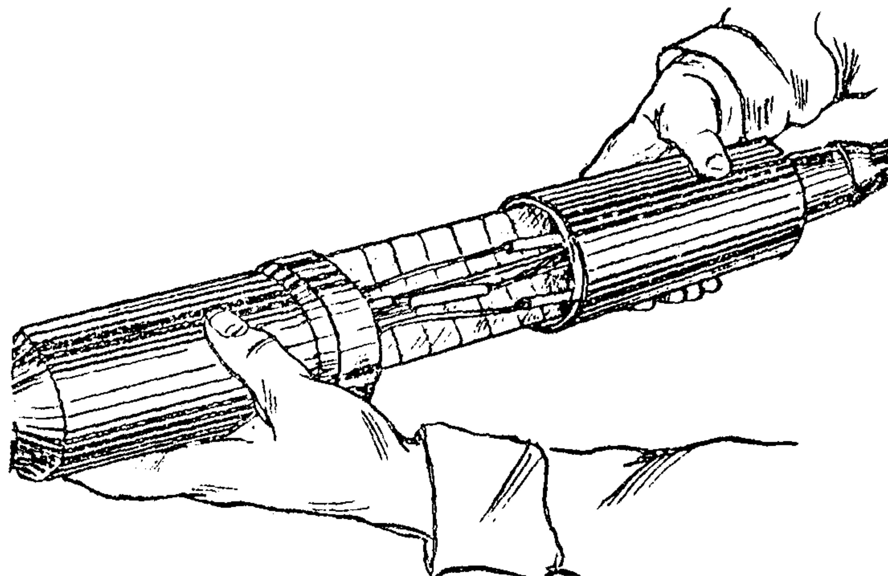
Рис. 23. Установка полиэтиленовой муфты над кассетой
