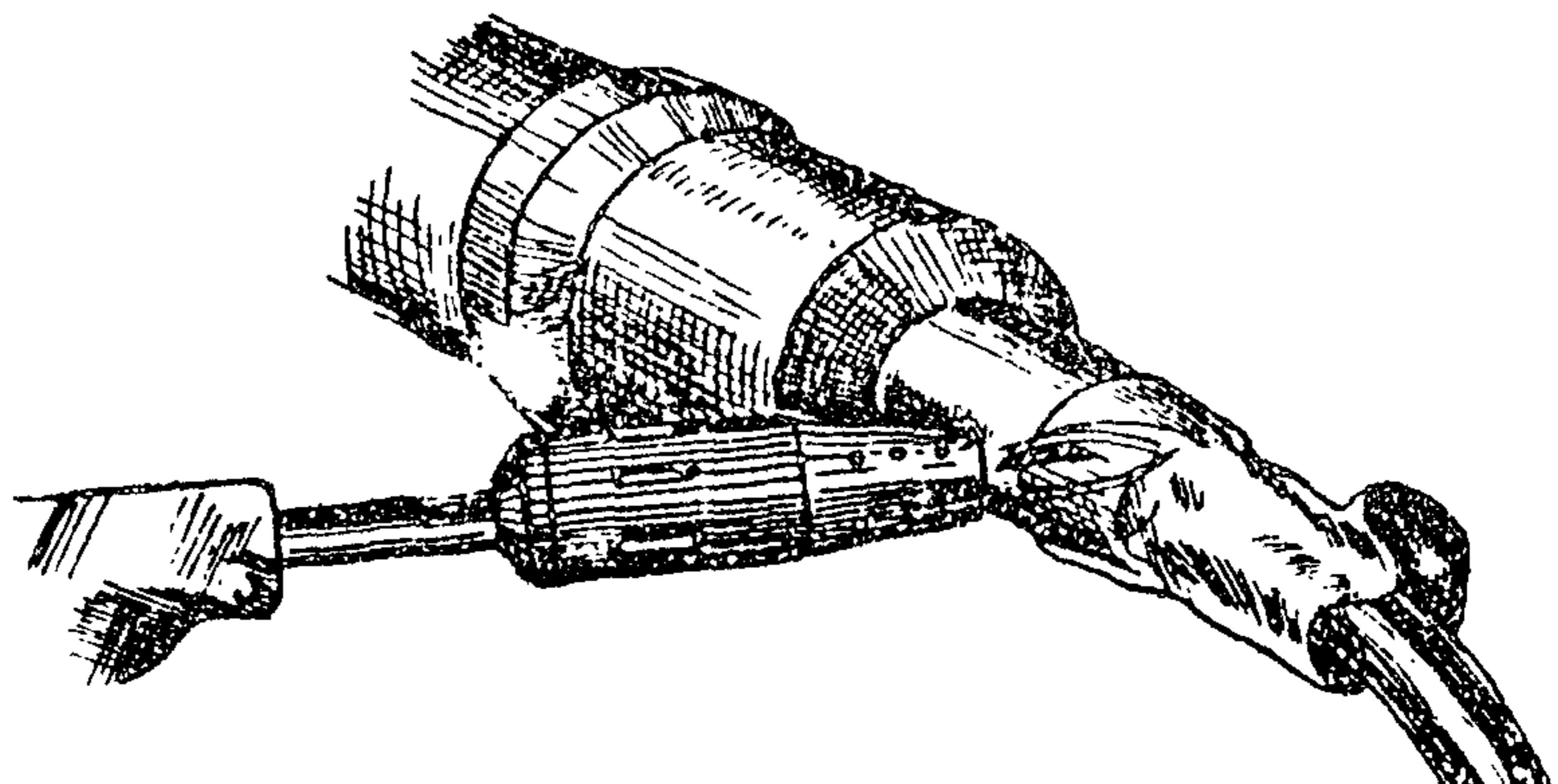
Рис. 3. Усадка термоусаживаемой трубы на конусе муфты
