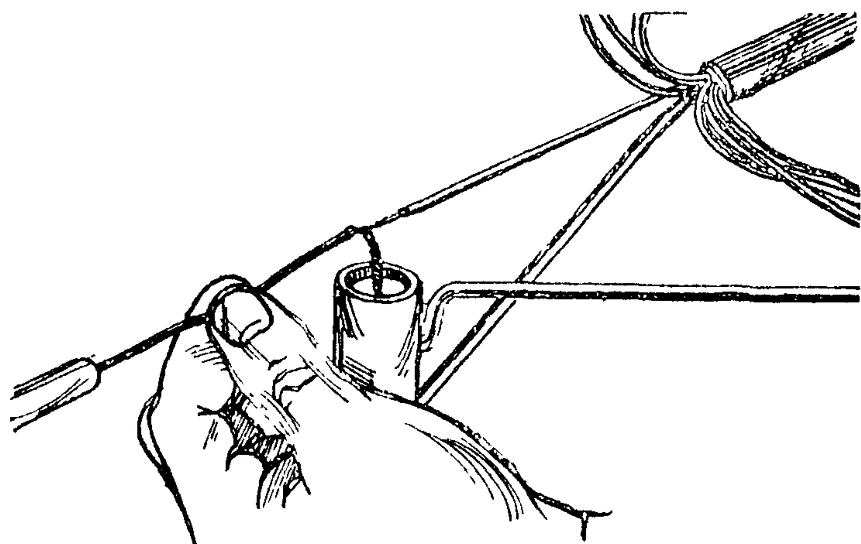
Рис. I8. Пропайка проволок и медных жил.
