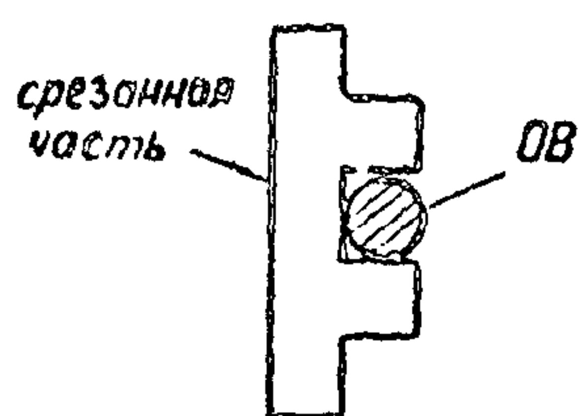
Рис. I3. Установка третьего фиксатора
