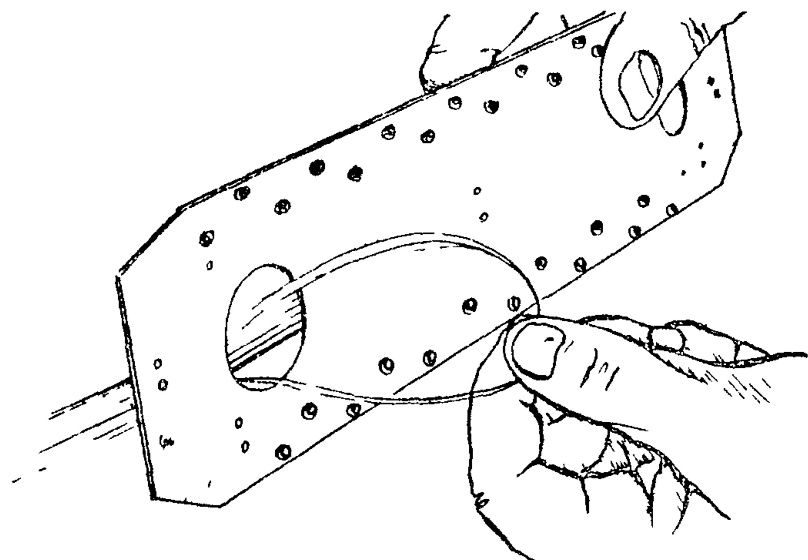
Рис. 8. Вывод оптических волокон через окна пластины
