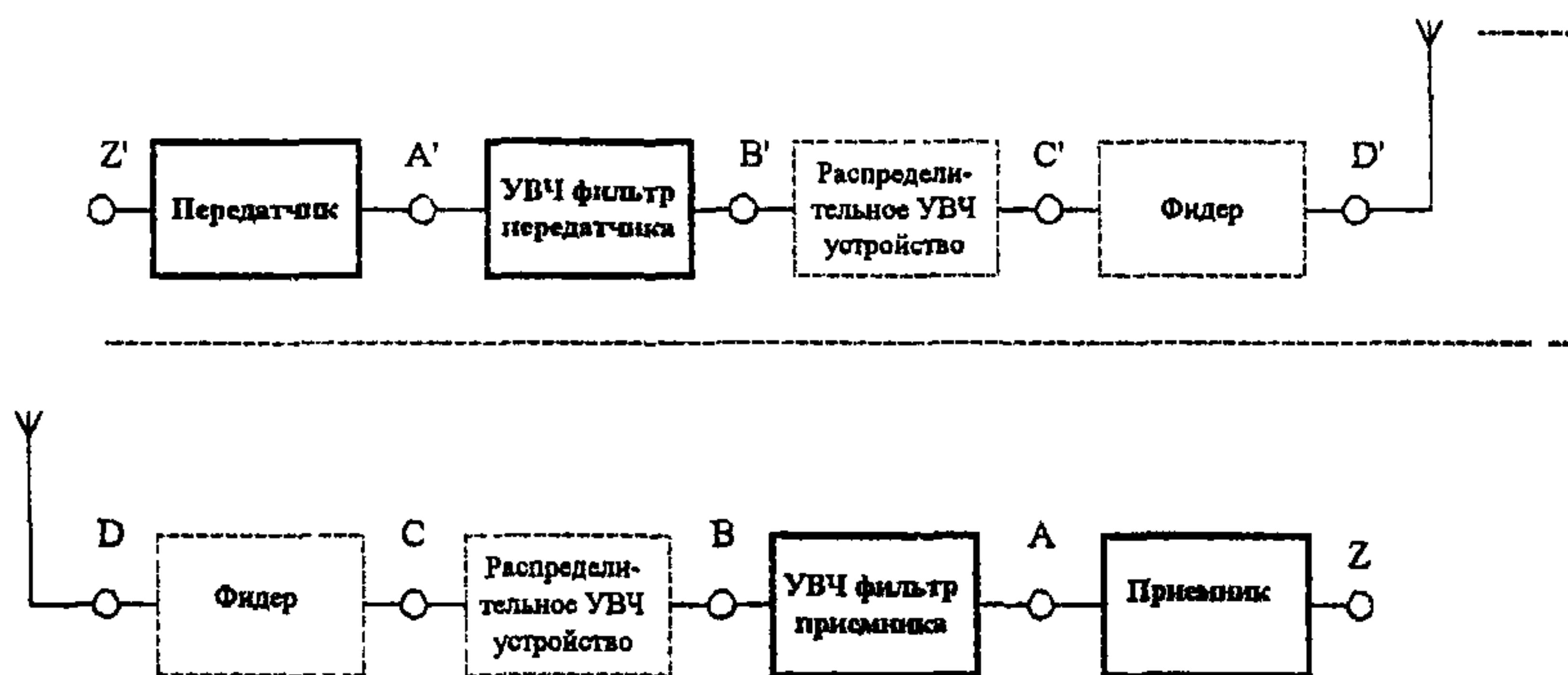
Рисунок 5.2 - Структурная схема радиооборудования АРД FH-CDMA 3-11 ГГц
