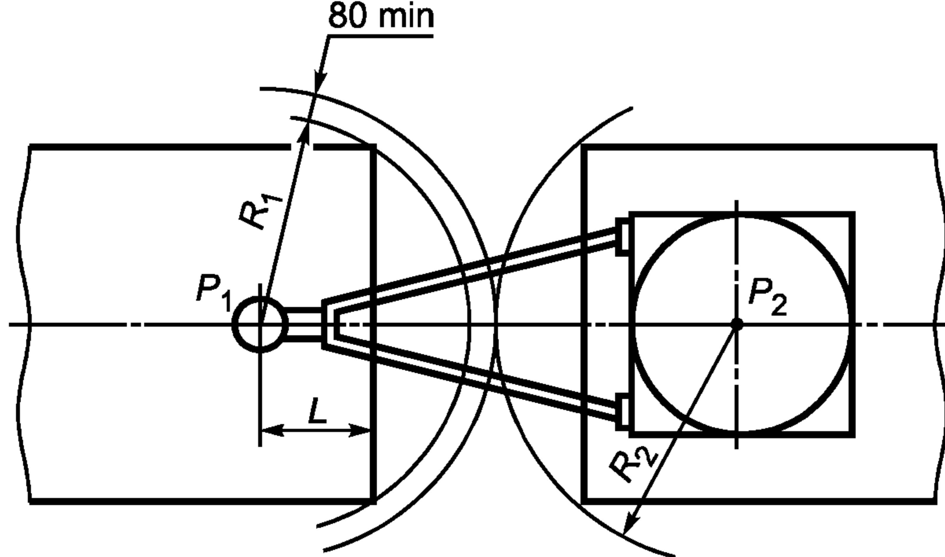
$R_1$  — радиус габарита задней части тягача (прицепа или полуприцепа для многозвездного автопоезда);  $R_2$  — радиус габарита передней части прицепа;  $P_1$  — центр тягово-цепного устройства;  $P_2$  — центр поворотного устройства прицепа;  $L$  — расстояние до центра тягово-цепного устройства (для прицепов с центральной осью (осями) — не более 420 мм)
