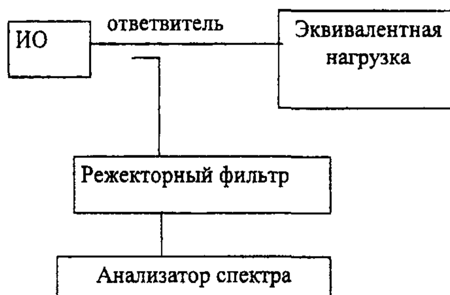
Рисунок 4 - Структурная схема измерения наведенных побочных излучений контактным методом
