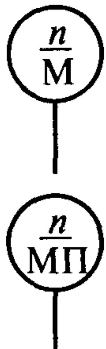
В числителе — порядковый номер манометра.
