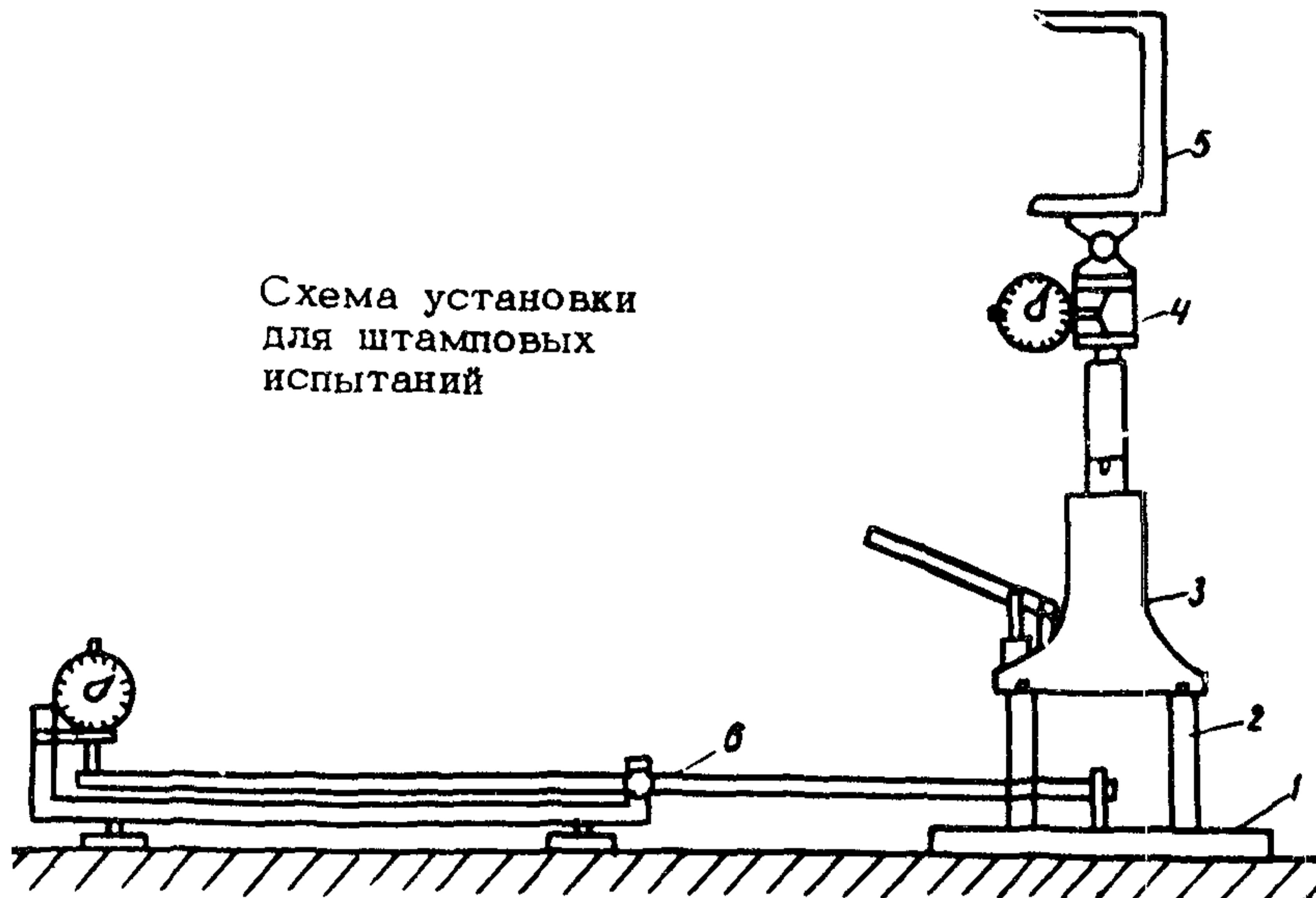
30 сек. По истечении этого времени и через 30 сек после снятия нагрузки по индикатору снимают отсчеты. По разности отсчетов определяют упругую деформацию конструктивного слоя.
