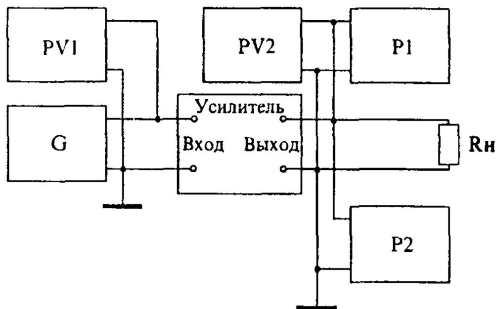
G - генератор сигналов низкочастотный,
