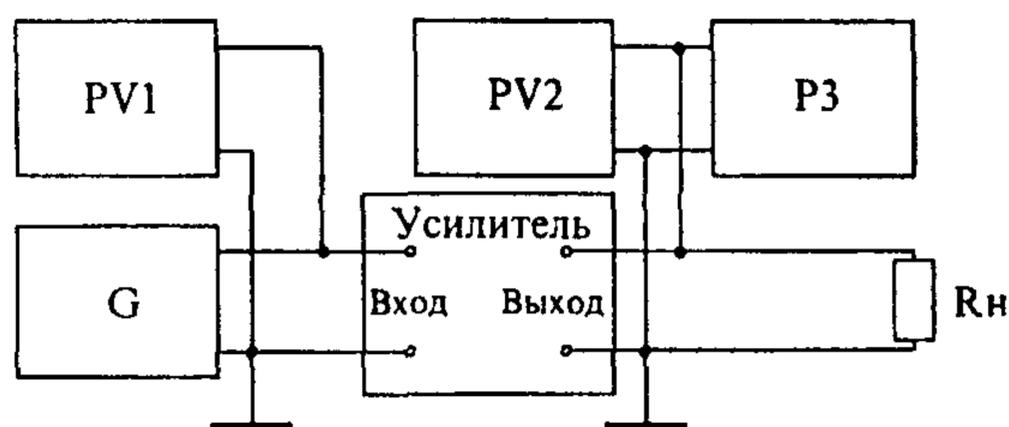
$G$  - генератор сигналов низкочастотный,
