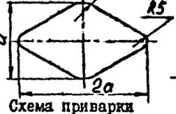
Схема приварки ромбовидной накладки
