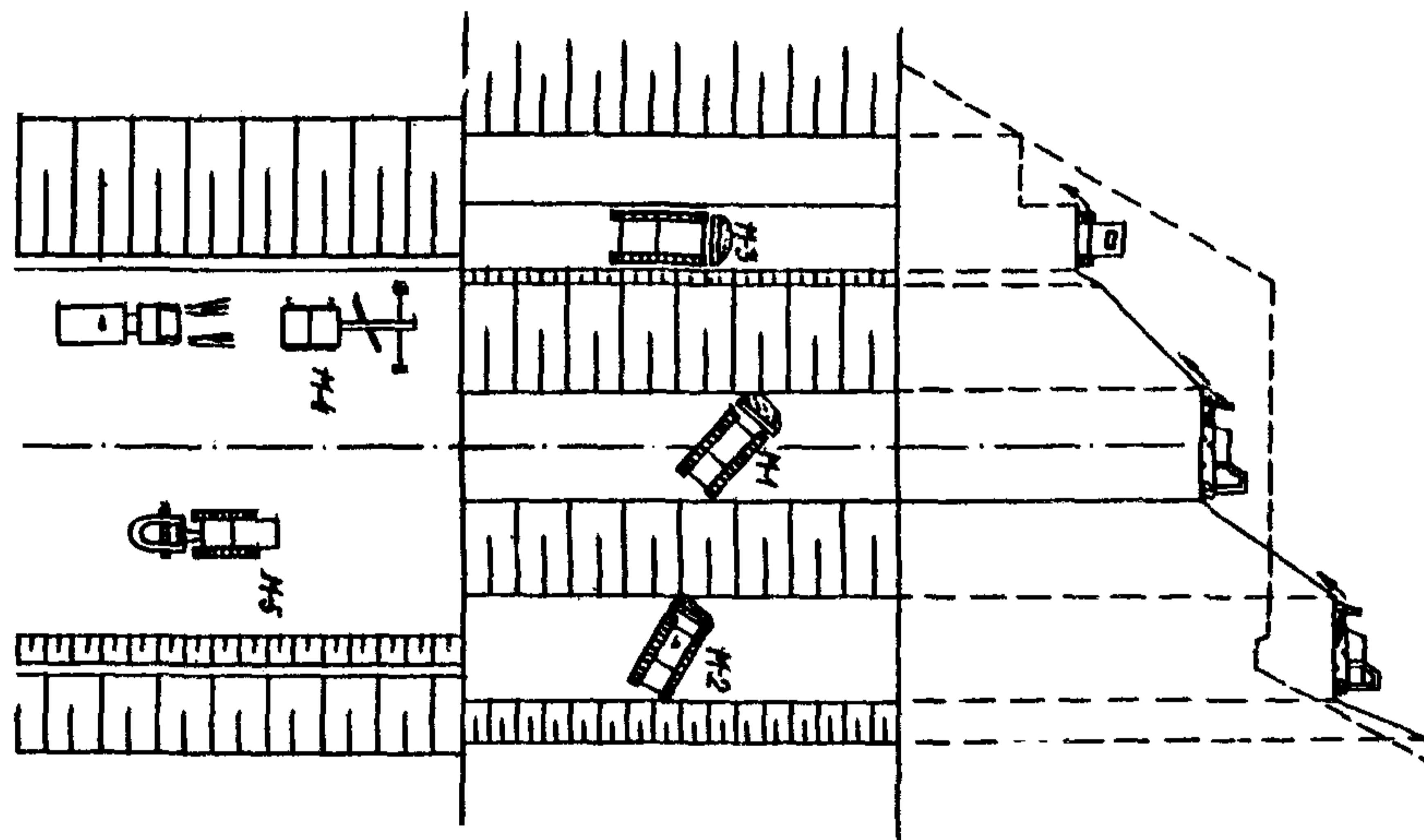
4.3. Разработка косогора универсальным бульдозером (с поворотным отвалом) ведется продольно-диагональными проходами вдоль косогора с ранее устроенного уступа. Работа ведется только частью отвала, обращенного к косогору. Угол резания устанавливается для рыхлых грунтов  $55\text{-}60^{\circ}$ , более плотных –  $45\text{-}50^{\circ}$ .
